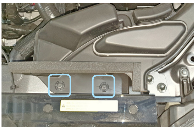
Фото 2.2. Клипсы крепления воздуховода
