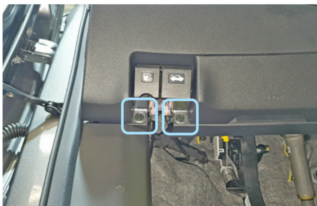
Фото 1.3. Болты крепления ручки отпирания капота
