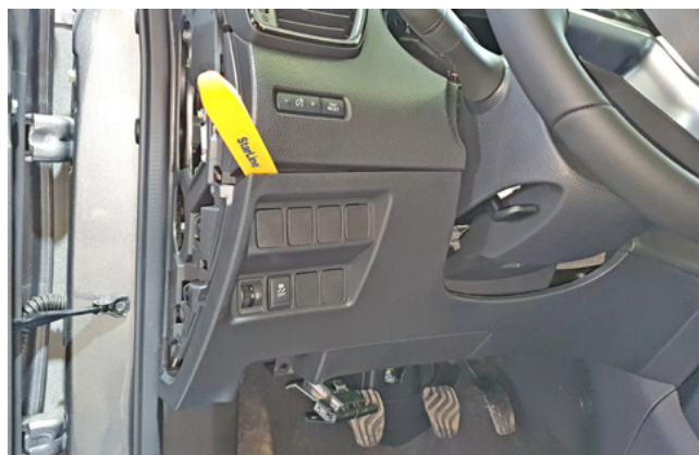
Фото 1.4. Снять пластиковую накладку под рулевой колонкой
