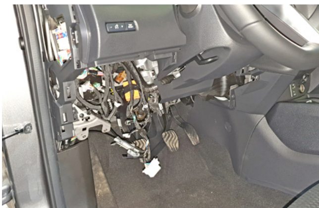
Фото 1.5. Пластиковая накладка под рулевой колонкой снята
