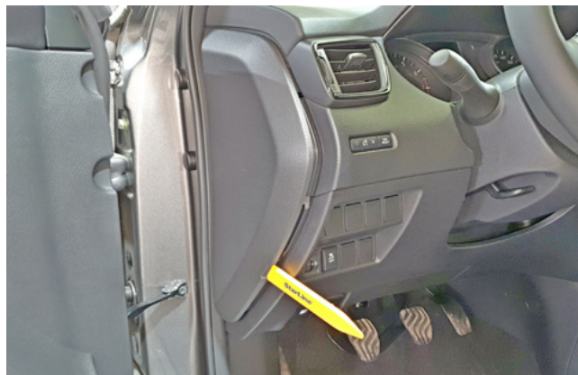
Фото 1.2. Снять боковую накладку передней панели
