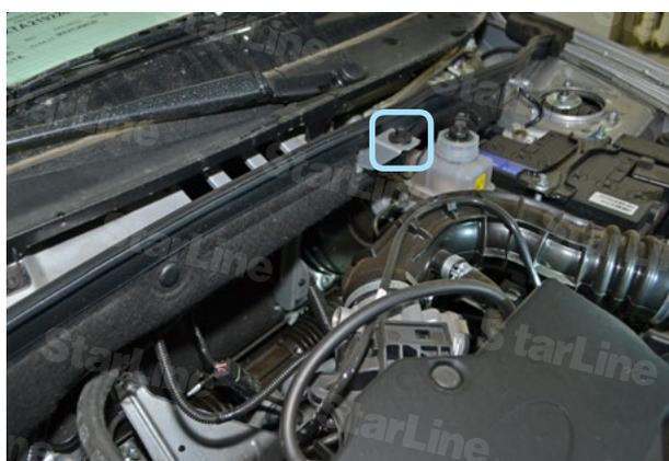
Фото 6.5. Место установки концевика капота
