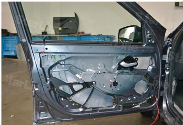
Фото 4.3. Внутренняя обшивка двери водителя снята
