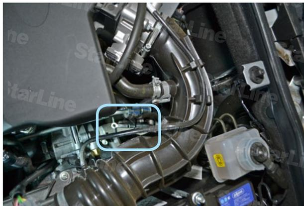
Фото 6.3. Место установки датчика температуры двигателя
