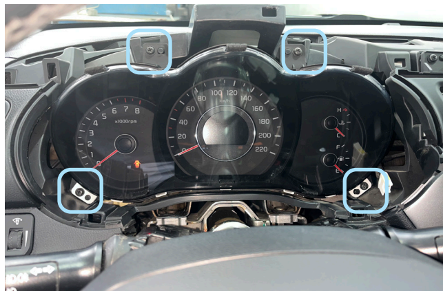
Фото 1.14. Саморезы крепления панели приборов
