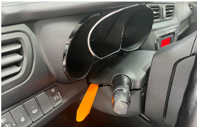
Фото 1.7. Снять верхнюю часть кожуха рулевого вала
