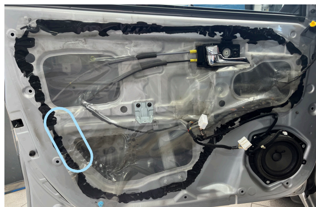
Фото 3.11. Обшивка снята, место установки привода центрального замка
