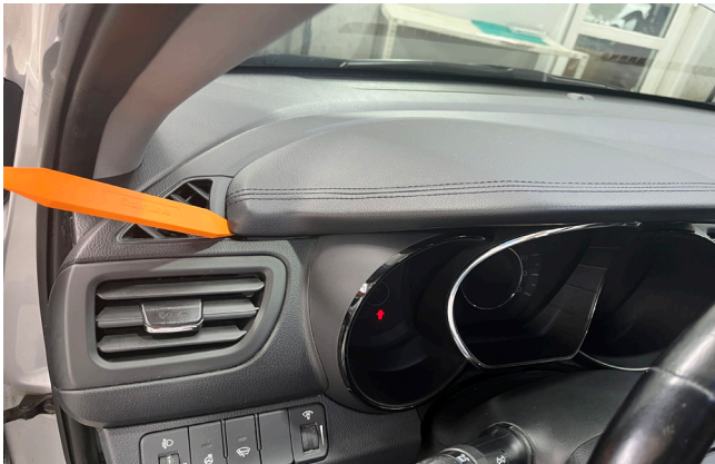
Фото 1.12. Снять декоративную накладку панели приборов
