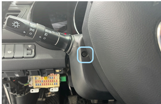
Фото 1.8. Саморез крепление кожуха рулевого вала. Слева
