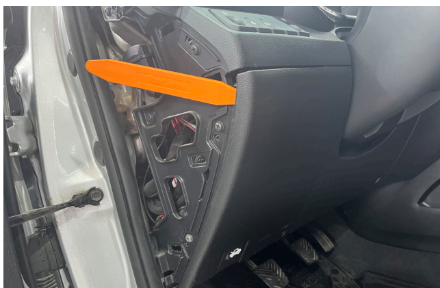
Фото 1.3. Боковая накладка снята. Снять крышку блока предохранителей
