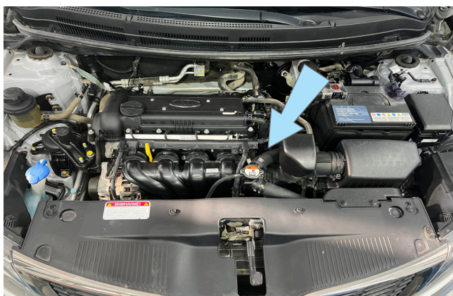
Фото 2.4. Место установки датчика температуры двигателя
