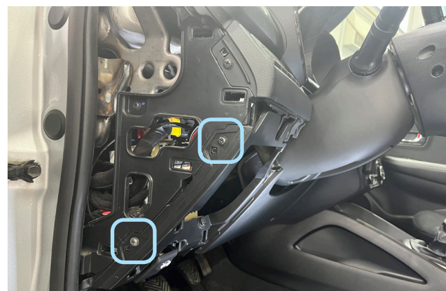
Фото 1.4. Крышка блока предохранителей снята. Саморезы крепление накладки под рулевой колонкой
