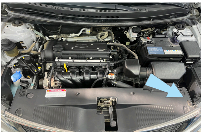
Фото 2.6. Возможное место установки концевика капота
