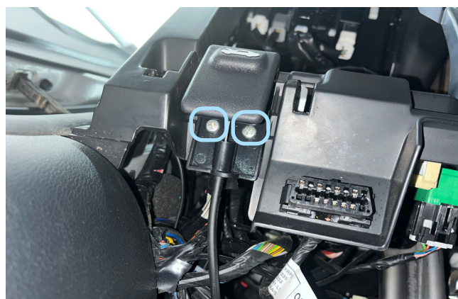
Фото 1.6. Винты крепления ручки открывание капота
