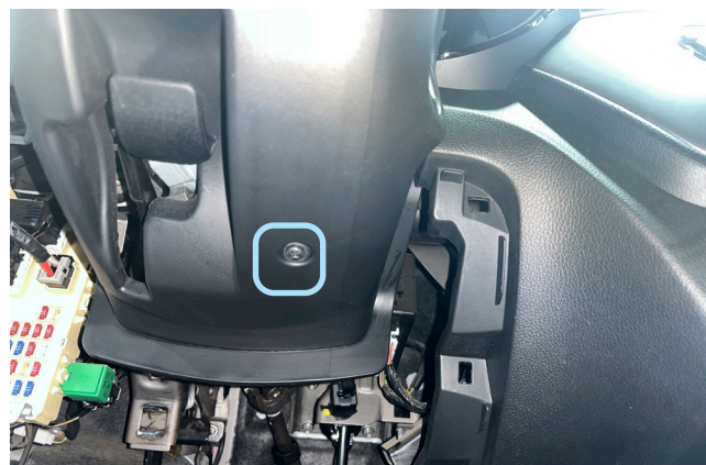
Фото 1.10. Саморез крепление кожуха рулевого вала. Снизу
