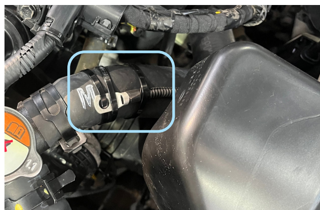
Фото 2.5. Установка датчика температуры двигателя
