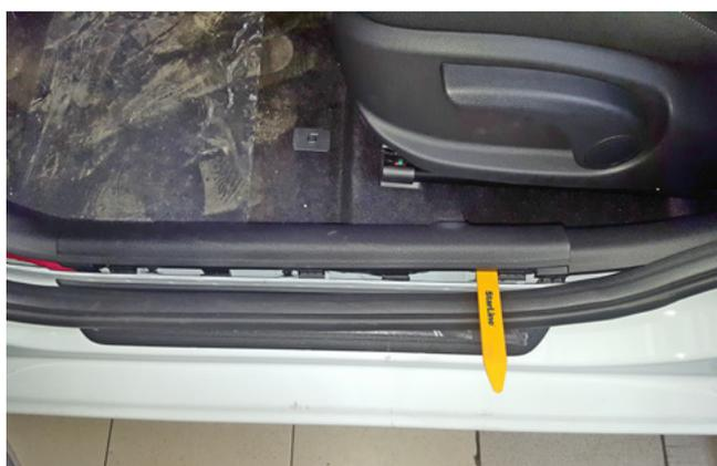
Фото 1.3. Снять накладку порога двери водителя
