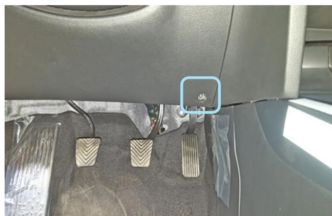
Фото 1.10. Саморез крепления в нижней части пластиковой накладки под рулевой колонкой
