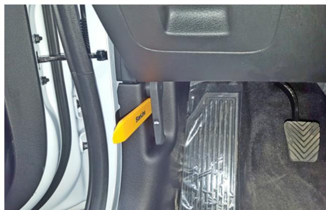
Фото 1.5. Снять ручку отпирания капота
