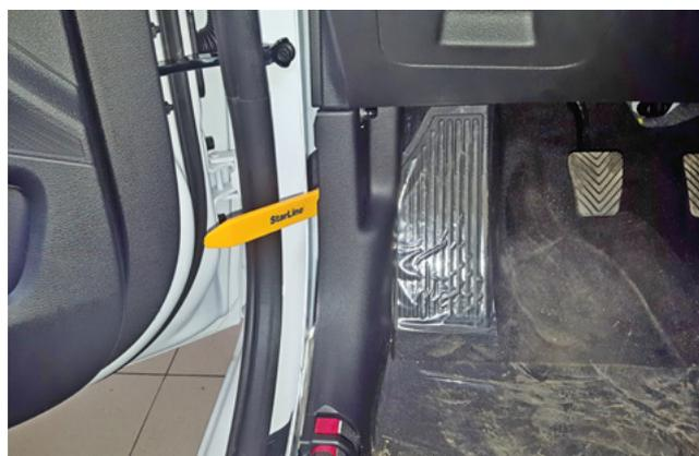
Фото 1.6. Снять накладку левой кик-панели
