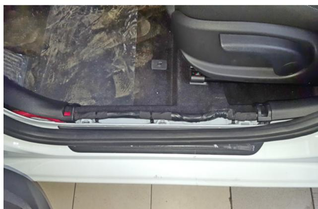
Фото 1.4. Накладка порога двери водителя снята
