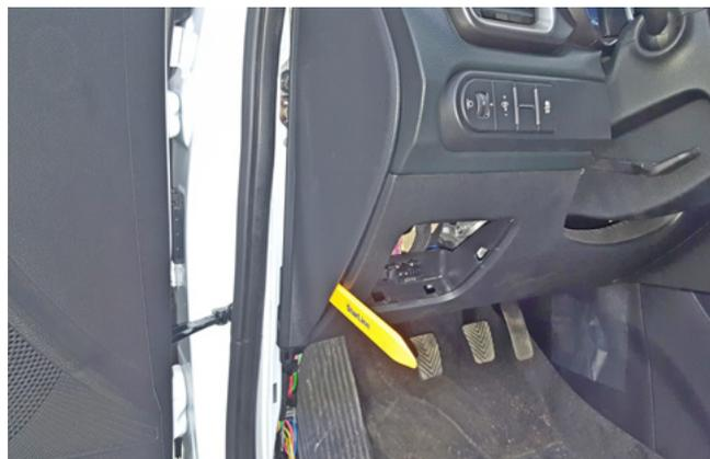
Фото 1.8. Снять боковую накладку передней панели
