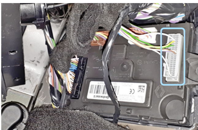
Фото 3.4. Местоположение серого разъёма S2
