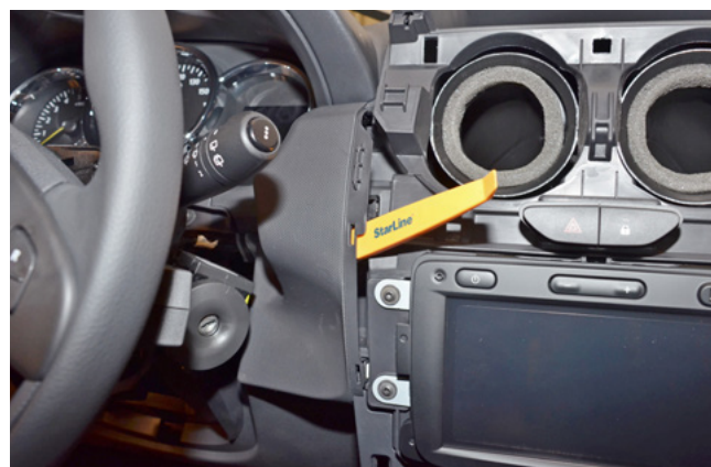
Фото 1.11. Снять накладку справа от рулевой колонки
