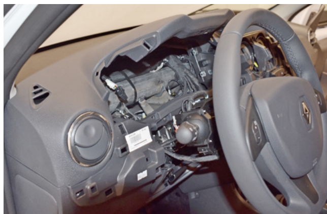
Фото 1.17. Панель приборов снята
