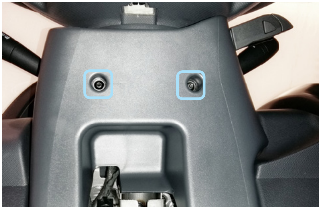
Фото 1.1. Саморезы крепления нижней части кожуха
