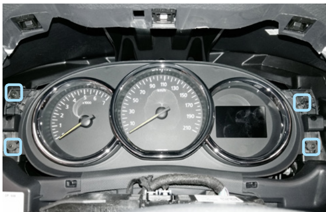
Фото 1.16. Саморезы крепления панели приборов
