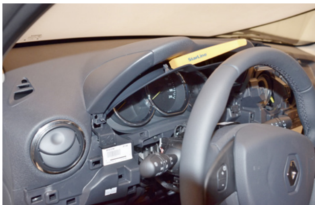
Фото 1.12. Снять накладку панели приборов
