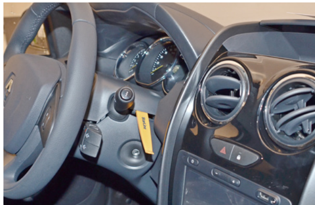
Фото 1.2. Снять верхнюю часть кожуха рулевого вала
