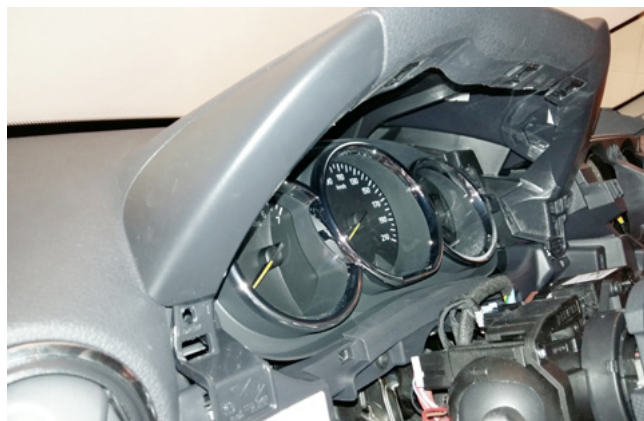
Фото 1.13. Накладка панели приборов снята
