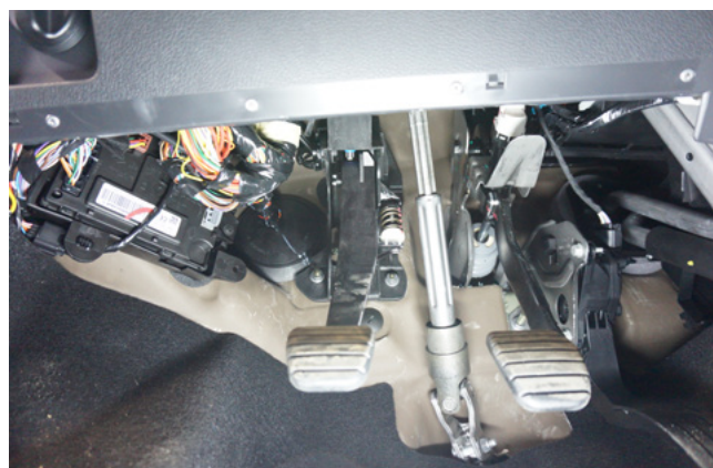
Фото 1.5 Декоративная накладка педального узла снята
