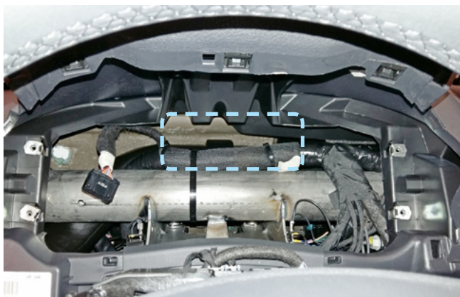
Фото 2.10. Пример расположения центрального блока охранно-телематического комплекса
