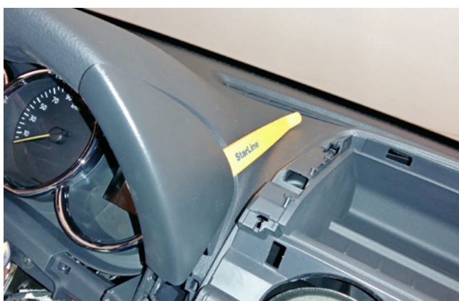
Фото 1.14. Снять накладку справа от панели приборов
