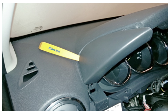
Фото 1.15. Снять накладку слева от панели приборов
