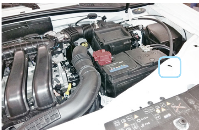
Фото 2.7. Возможное место установки концевика капота
