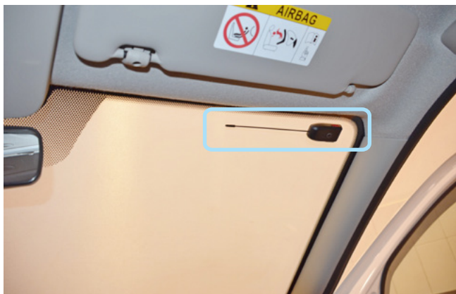
Фото 2.1. Возможное место установки антенного модуля
