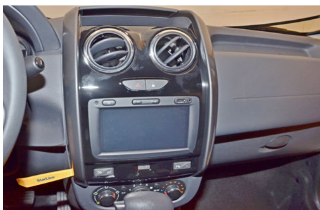
Фото 1.10. Снять накладку центральной консоли
