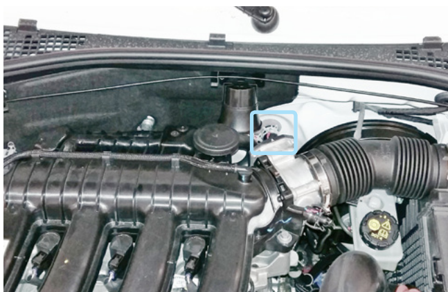
Фото 2.5. Место установки датчика температуры двигателя
