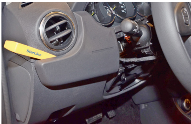
Фото 1.6. Снять пластиковую накладку слева от рулевой колонки
