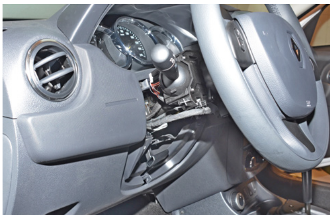
Фото 1.3. Кожух рулевого вала снят
