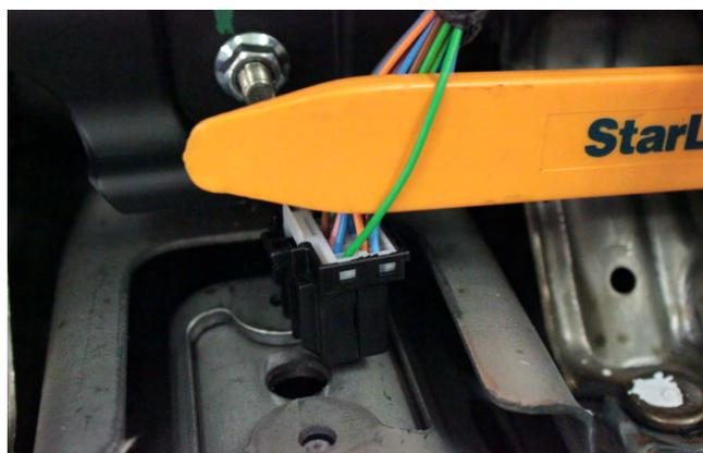
Фото 3.4. Контроль концевика багажника (зелёный)
