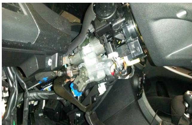
Фото 1.12. Кожух рулевого вала снят
