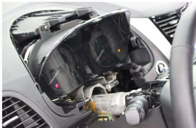
Фото 1.14. Накладка панели приборов снята
