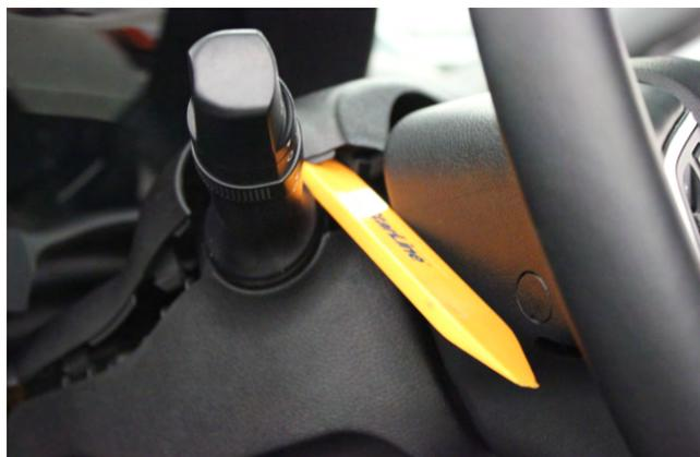
Фото 1.8. Снять верхнюю часть кожуха рулевого вала
