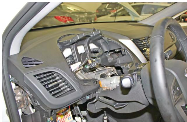
Фото 1.16. Панель приборов снята
