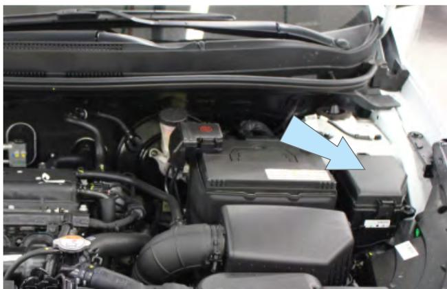
Фото 2.8. Возможное место установки подкапотного блока R6
