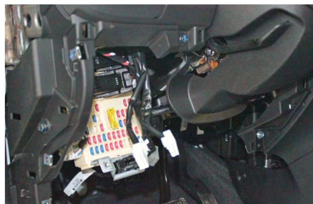
Фото 1.6. Пластиковая накладка под рулевой колонкой снята
