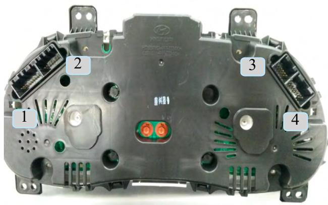
Фото 3.2. Нумерация разъёмов панели приборов
