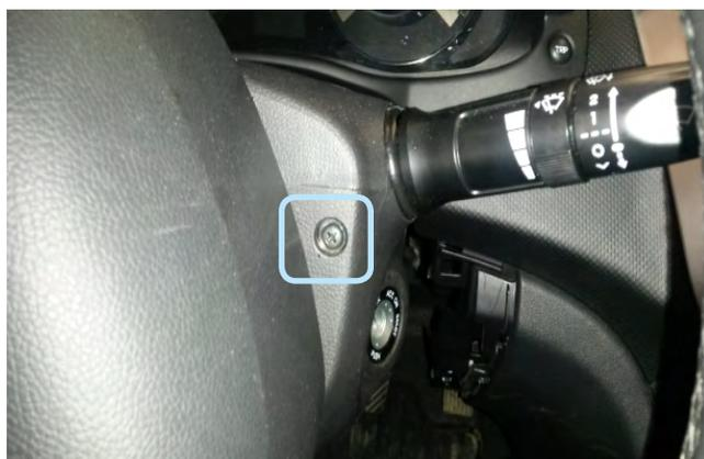
Фото 1.10. Саморез крепления нижней части кожуха рулевого вала справа
