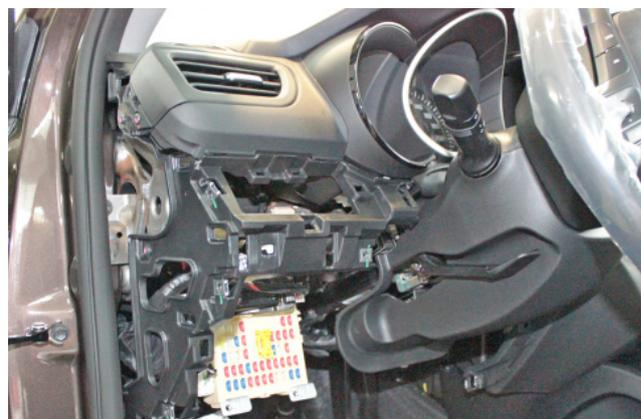
Фото 1.15. Пластиковая накладка под рулевой колонкой снята
