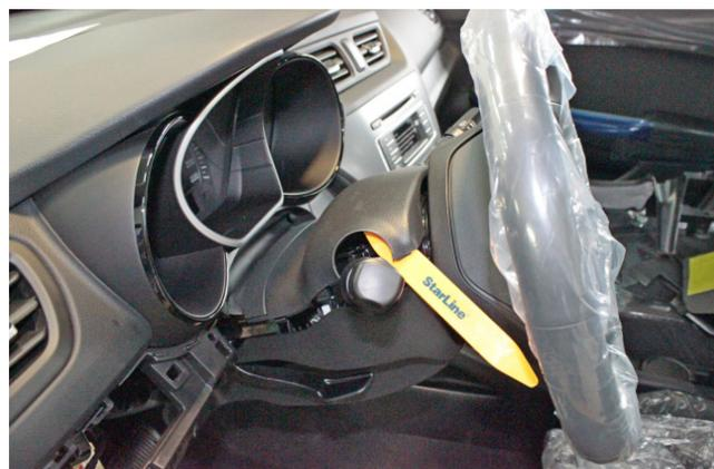
Фото 1.17. Снять верхнюю часть кожуха рулевого вала
