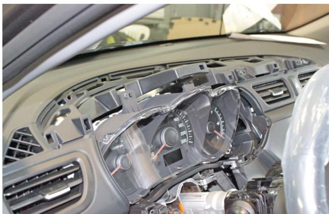
Фото 1.24. Накладка панели приборов снята
