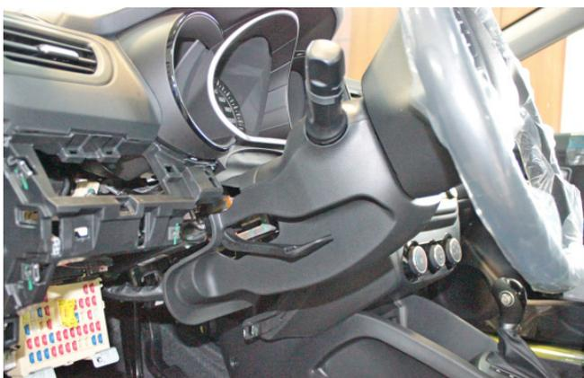
Фото 1.16. Кожух рулевого вала. Общий вид
