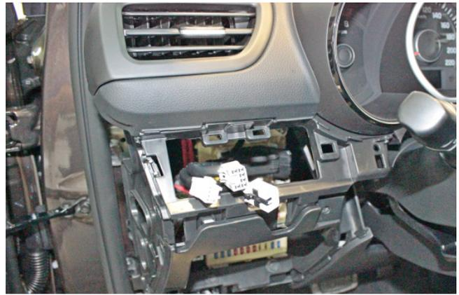
Фото 1.7. Блок кнопок управления снят
