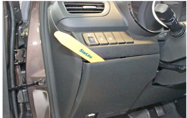
Фото 1.2. Снять крышку монтажного блока предохранителей
