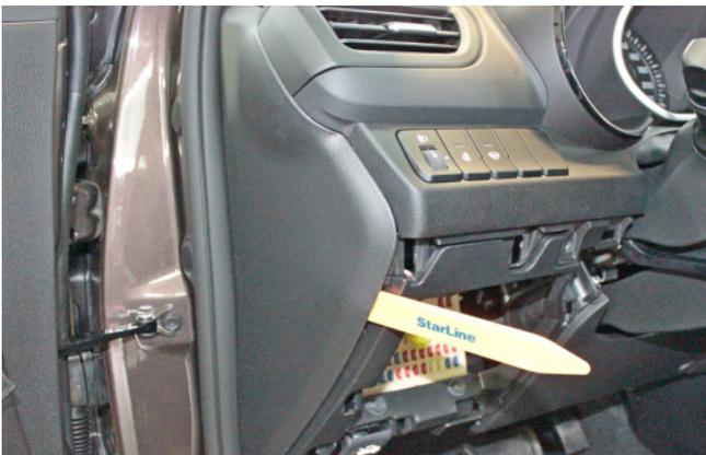
Фото 1.3. Снять боковую накладку передней панели
