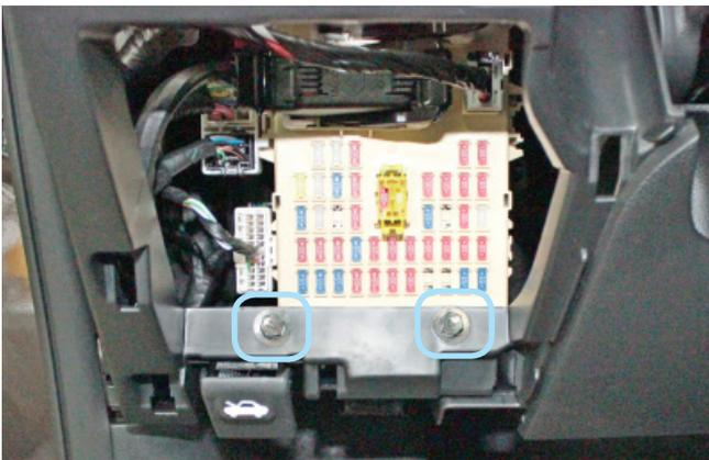
Фото 1.8. Болты крепления пластиковой накладки под рулевой колонкой
