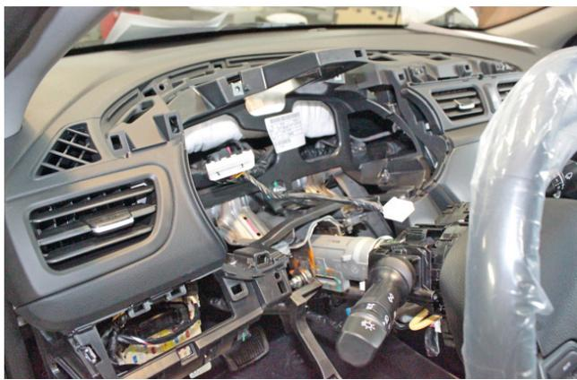
Фото 1.25. Панель приборов снята
