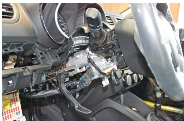
Фото 1.21. Кожух рулевого вала снят
