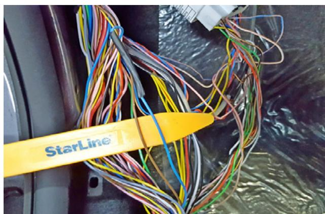
Фото 3.6. Управление световыми сигналами (коричневый и синий)
