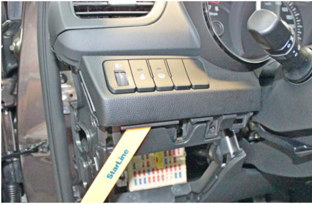
Фото 1.6. Снять блок кнопок слева от рулевой колонки
