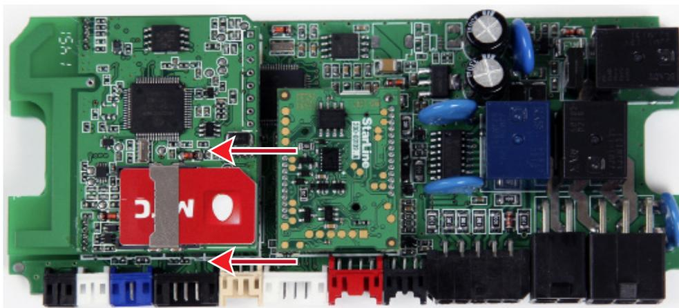
1.3. Установить плату в корпус и завернуть четыре винта.
