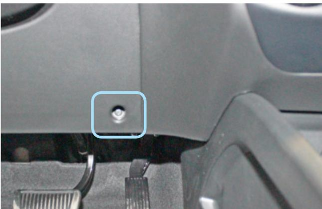
Фото 1.10. Саморез крепления пластиковой накладки под рулевой колонкой
