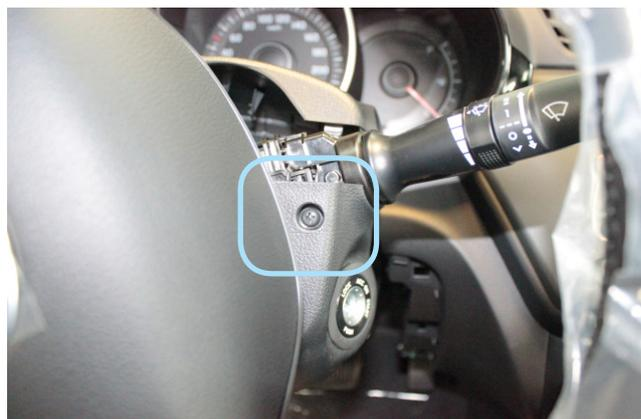
Фото 1.19. Саморез крепления нижней части кожуха рулевого вала справа
