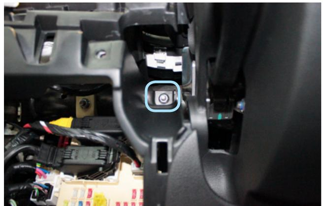
Фото 1.9. Гайка крепления пластиковой накладки под рулевой колонкой
