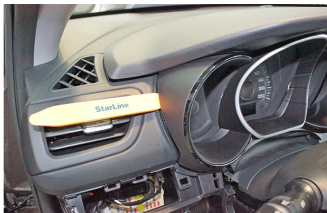
Фото 1.23. Снять декоративную накладку панели приборов
