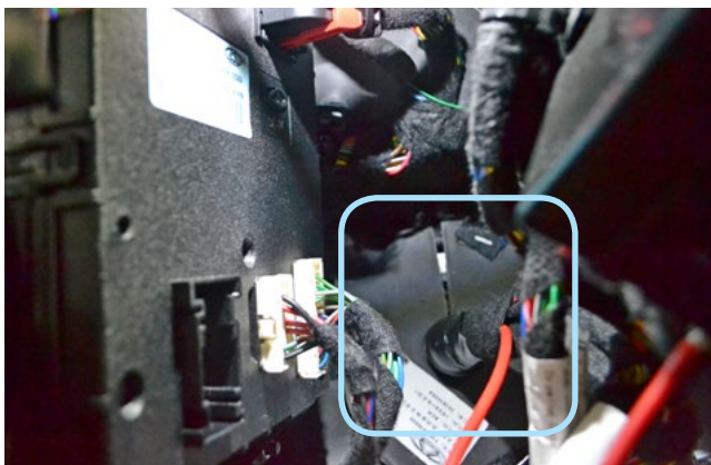
Фото 2.9. Штатный уплотнитель. Вид со стороны салона
