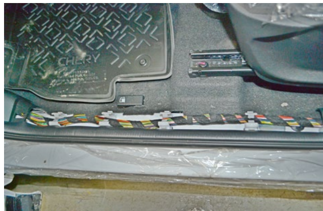
Фото 1.2. Накладка порога двери водителя снята
