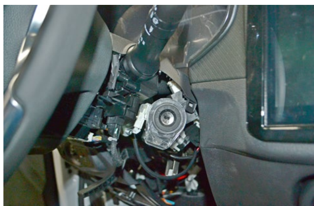
Фото 1.11. Нижняя накладка кожуха рулевого вала снята
