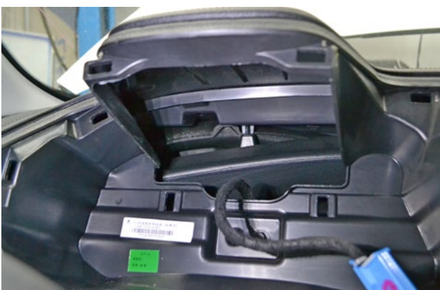
Фото 1.22. Панель приборов снята
