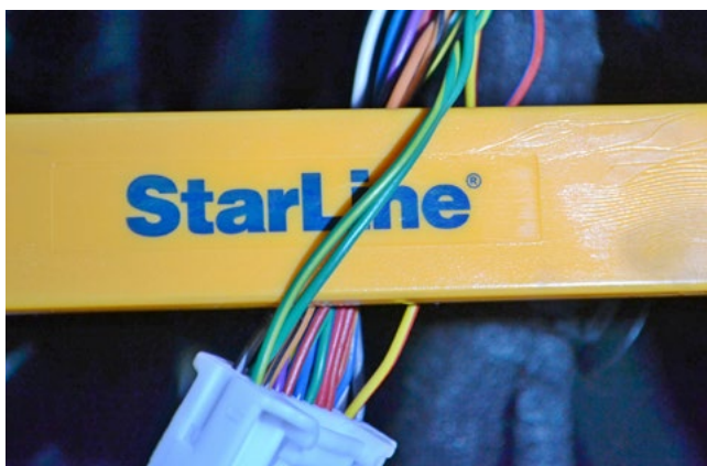
Фото 3.3. Шина CAN-A (зелёный и зелёно-жёлтый)
