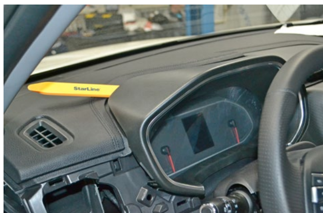
Фото 1.19. Снять накладку панели приборов
