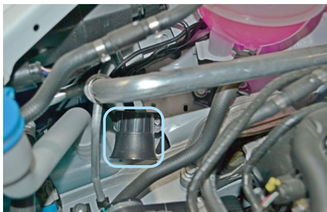
Фото 2.3. Возможное место установки сирены
