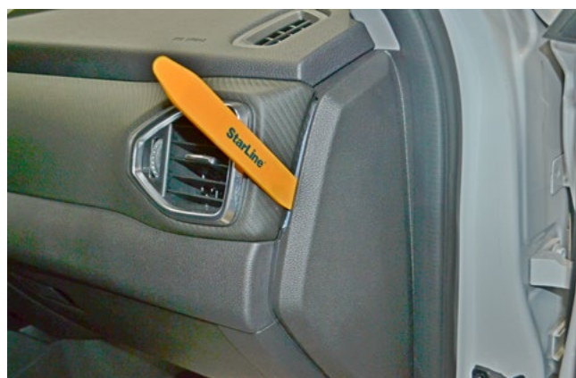
Фото 1.14. Снять правую накладку передней панели
