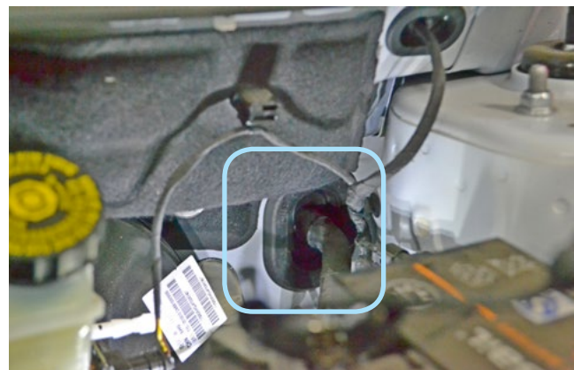
Фото 2.10. Штатный уплотнитель. Вид со стороны капота
