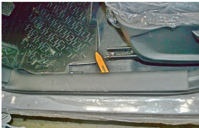
Фото 1.1. Снять накладку порога двери водителя
