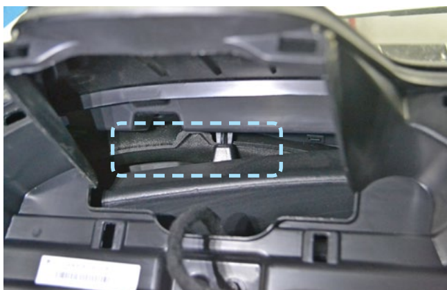
Фото 2.11. Пример расположения центрального блока охранно-телематического комплекса
