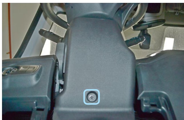
Фото 1.9. Саморез крепления кожуха рулевого вала
