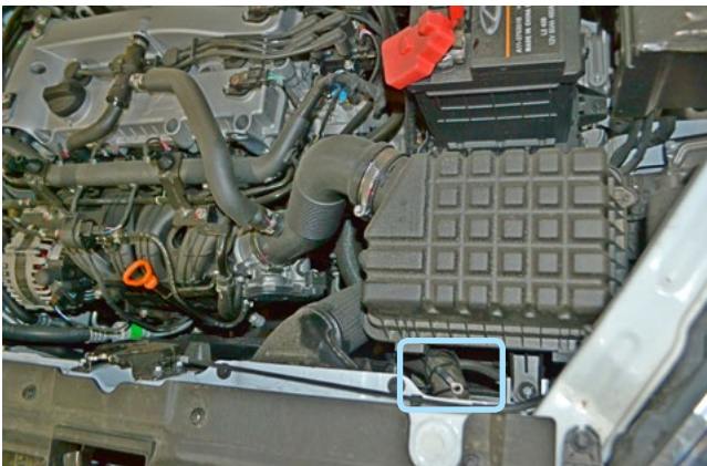
Фото 2.7. Место установки датчика температуры двигателя
