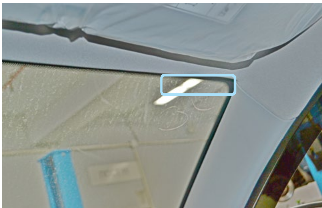
Фото 2.1. Возможное место установки антенного модуля
