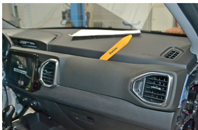
Фото 1.16. Снять накладку передней панели
