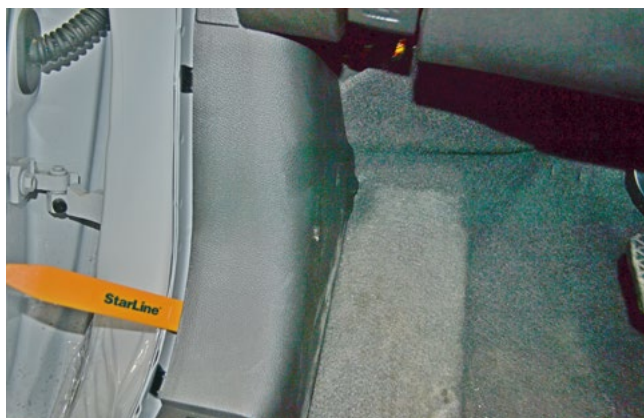
Фото 1.3. Снять накладку левой кик-панели
