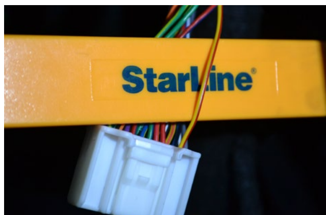
Фото 3.6. Альтернативное управление световыми сигналами (жёлто-красный)
