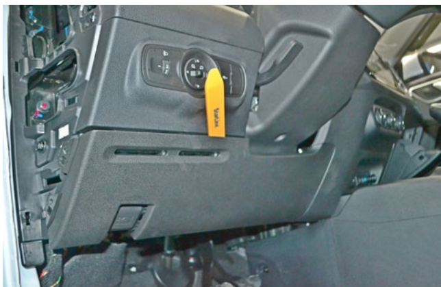
Фото 1.7. Снять накладку под рулевой колонкой
