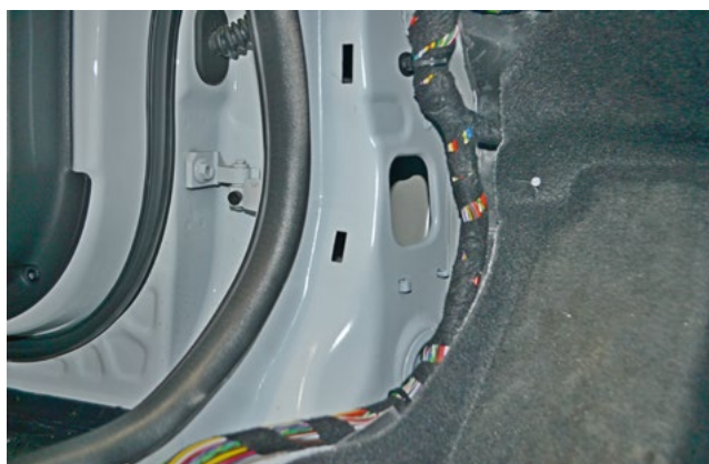
Фото 1.4. Накладка левой кик-панели снята
