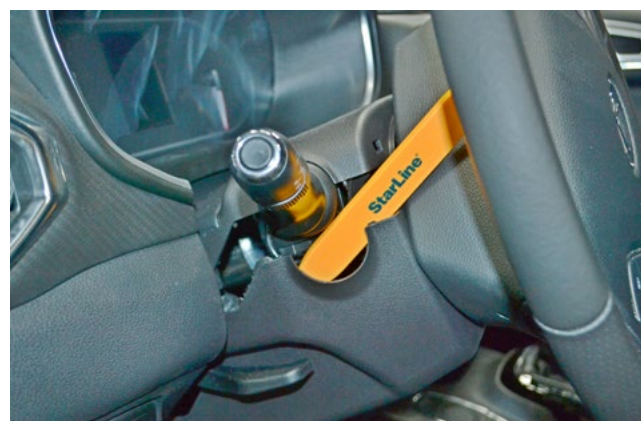
Фото 1.10. Снять нижнюю накладку кожуха рулевого вала
