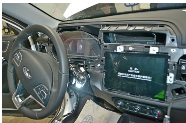
Фото 1.20. Накладка панели приборов снята
