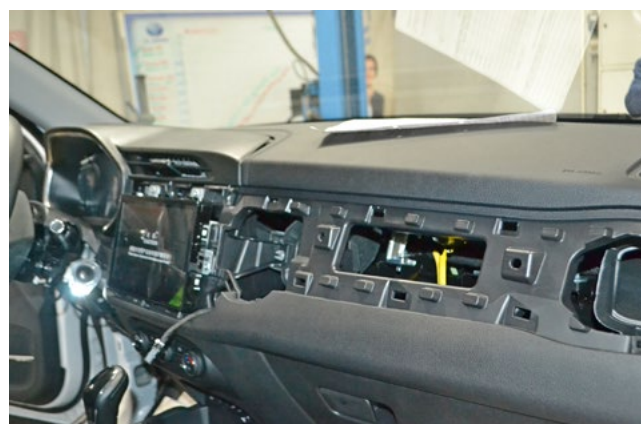
Фото 1.17. Накладка передней панели снята
