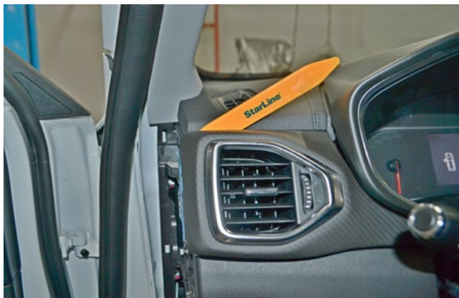
Фото 1.12. Снять накладку левого воздуховода
