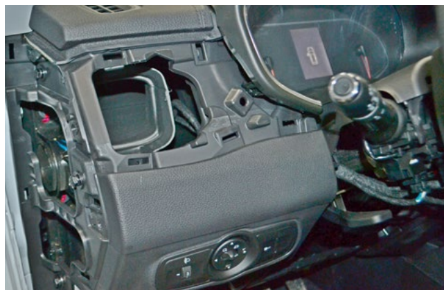
Фото 1.13. Накладка левого воздуховода снята
