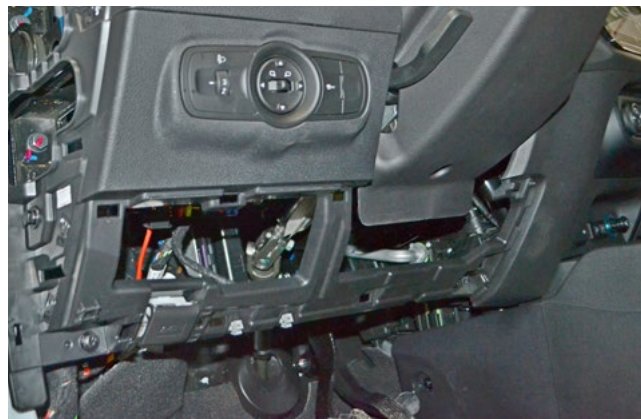
Фото 1.8. Накладка под рулевой колонкой снята
