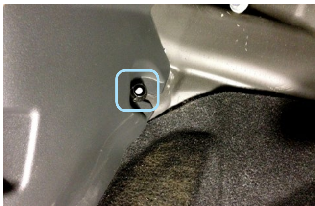
Фото 1.3. Клипса крепления накладки левой кик-панели
