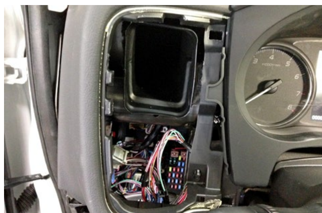
Фото 1.10. Левый воздуховод снят
