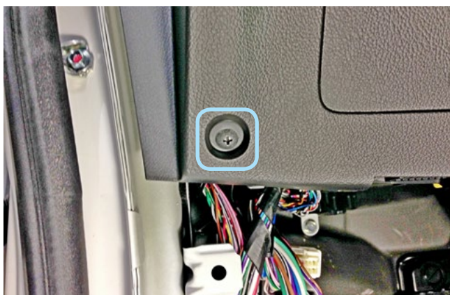
Фото 1.7. Саморез крепления декоративной накладки слева от рулевой колонки
