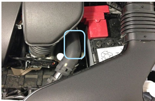
Фото 2.5. Место установки датчика температуры двигателя
