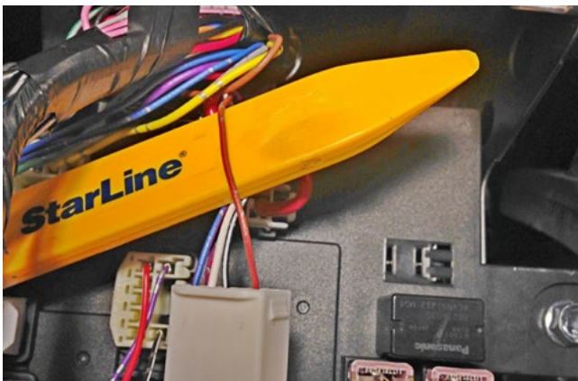
Фото 3.7. Разъём 1, зажигание (коричнево-красный)
