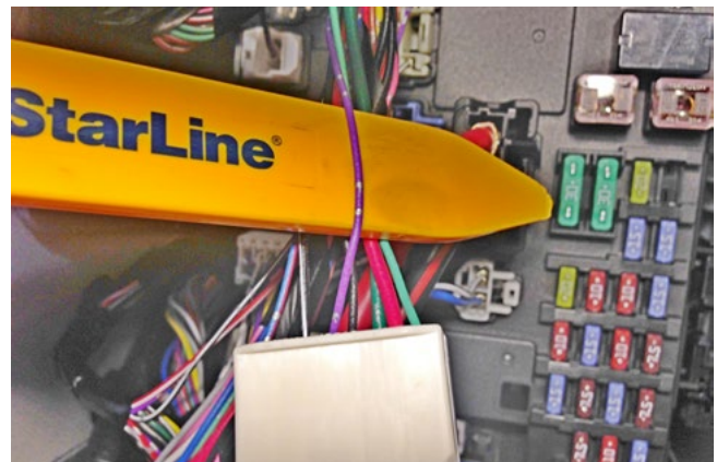
Фото 3.8. Разъём 2, стартер (фиолетовый)
