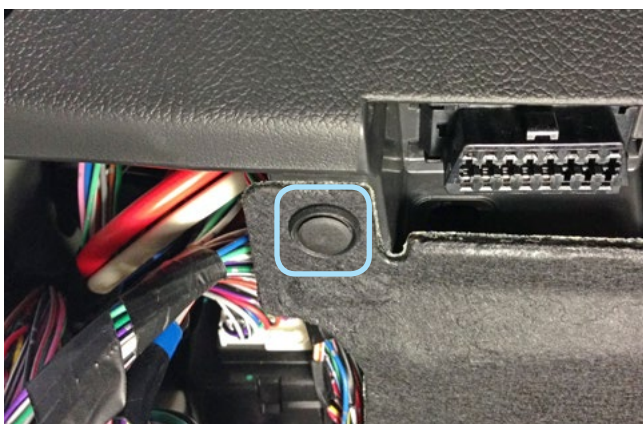
Фото 1.5. Клипса крепления накладки педального узла
