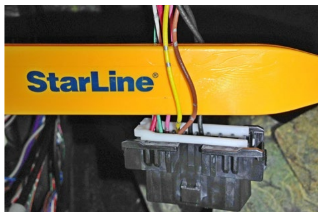
Фото 3.5. Шина CAN-B (коричневый и жёлтый)
