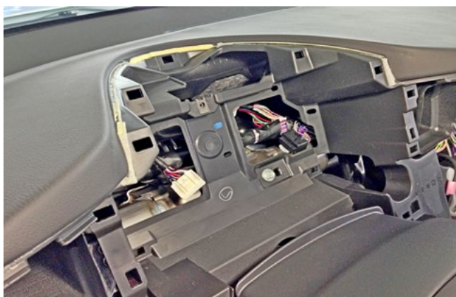
Фото 1.15. Панель приборов снята
