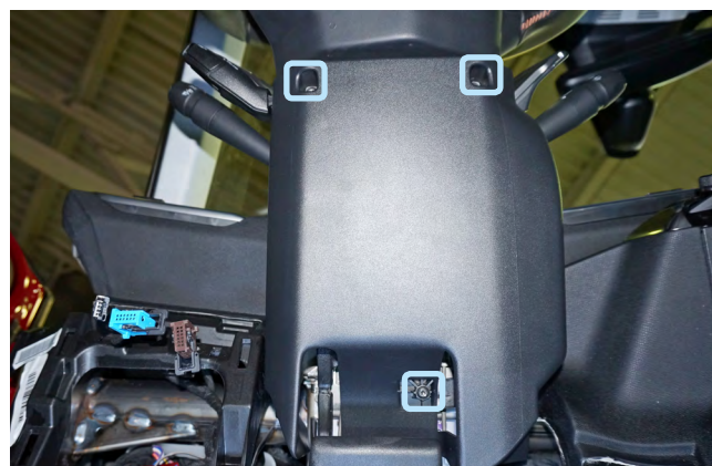
Фото 1.10. Саморезы крепления кожуха рулевого вала
