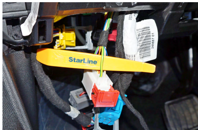
Фото 3.2. Подключение массы (зелёно-жёлтый)
