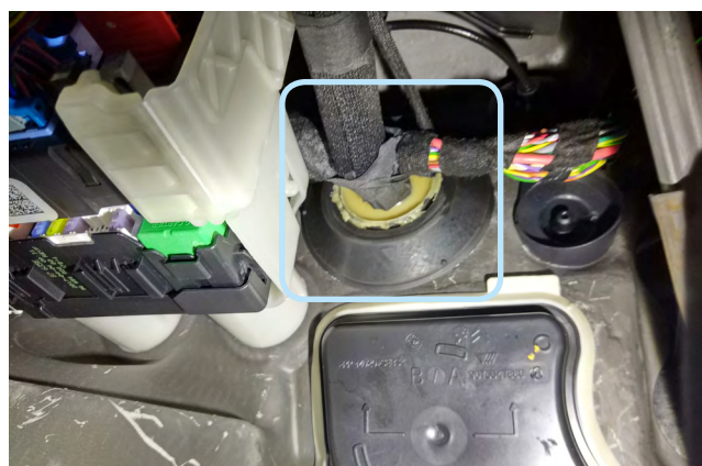
Фото 2.6. Штатный уплотнитель. Вид со стороны салона
