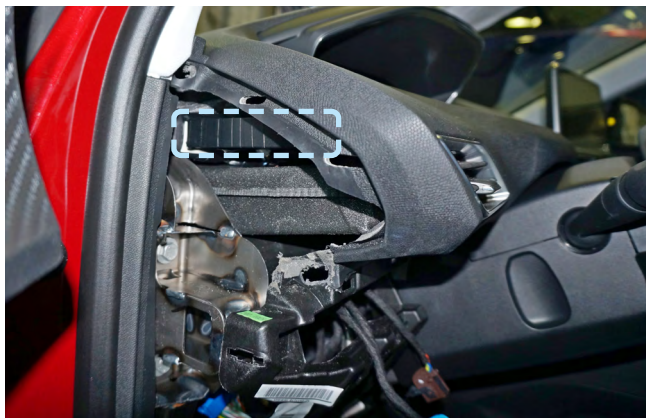
Фото 2.8. Пример расположения центрального блока охранно-телематического комплекса
