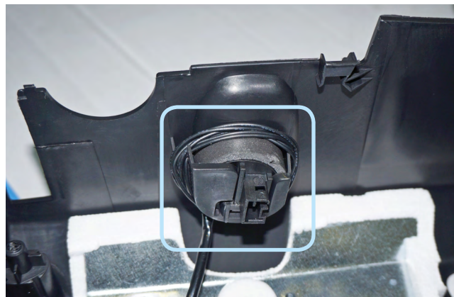
Фото 3.15. Расположение антенны на слоте аварийного запуска двигателя
