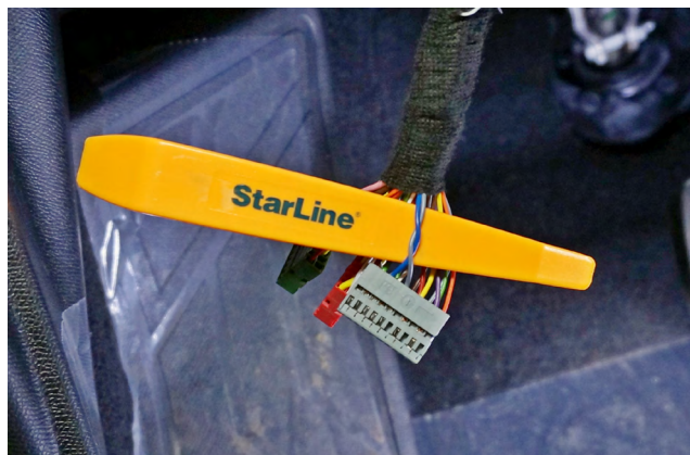
Фото 3.4. Шина CAN-A (серый и синий)
