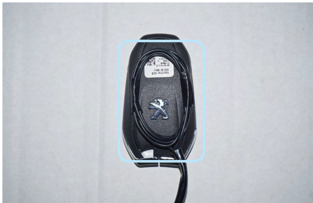
Фото 3.14. Расположение антенны на ключе
