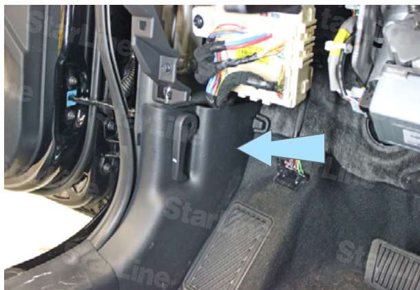
Фото 7.1. Декоративная накладка кик-панели
