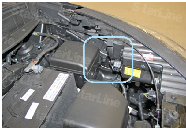
Фото 5.1. Возможное место установки сирены
