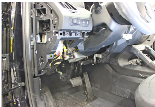
Фото 1.5. Коленный буфер снят
