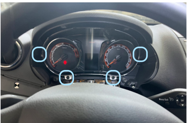
Фото 1.11 Декоративная накладка снята. Саморезы крепления панели приборов
