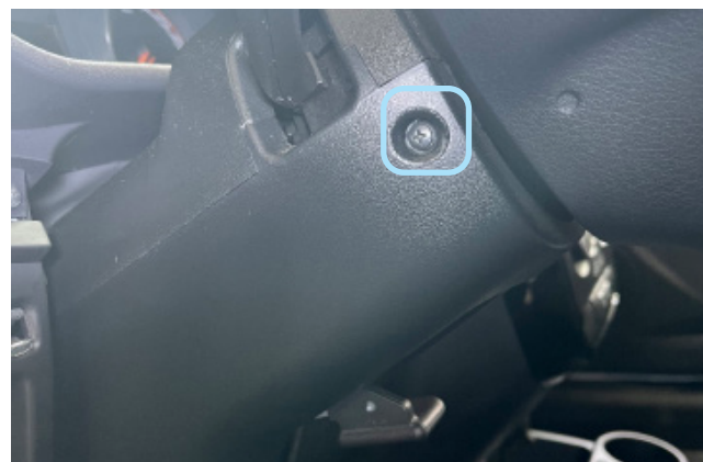
Фото 1.4. Саморез крепления кожуха рулевого вала. Слева
