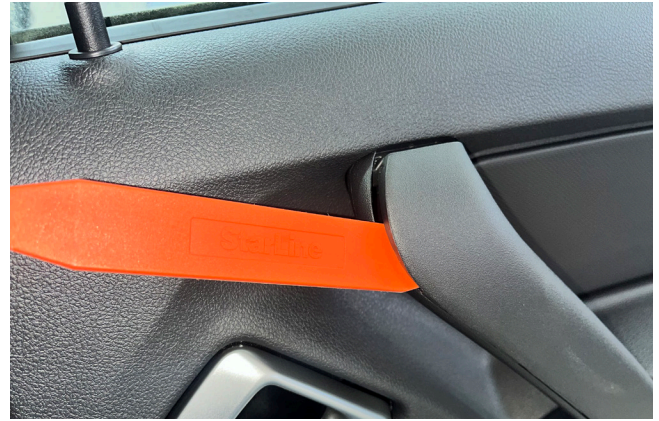
Фото 1.19. Снять накладку ручки двери
