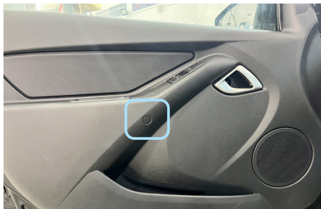
Фото 1.14. Снять центральную заглушку.
