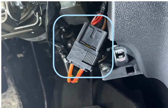
Фото 3.20. Местоположение разъёма замка зажигания
