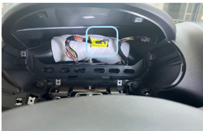
Фото 3.2. Местоположение разъёма панели приборов
