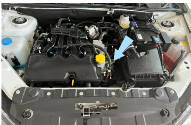
Фото 2.4. Место установки датчика температуры двигателя
