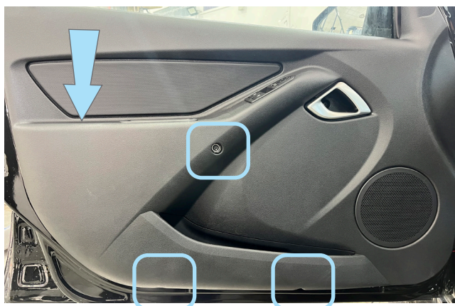
Фото 1.15. Центральная заглушка снята, саморезы крепления.
