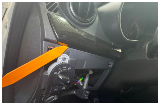
Фото 1.3. Снять декоративную накладку
