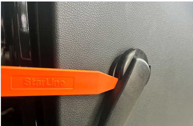
Фото 1.20. Снять ручку стеклоподъёмника
