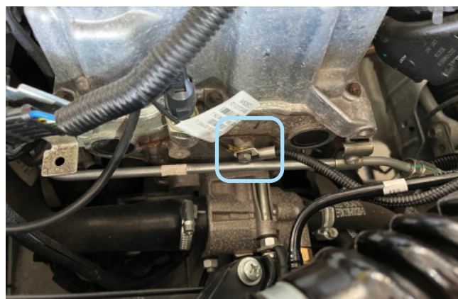
Фото 2.5. Установка датчика температуры двигателя
