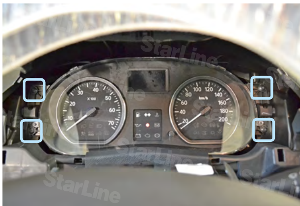
Фото 1.9. Саморезы крепления панели приборов
