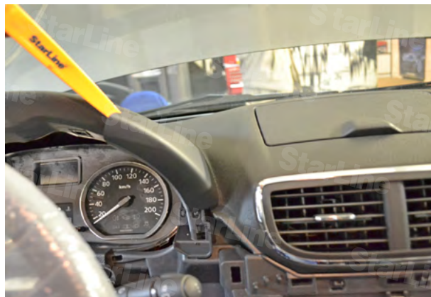
Фото 1.8. Снять декоративную накладку панели приборов справа
