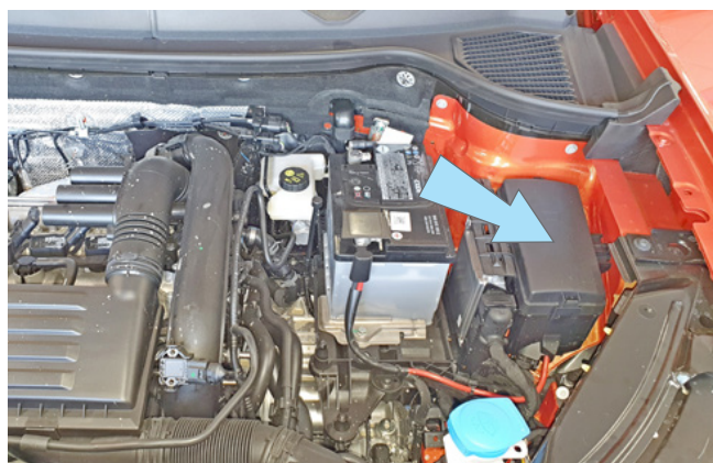
Фото 2.8. Возможное место установки подкапотного блока R6
