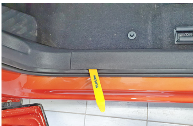
Фото 1.14. Частично снять пластиковую накладку порога двери водителя
