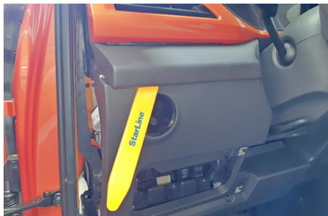
Фото 1.8. Снять накладку под левым воздуховодом
