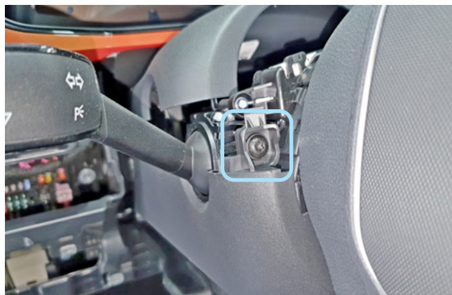
Фото 1.19. Винт крепления нижней части кожуха рулевого вала слева
