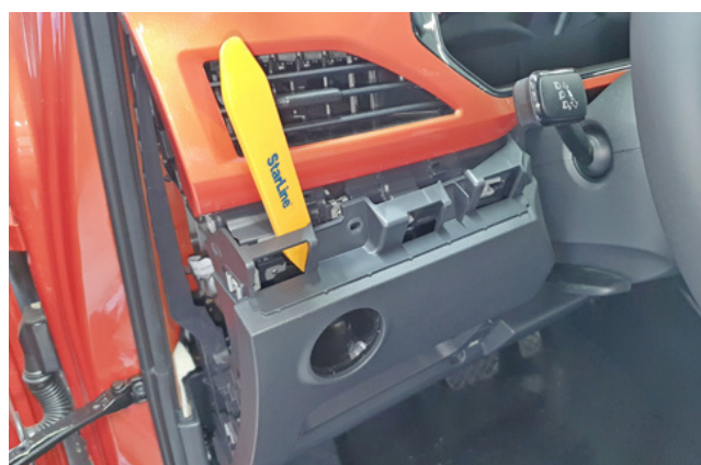
Фото 1.10. Снять накладку слева от рулевой колонки
