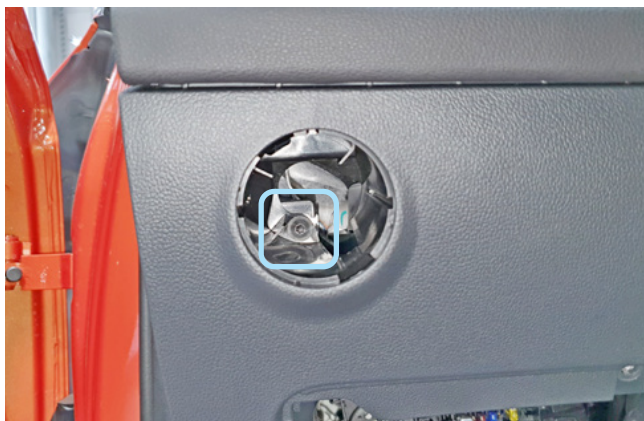
Фото 1.7. Переключатель света снят. Саморез
