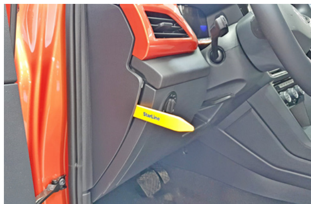
Фото 1.2. Снять боковую накладку передней панели
