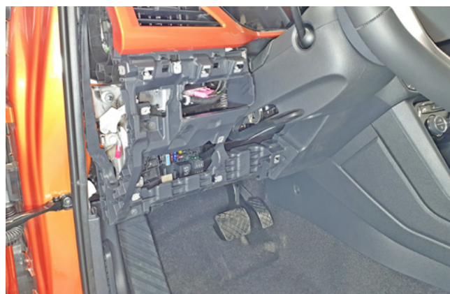
Фото 1.11. Накладка слева от рулевой колонки снята
