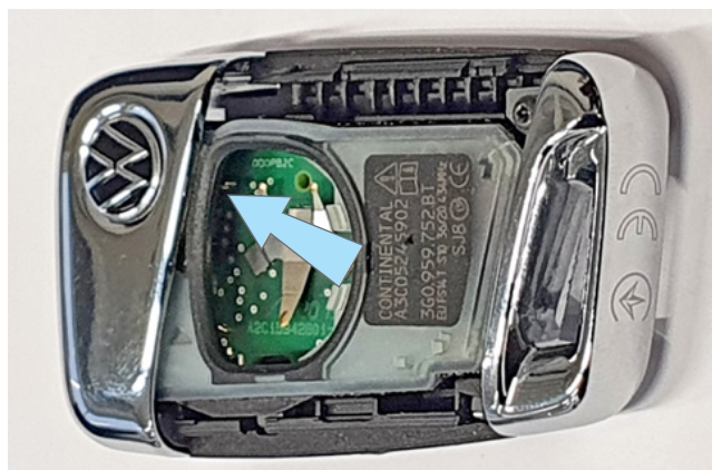
Фото 3.18. Контактная площадка (+) на плате ключа
