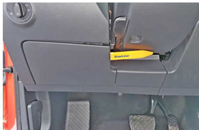
Фото 1.4. Снять крышку блока предохранителей
