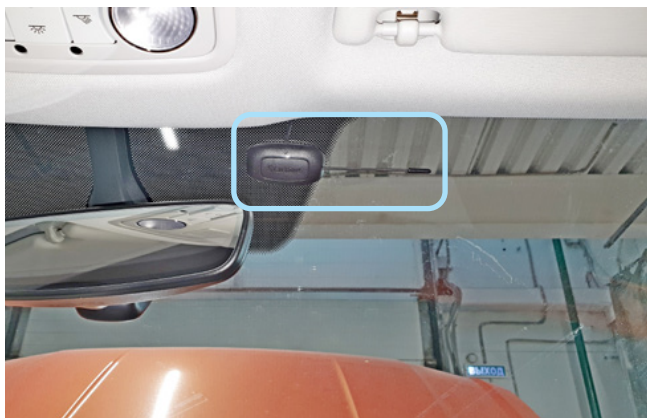
Фото 2.1. Возможное место установки антенного модуля
