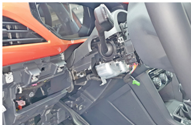
Фото 1.22. Кожух рулевого вала снят
