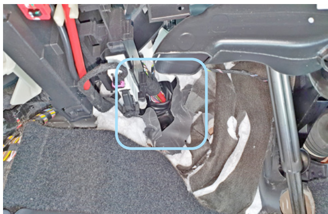
Фото 2.6. Штатный уплотнитель. Вид со стороны салона
