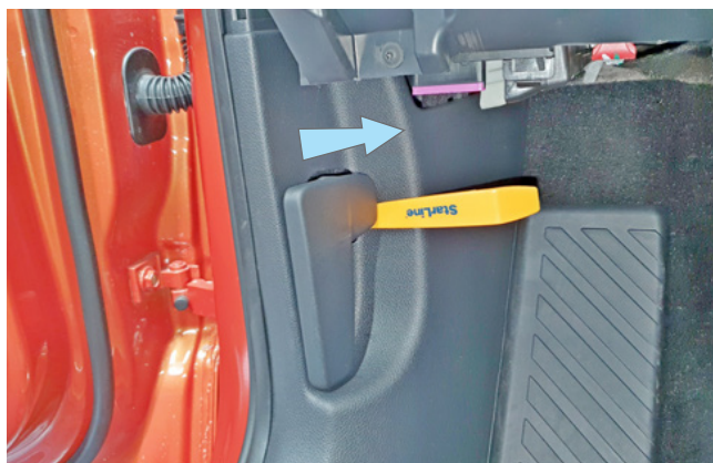
Фото 1.12. Сдвинуть фиксатор ручки отпирания капота в направлении стрелки
