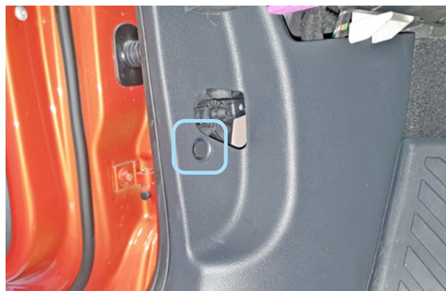
Фото 1.13. Ручка отпирания капота снята. Клипса крепления накладки левой кик-панели
