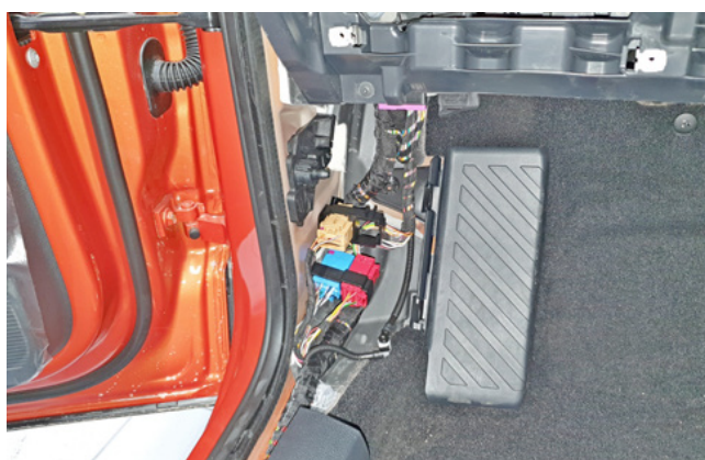
Фото 1.16. Пластиковая накладка левой кик-панели снята
