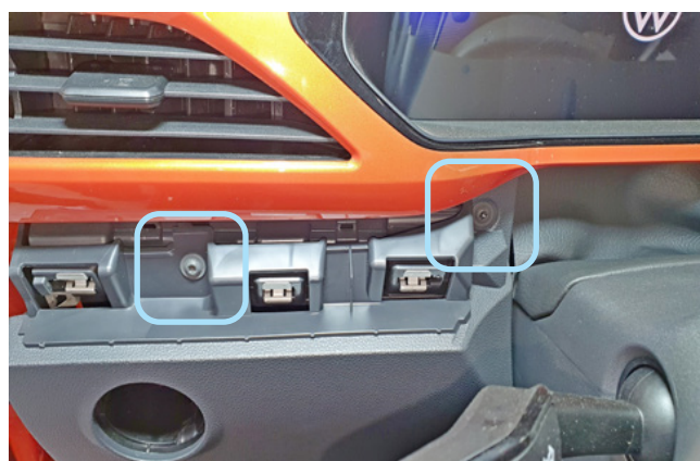
Фото 1.9. Накладка снята. Саморезы
