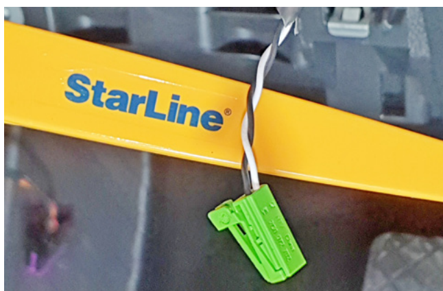
Фото 3.16. Провода антенны штатного иммобилайзера (чёрный и белый)
