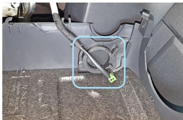
Фото 3.15. Местоположение антенны штатного иммобилайзера
