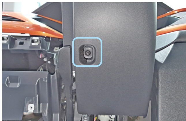
Фото 1.21. Винт крепления нижней части кожуха рулевого вала снизу
