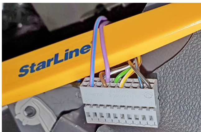
Фото 3.13. Управление кнопкой Старт-Стоп (фиолетовый и фиолетово-синий)
