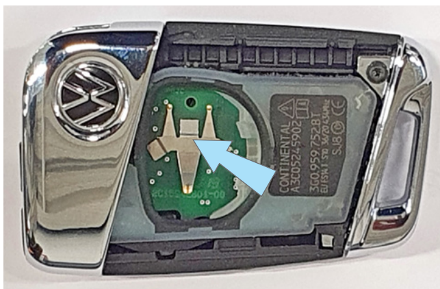
Фото 3.17. Контактная площадка (-) на плате ключа
