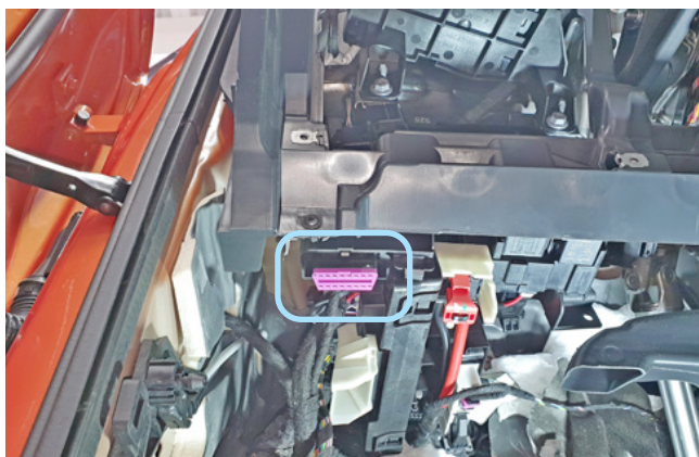
Фото 3.7. Местоположение диагностического разъёма
