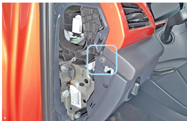
Фото 1.3. Накладка снята. Саморез
