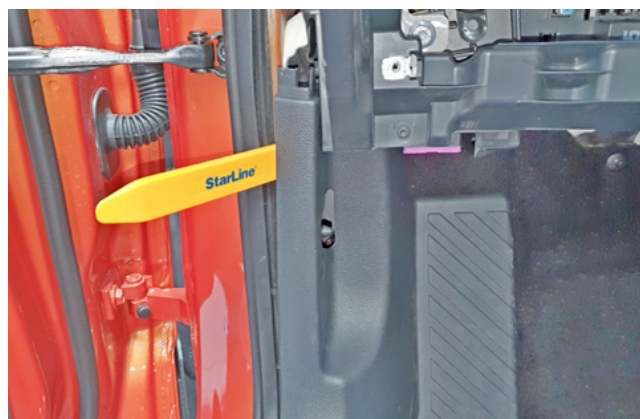
Фото 1.15. Снять пластиковую накладку левой кик-панели
