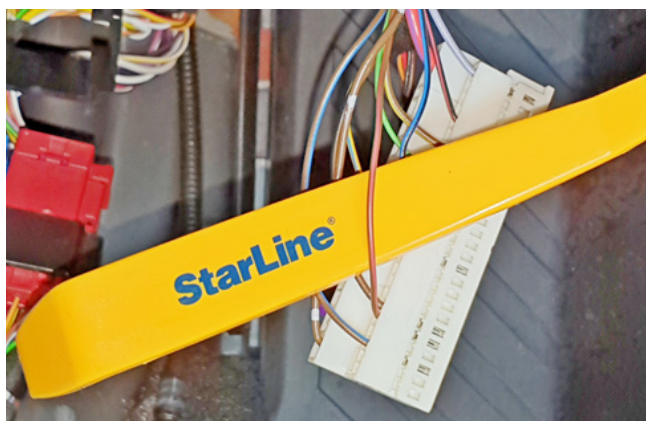
Фото 3.9. Альтернативное управление световыми сигналами (коричнево-красный)
