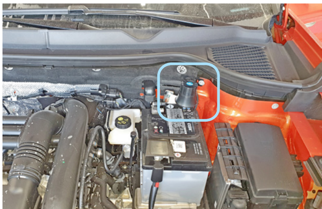
Фото 2.2. Возможное место установки сирены
