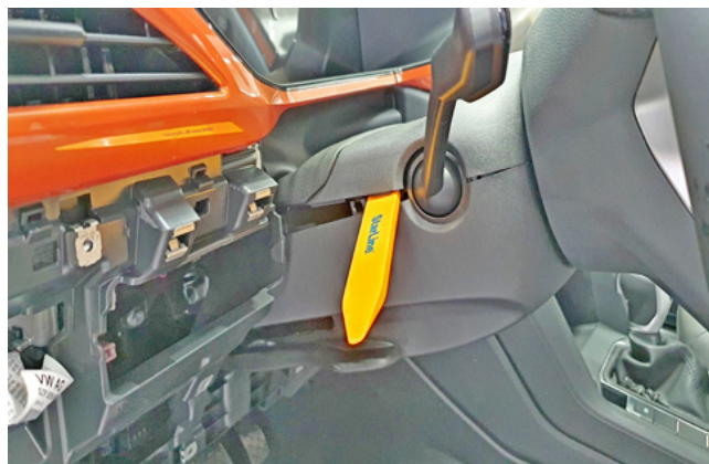
Фото 1.18. Снять верхнюю часть кожуха рулевого вала
