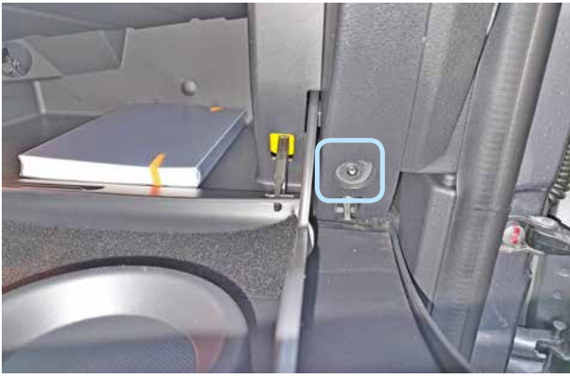
Фото 1.7. Саморез крепления перчаточного ящика справа
