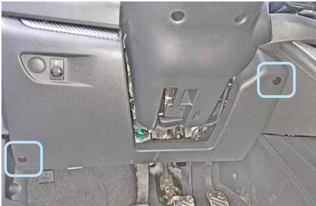
Фото 1.1. Клипсы крепления накладки под рулевой колонкой
