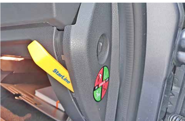
Фото 1.5. Снять правую накладку передней панели
