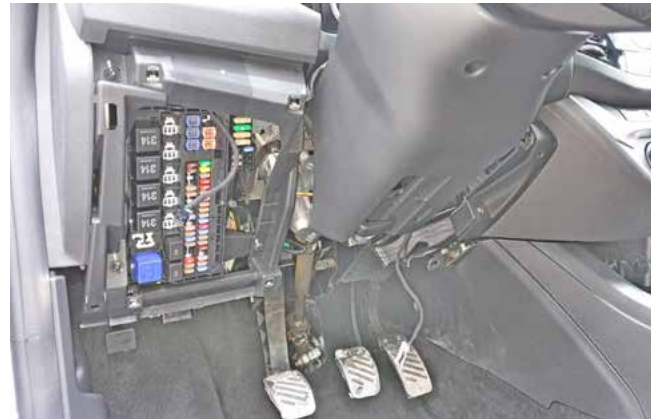
Фото 1.2. Накладка под рулевой колонкой снята
