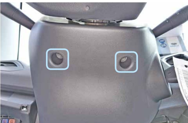
Фото 1.3. Саморезы крепления кожуха рулевого вала
