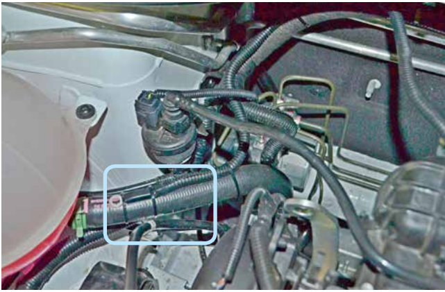
Фото 2.4. Место установки датчика температуры двигателя
