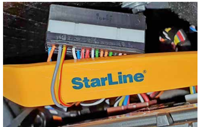
Фото 3.4. Шина CAN-A (жёлто-красный и серый)
