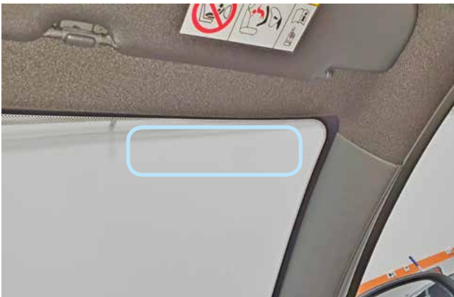
Фото 2.1. Возможное место установки антенного модуля
