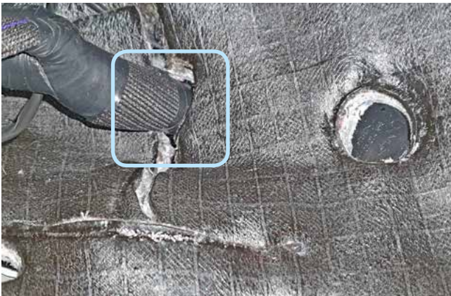
Фото 2.6. Штатный уплотнитель. Вид со стороны салона
