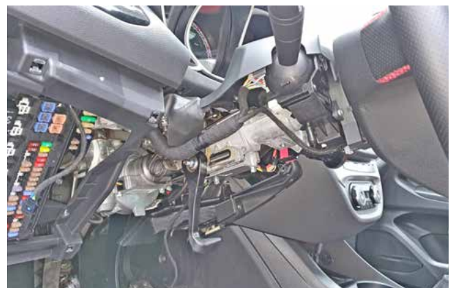
Фото 1.4. Нижняя часть кожуха рулевого вала снята
