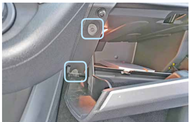
Фото 1.6. Саморезы крепления перчаточного ящика слева
