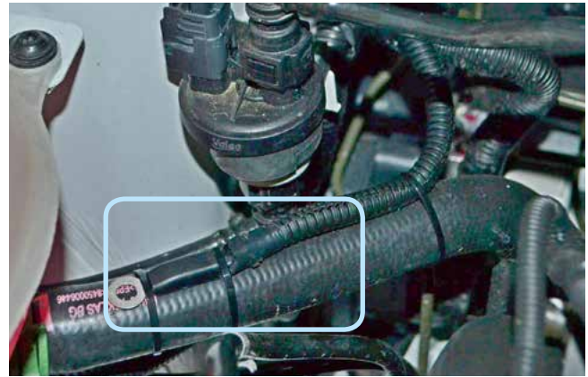
Фото 2.5. Крепление датчика температуры двигателя
