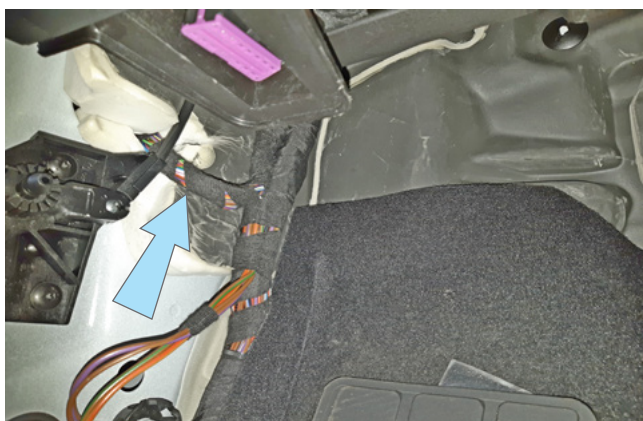
Фото 3.10. Местоположение жгута в левой кик-панели
