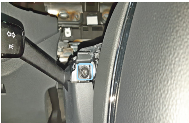
Фото 1.17. Винт крепления кожуха рулевого вала слева
