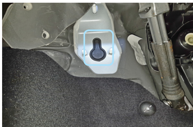
Фото 2.7. Штатный уплотнитель. Вид со стороны салона
