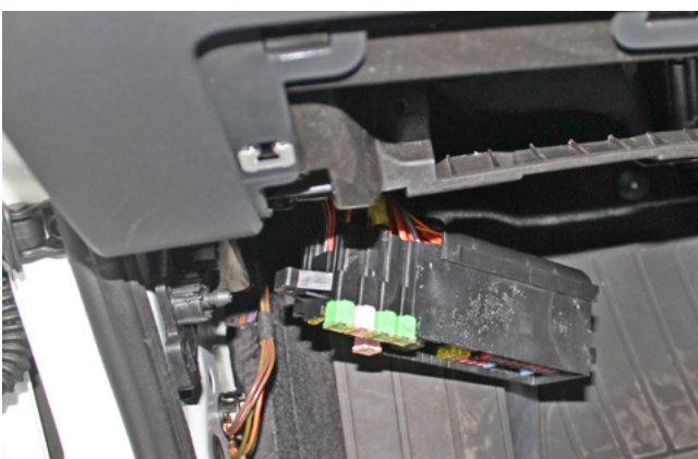
Фото 1.16. Блок предохранителей снят
