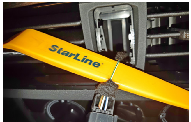
Фото 3.7. Управление световыми сигналами (бело-зелёный)
