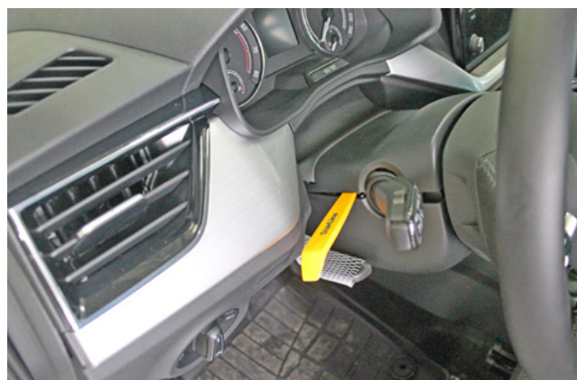
Фото 1.2. Снять верхнюю часть кожуха рулевого вала
