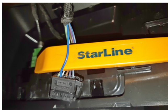
Фото 3.9. Управление центральным замком (синий)
