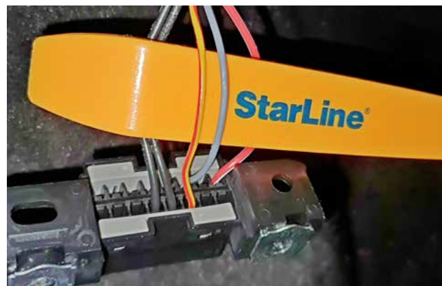
Фото 3.4. Шина CAN-A (жёлто-красный и серый)
