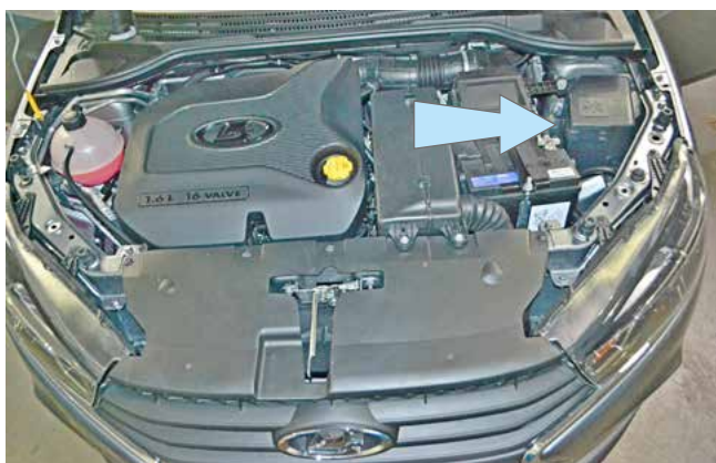
Фото 2.7. Возможное место установки подкапотного блока R6
