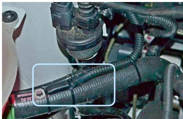
Фото 2.5. Крепление датчика температуры двигателя
