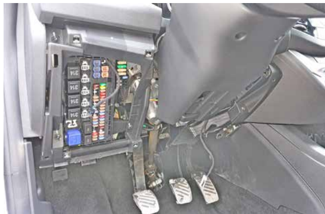
Фото 1.2. Накладка под рулевой колонкой снята
