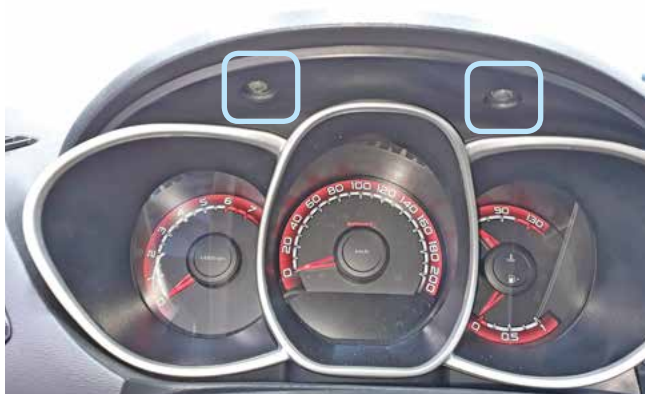
Фото 1.5. Саморезы крепления накладки панели приборов
