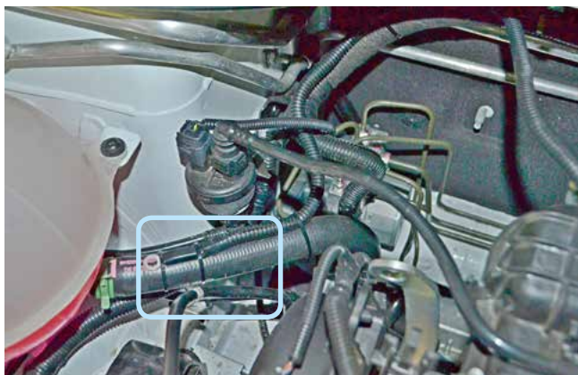
Фото 2.4. Место установки датчика температуры двигателя
