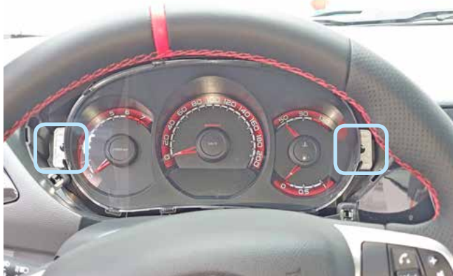
Фото 1.7. Саморезы крепления панели приборов
