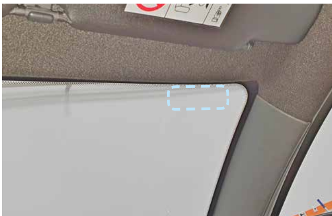
Фото 2.1. Возможное место установки антенного модуля
