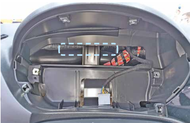
Фото 2.8. Пример расположения центрального блока охранно-телематического комплекса
