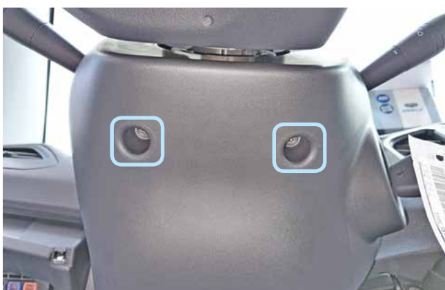
Фото 1.3. Саморезы крепления кожуха рулевого вала
