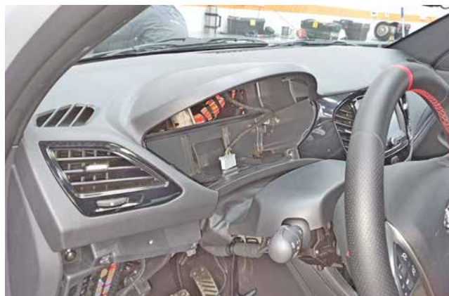
Фото 1.8. Панель приборов снята
