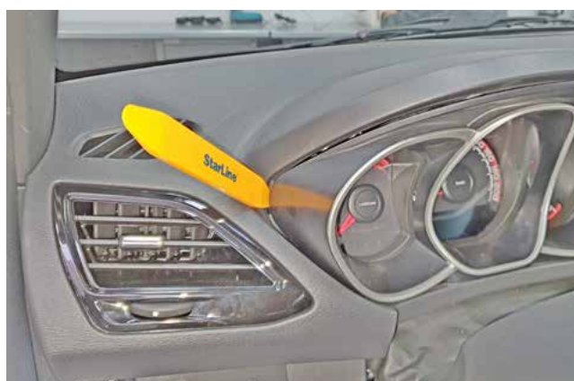
Фото 1.6. Снять накладку панели приборов
