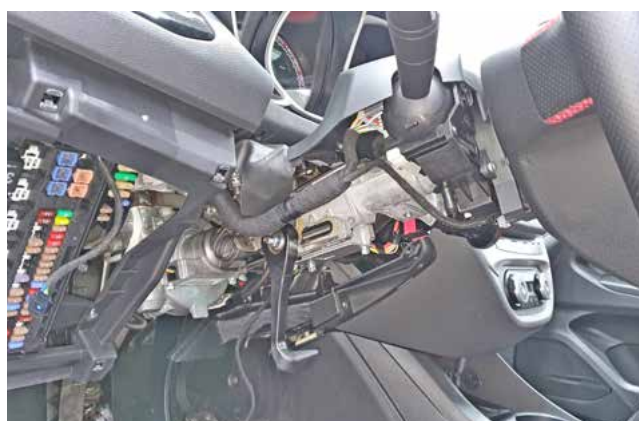
Фото 1.4. Нижняя часть кожуха рулевого вала снята
