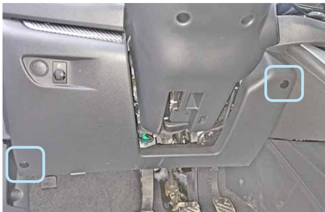
Фото 1.1. Клипсы крепления накладки под рулевой колонкой
