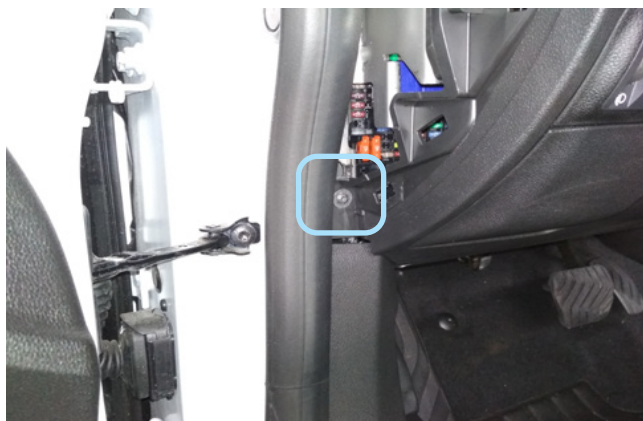
Фото 1.3. Накладка снята. Саморез
