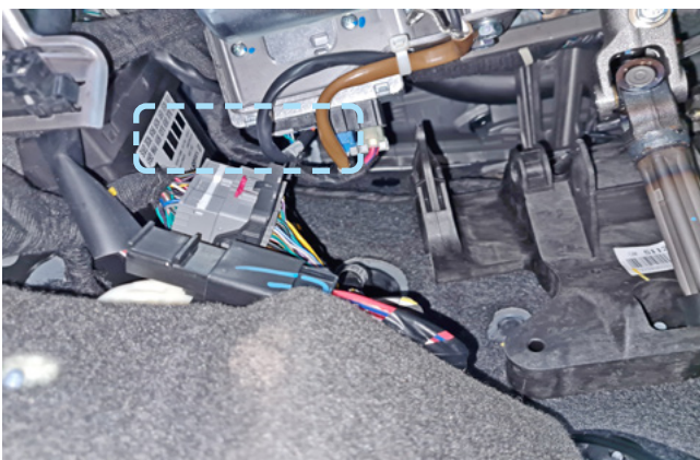
Фото 2.7. Пример расположения центрального блока охранно-телематического комплекса
