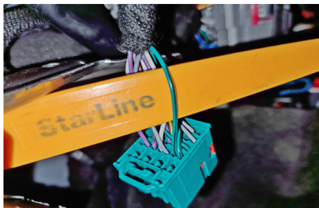
Фото 3.6. Шина данных штатного иммобилайзера (зелёно-чёрный)
