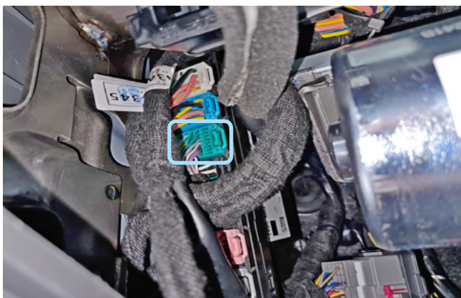
Фото 3.5. Местоположение зелёного разъёма на блоке BCM
