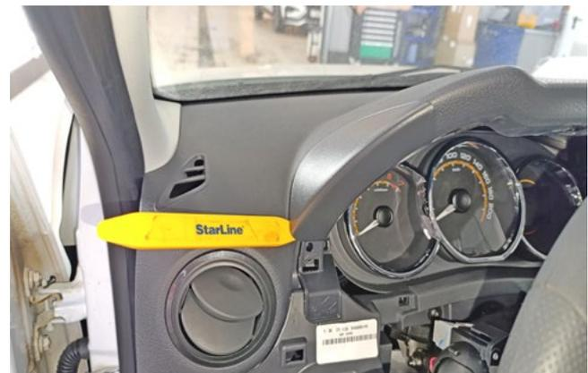
Фото 1.16. Снять накладку слева от панели приборов
