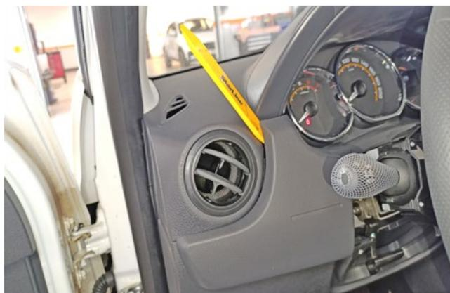
Фото 1.6. Снять пластиковую накладку слева от рулевой колонки
