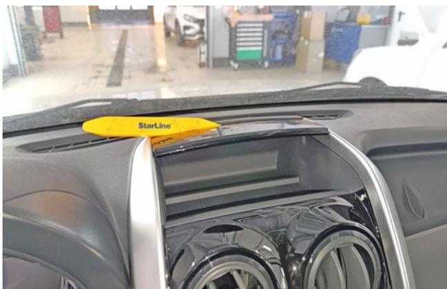
Фото 1.9. Снять пластиковую накладку в верхней части центральной консоли
