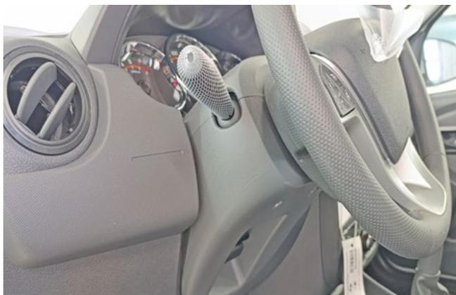
Фото 1.1. Кожух рулевого вала. Общий вид
