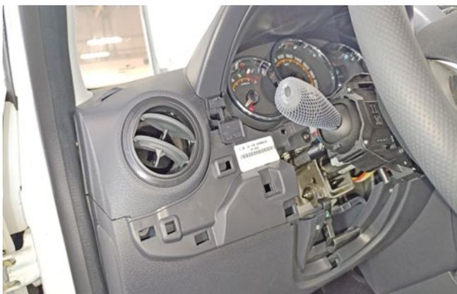
Фото 1.7. Пластиковая накладка снята
