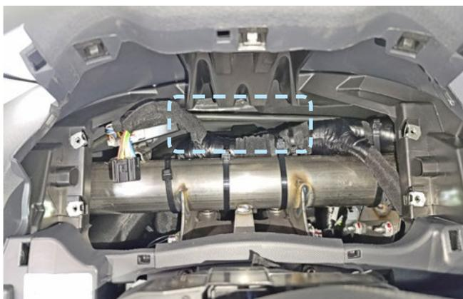
Фото 2.2. Пример расположения центрального блока охранно-телематического комплекса
