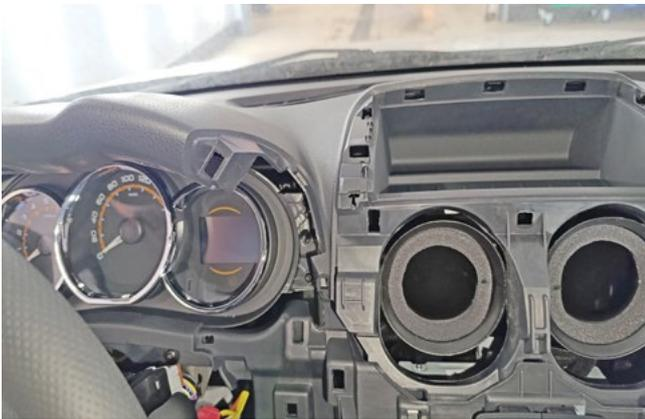
Фото 1.19. Накладка справа от панели приборов снята
