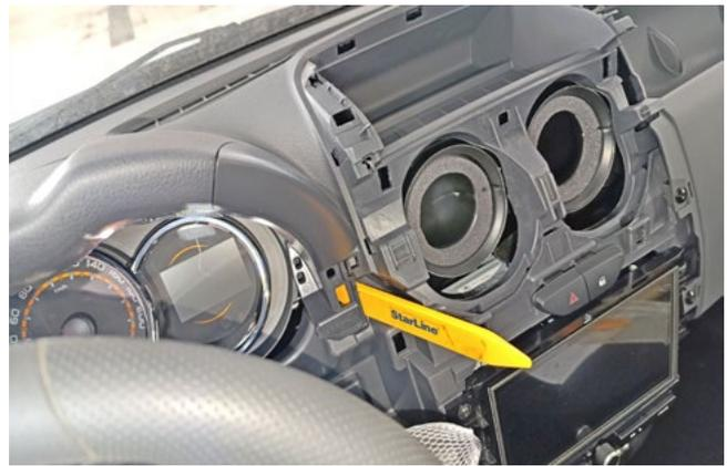
Фото 1.18. Снять накладку справа от панели приборов
