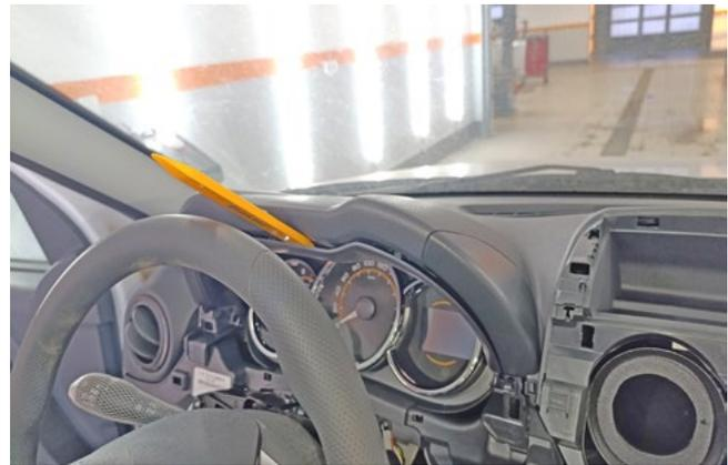
Фото 1.14. Снять декоративную накладку панели приборов
