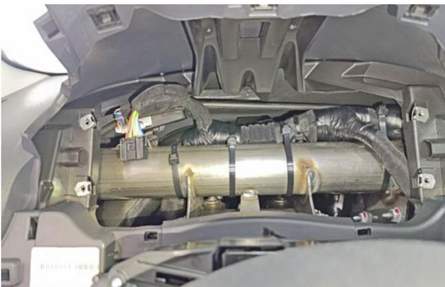
Фото 1.23. Панель приборов снята
