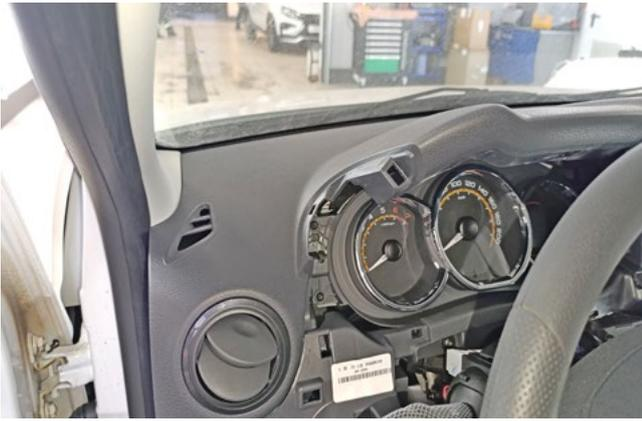
Фото 1.17. Накладка слева от панели приборов снята
