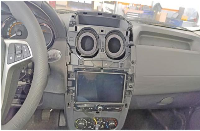
Фото 1.11. Декоративная накладка центральной консоли снята
