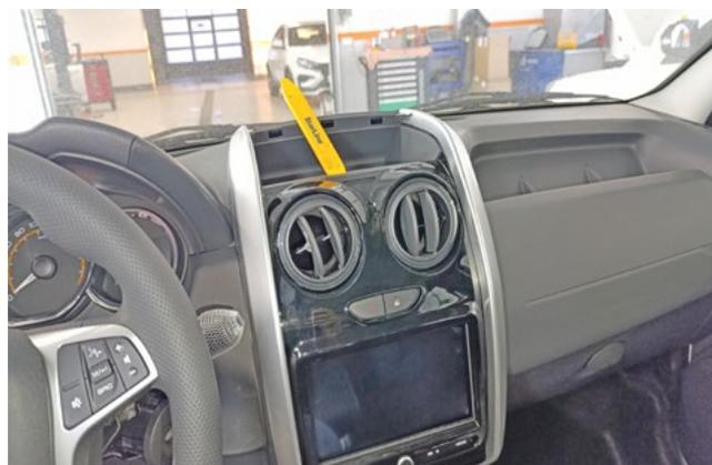
Фото 1.10. Снять декоративную накладку центральной консоли
