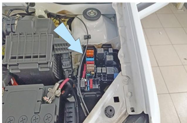
Фото 3.12. Местоположение блока предохранителей под капотом
