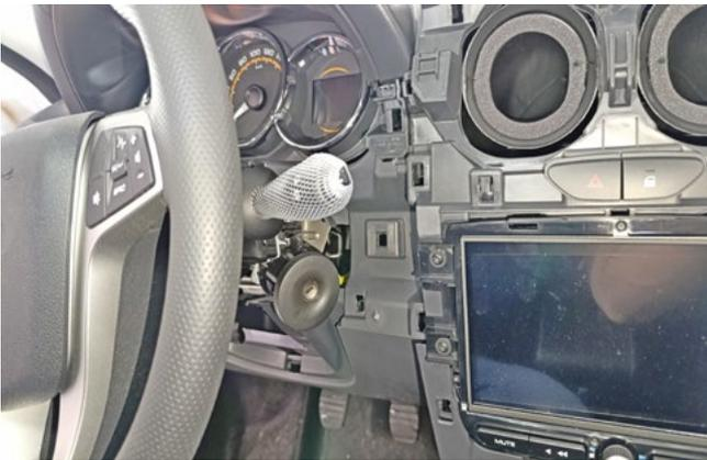
Фото 1.13. Пластиковая накладка снята
