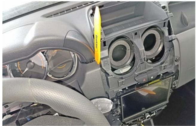
Фото 1.12. Снять пластиковую накладку справа от рулевой колонки
