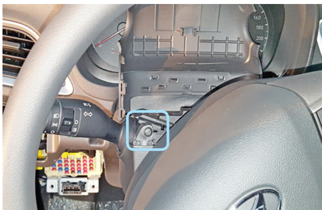
Фото 1.13. Саморез крепления нижней части кожуха рулевого вала слева
