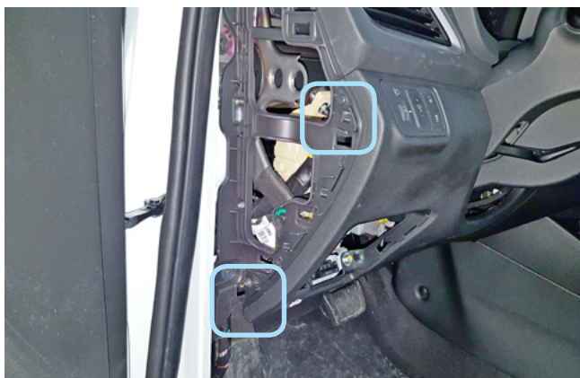
Фото 1.7. Накладка снята. Саморезы
