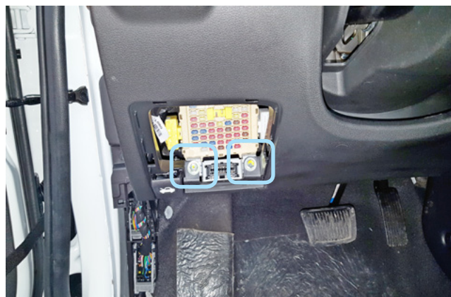
Фото 1.8. Болты крепления пластиковой накладки под рулевой колонкой
