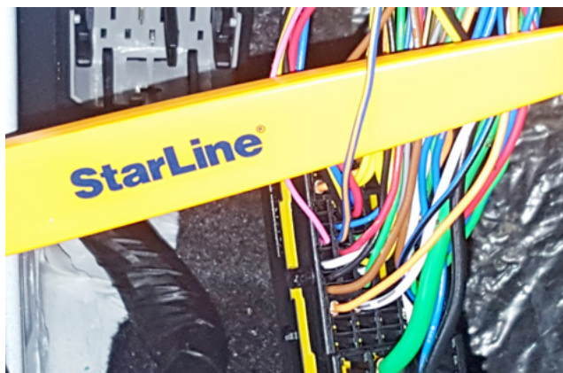
Фото 3.9. Шина данных штатного иммобилайзера (сине-оранжевый)
