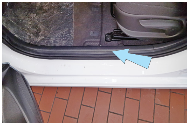
Фото 1.2. Накладка порога двери водителя
