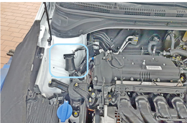
Фото 2.3. Возможное место установки сирены
