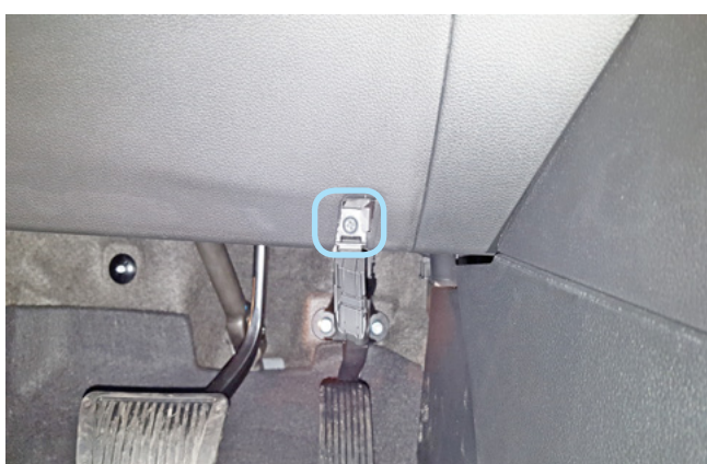
Фото 1.9. Саморез крепления пластиковой накладки под декоративной заглушкой
