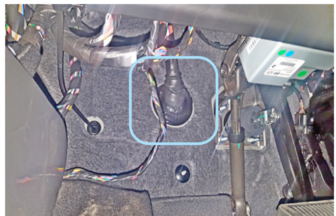
Фото 2.8. Штатный уплотнитель. Вид со стороны салона
