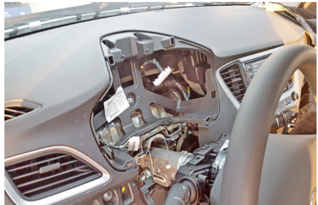
Фото 1.20. Панель приборов снята
