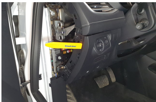
Фото 1.5. Снять пластиковую накладку под рулевой колонкой
