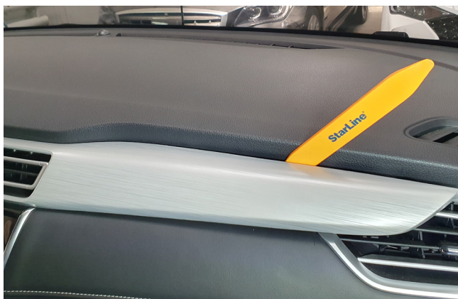
Фото 1.12. Снять декоративную накладку с воздуховодами
