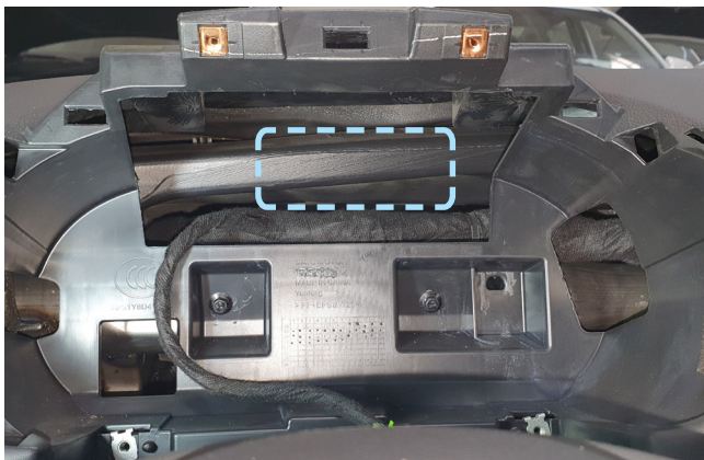
Фото 2.7. Пример расположения центрального блока охранно-телематического комплекса
