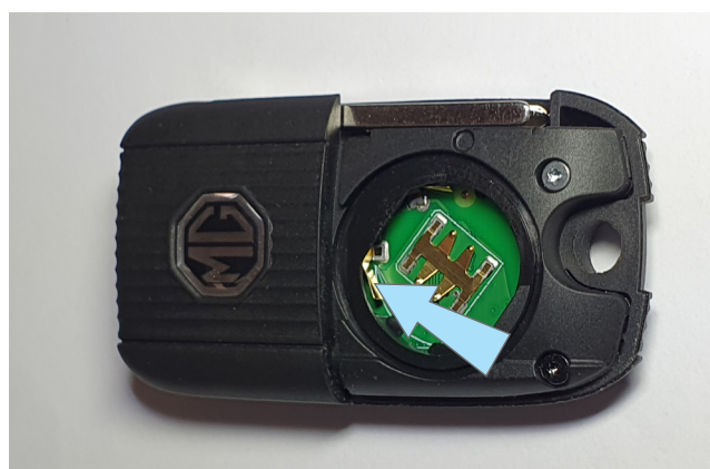
Фото 3.14. Контактная площадка (+) на плате ключа
