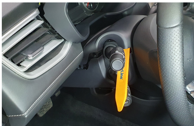
Фото 1.15. Снять верхнюю часть кожуха рулевого вала
