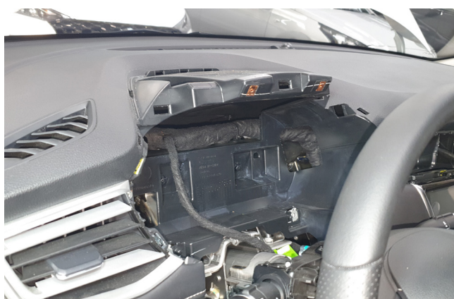
Фото 1.20. Панель приборов снята
