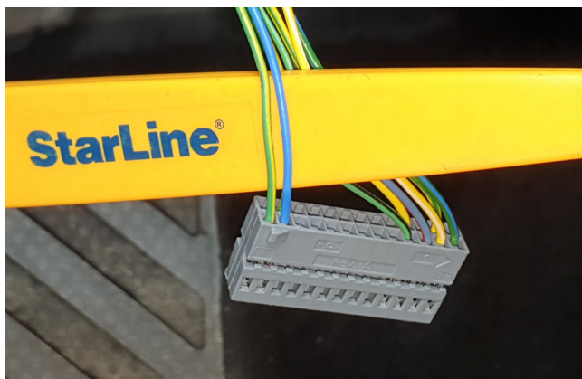
Фото 3.12. Провода штатной антенны на кнопке Старт-Стоп (зелёно-жёлтый и синий)
