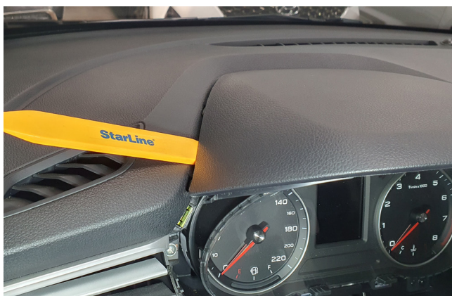
Фото 1.17. Снять козырёк над панелью приборов
