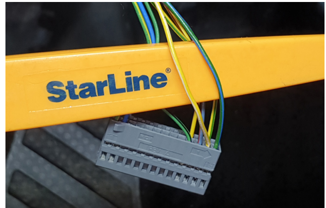
Фото 3.5. Шина CAN-B (жёлто-белый и зелёно-синий)
