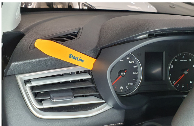
Фото 1.14. Снять накладку панели приборов
