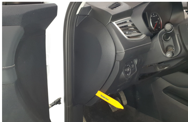
Фото 1.2. Снять левую боковую накладку передней панели
