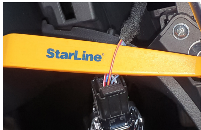
Фото 3.9. Управление кнопкой Старт-Стоп (красно-жёлтый)
