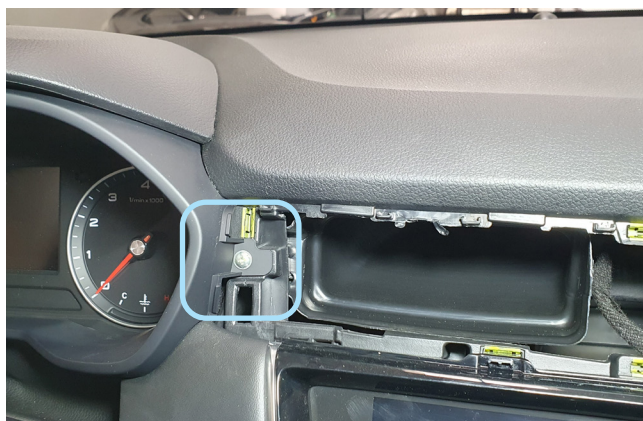
Фото 1.13. Накладка снята. Саморез
