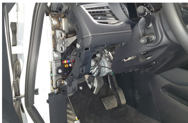
Фото 1.6. Пластиковая накладка под рулевой колонкой снята
