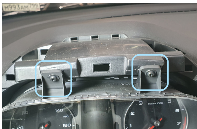
Фото 1.18. Саморезы крепления панели приборов сверху
