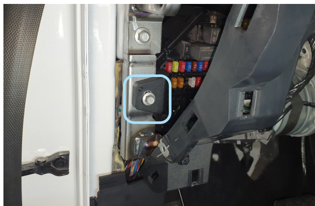
Фото 1.8. Болт крепления монтажного блока предохранителей слева
