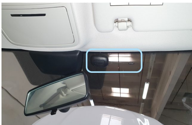
Фото 2.1. Возможное место установки антенного модуля
