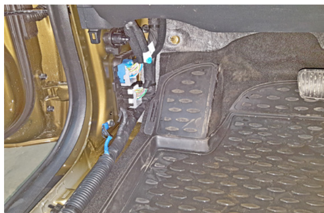
Фото 1.4. Накладка левой кик-панели снята
