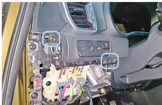
Фото 1.9. Крепление блока кнопок
