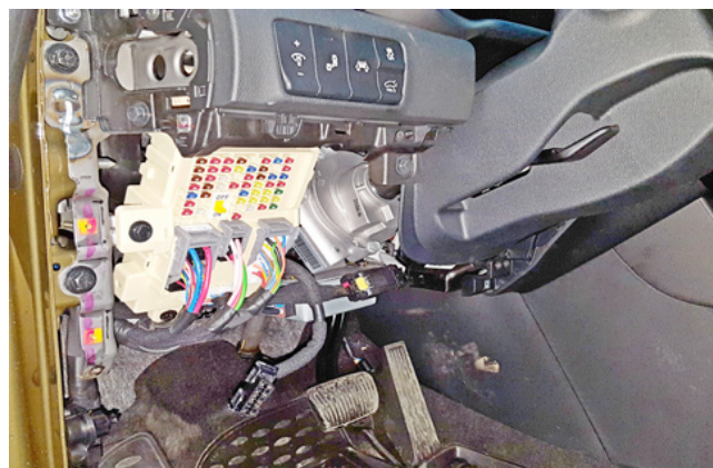
Фото 1.8. Пластиковая накладка под рулевой колонкой снята
