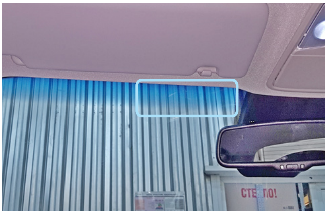
Фото 2.1. Возможное место установки антенного модуля
