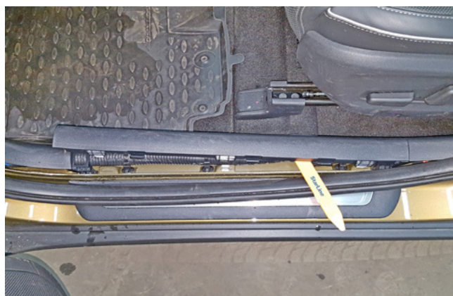
Фото 1.3. Снять накладку порога двери водителя
