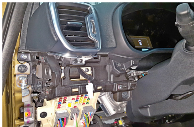
Фото 1.10. Блок кнопок снят
