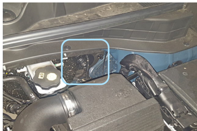
Фото 2.7. Штатный уплотнитель. Вид со стороны капота
