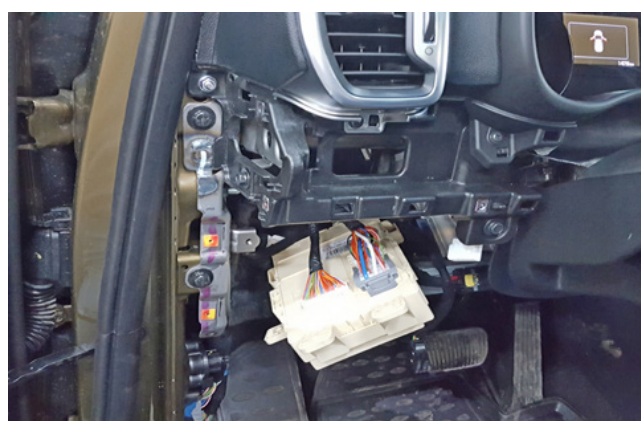
Фото 1.12. Монтажный блок предохранителей снят
