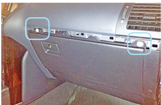
Фото 1.31. Саморезы крепления перчаточного ящика сверху
