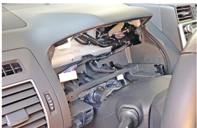
Фото 1.21. Панель приборов снята
