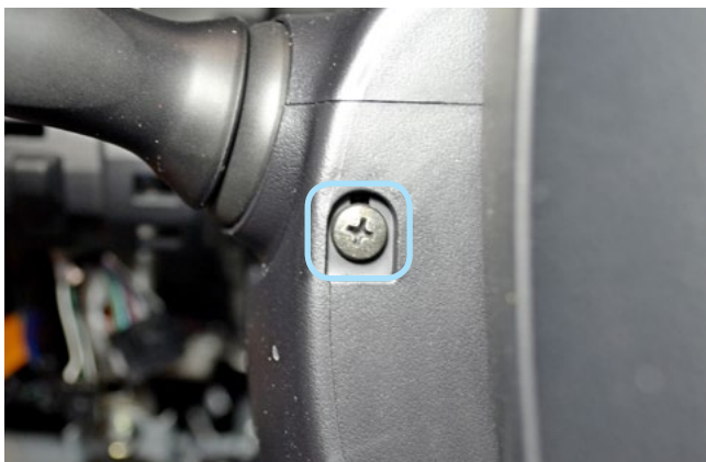
Фото 1.22. Саморезы крепления кожуха рулевого вала слева
