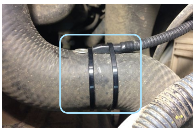
Фото 2.6. Крепление датчика температуры двигателя
