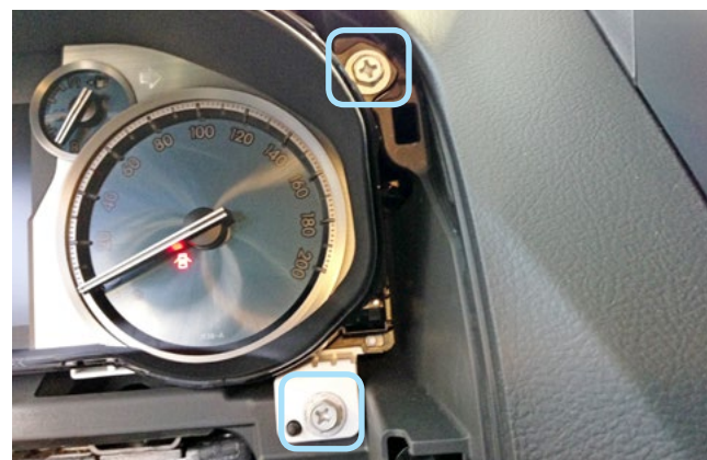
Фото 1.20. Саморезы крепления панели приборов справа
