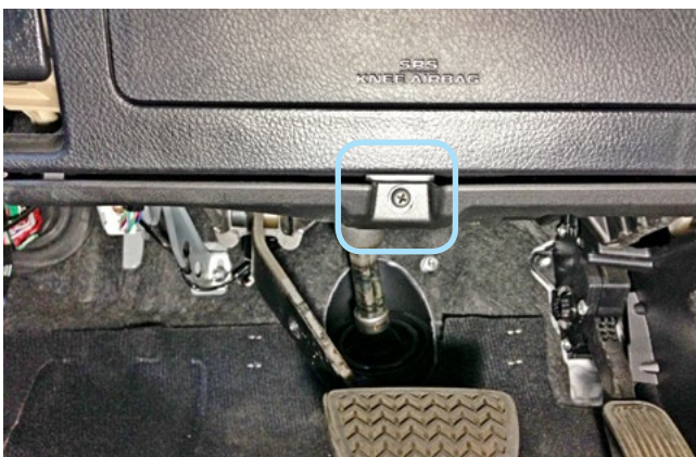
Фото 1.9. Саморез крепления накладки педального узла
