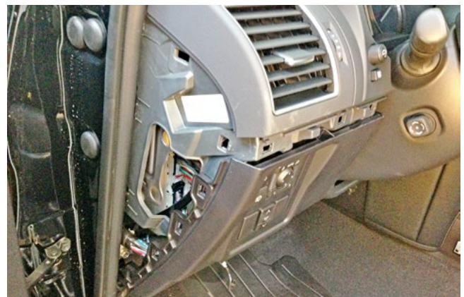
Фото 1.8. Боковая и декоративная накладки передней панели сняты
