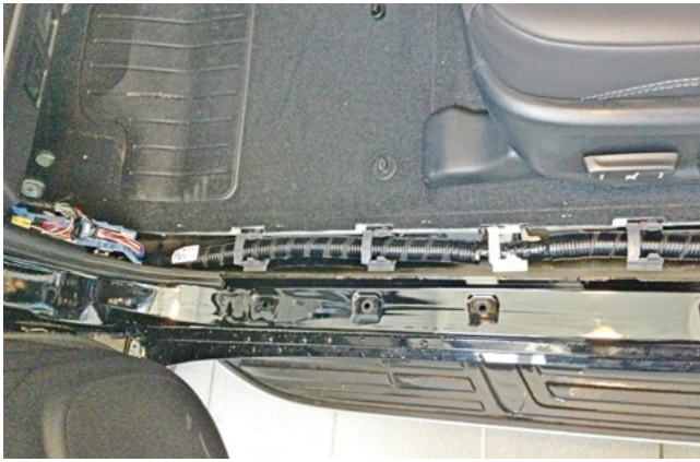
Фото 1.5. Накладки порога двери водителя и кик-панели сняты
