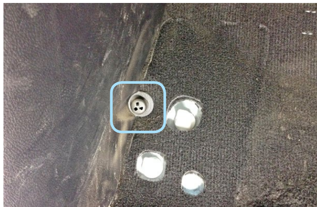
Фото 1.4. Площадка для ноги водителя снята. Клипса крепления накладки левой кик-панели
