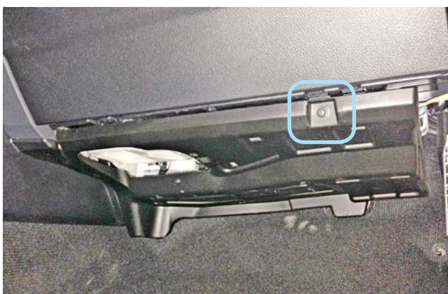
Фото 1.25. Саморез крепления нижней накладки перчаточного ящика
