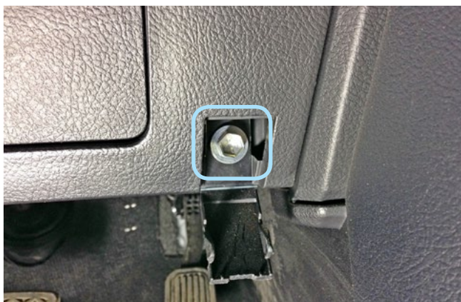
Фото 1.11. Болт крепления накладки под рулевой колонкой справа
