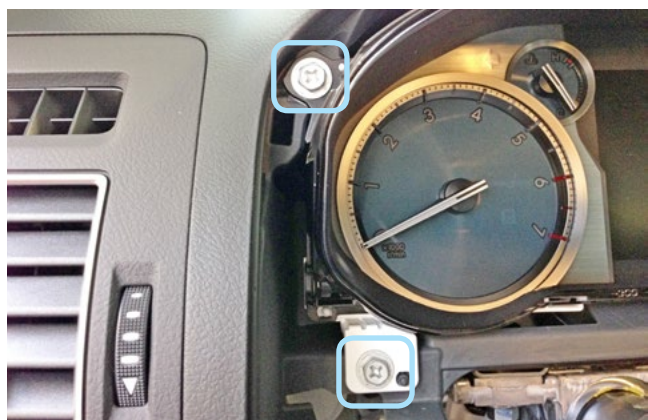
Фото 1.19. Саморезы крепления панели приборов слева
