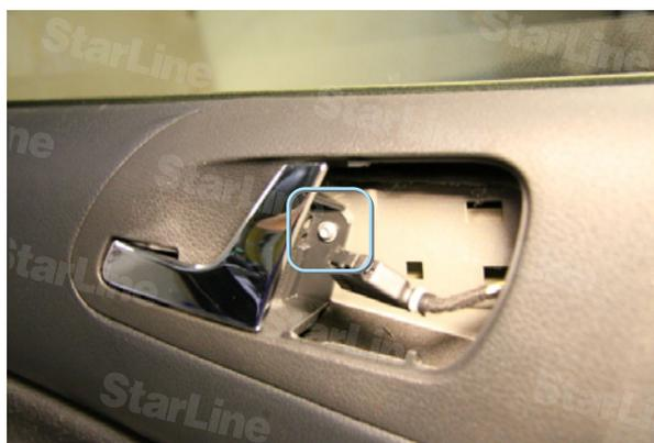
Фото 2.6. Саморез под регулировкой зеркал
