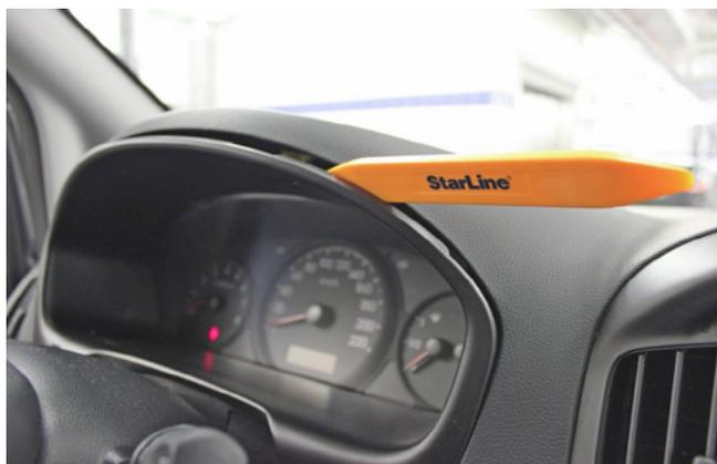
Фото 1.9. Снять декоративную накладку
