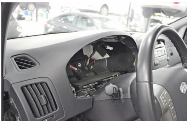
Фото 1.11. Панель приборов снята
