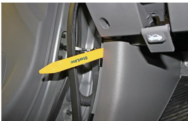
Фото 1.5. Снять накладку левой кик-панели
