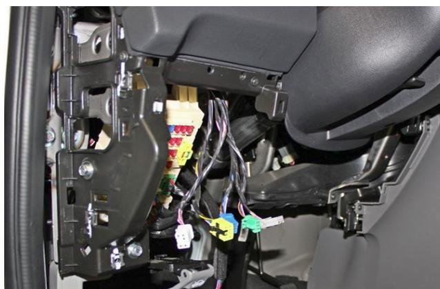
Фото 1.6. Пластиковая накладка под рулевой колонкой снята
