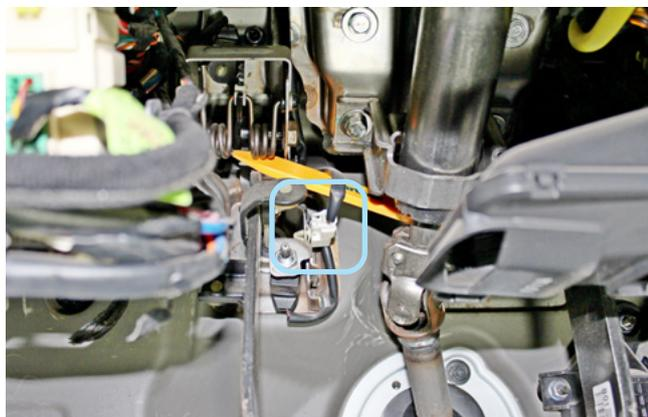
Фото 3.13. Местоположение разъёма концевика педали сцепления
