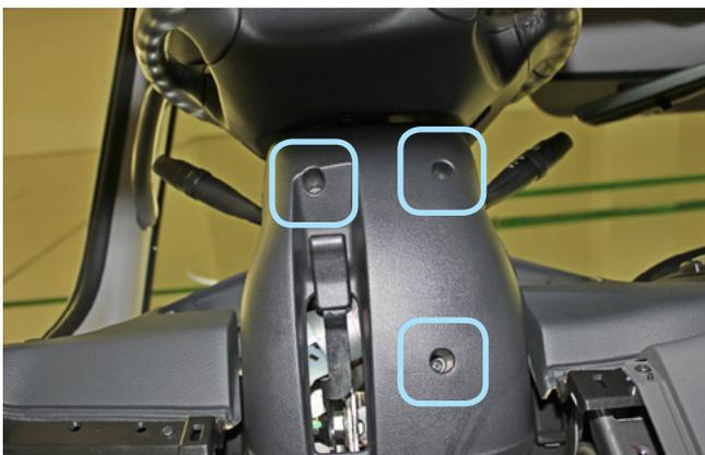
Фото 1.16. Саморезы крепления нижней части
