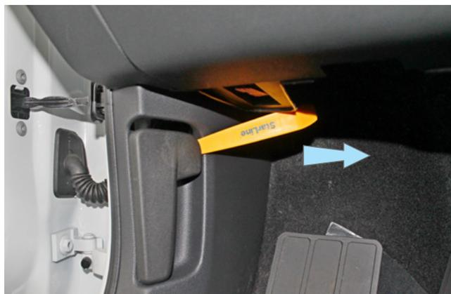
Фото 1.8. Сдвинуть фиксатор ручки отпирания капота в направлении стрелки
