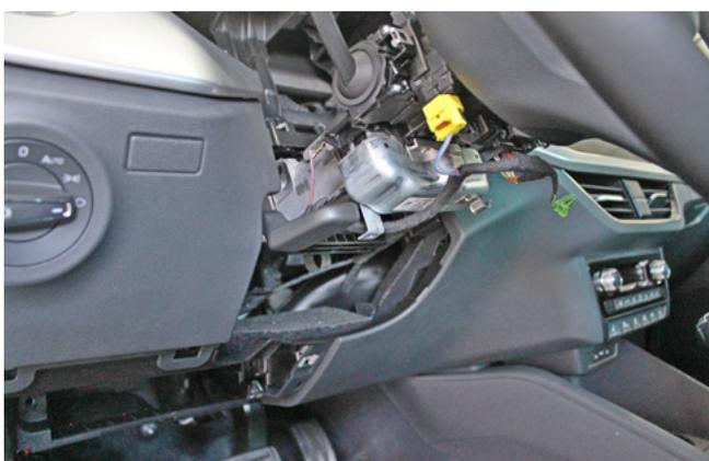
Фото 1.21. Кожух рулевого вала снят
