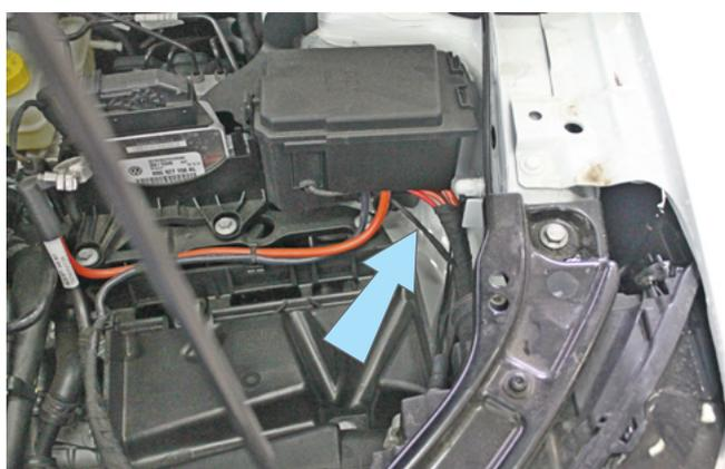
Фото 3.16. Местоположение жгута подкапотного блока предохранителей (аккумуляторная батарея снята)
