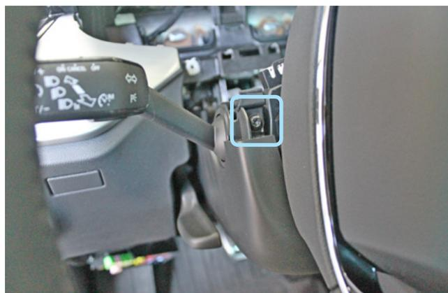
Фото 1.18. Винт крепления кожуха рулевого вала слева
