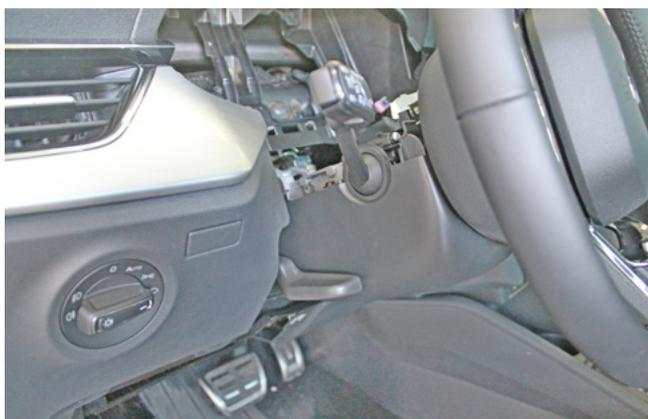
Фото 1.17. Нижняя часть кожуха рулевого вала. Общий вид
