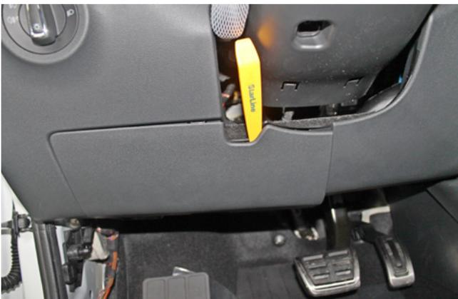
Фото 1.14. Снять пластиковую крышку блока предохранителей
