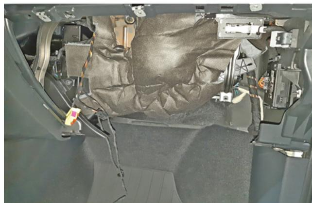
Фото 1.29. Перчаточный ящик снят
