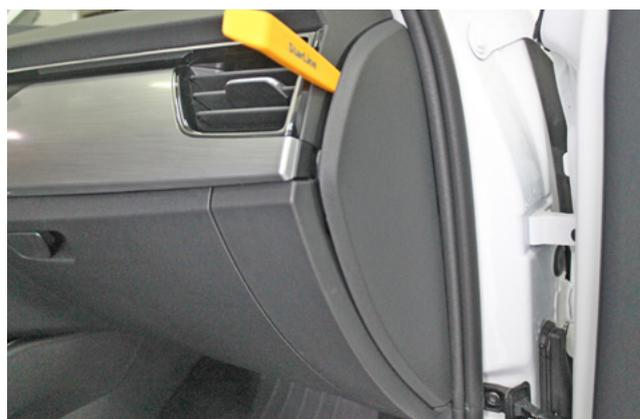
Фото 1.25. Снять правую боковую накладку передней панели
