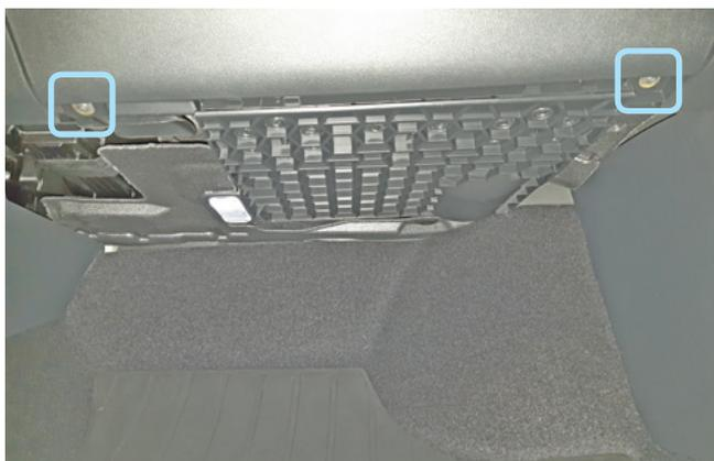
Фото 1.28. Саморезы крепления снизу перчаточного ящика
