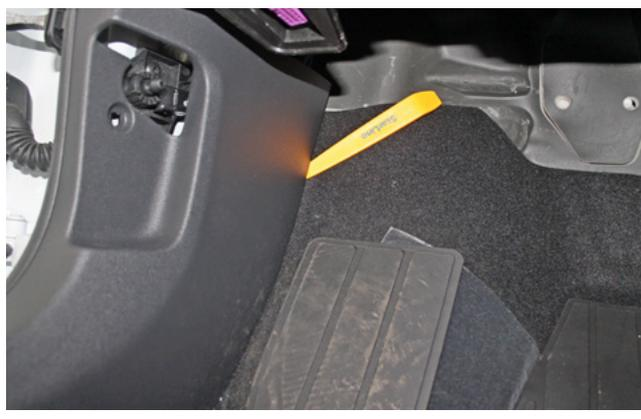
Фото 1.12. Снять пластиковую накладку левой кик-панели
