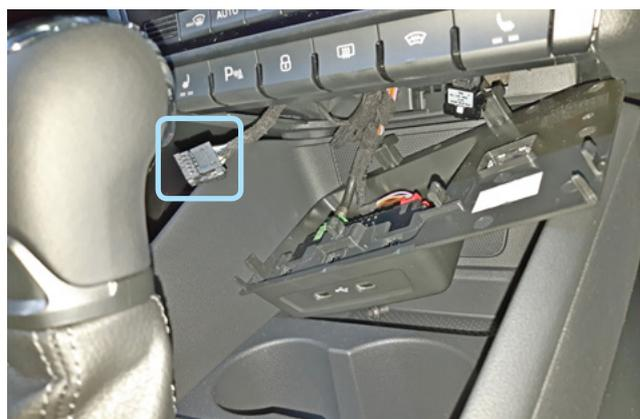
Фото 1.23. Панель снята. Разъём кнопки управления центральным замком
