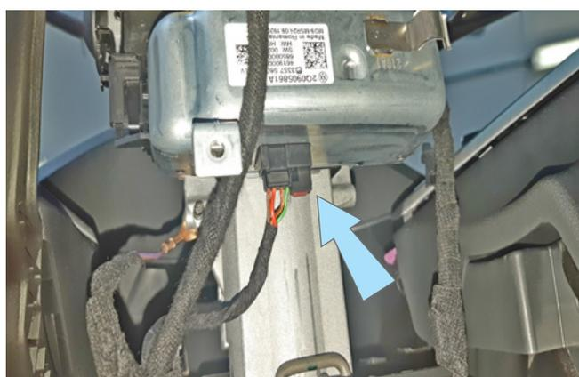
Фото 3.18. Местоположение разъёма блока управления
