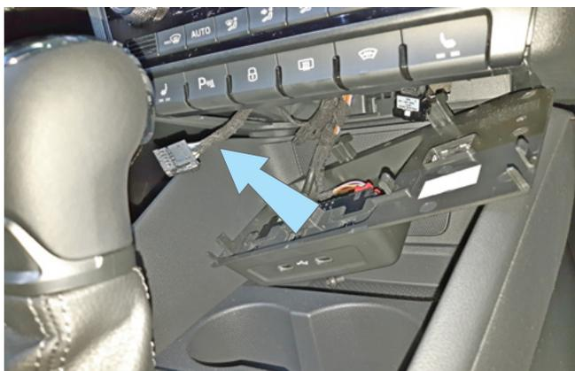
Фото 3.8. Местоположение разъёма кнопки
