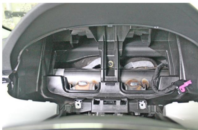
Фото 1.6. Панель приборов снята
