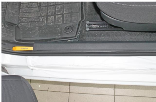
Фото 1.10. Частично снять пластиковую накладку порога двери водителя
