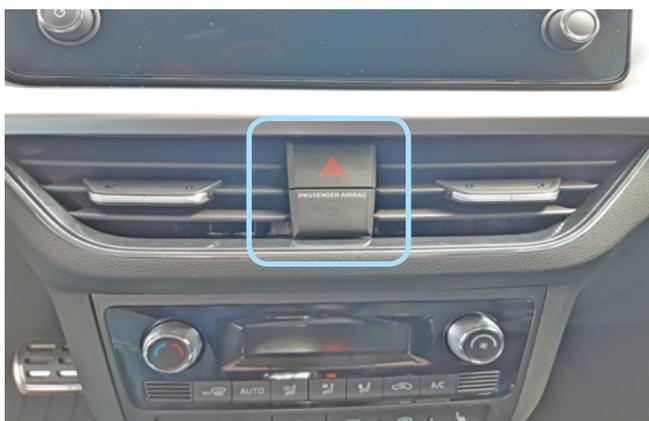
Фото 3.6. Местоположение кнопки аварийной сигнализации
