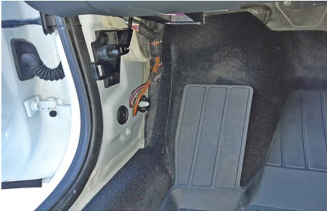
Фото 1.13. Пластиковая накладка левой кик-панели снята
