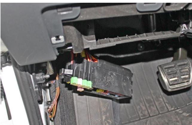
Фото 1.16. Блок предохранителей снят
