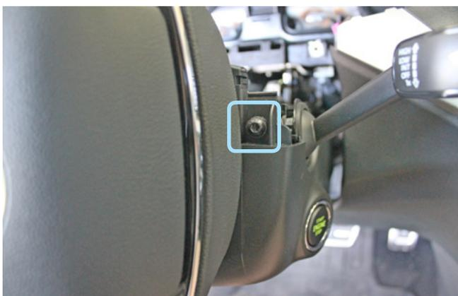
Фото 1.19. Винт крепления кожуха рулевого вала справа
