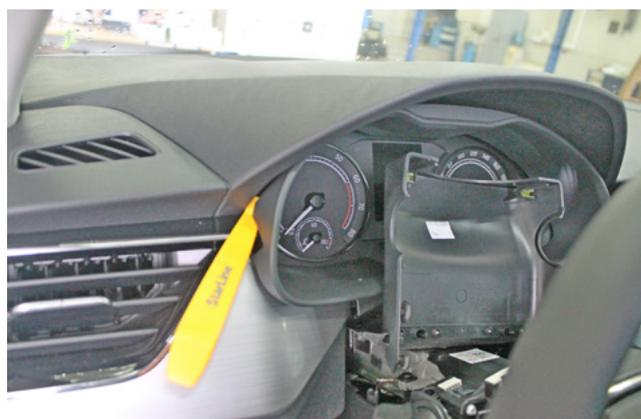
Фото 1.4. Снять декоративную накладку панели приборов
