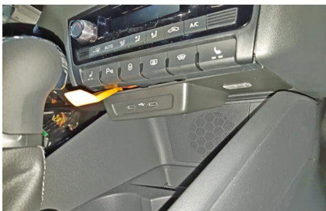
Фото 1.22. Снять пластиковую панель с разъёмами USB
