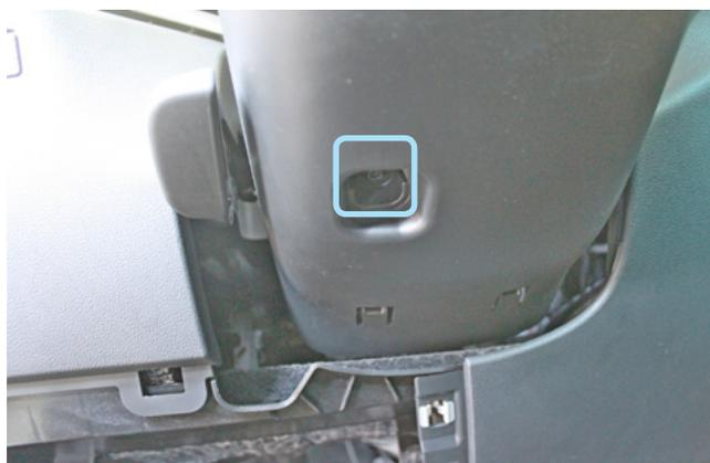
Фото 1.20. Винт крепления кожуха рулевого вала снизу
