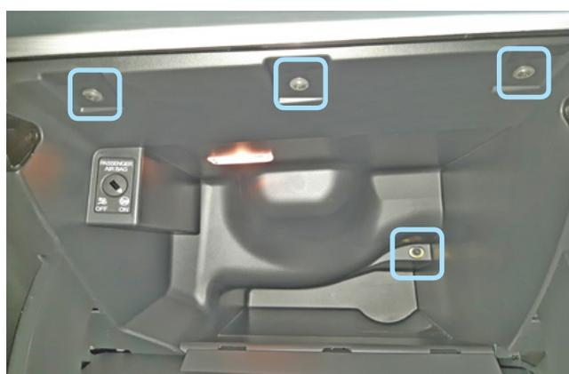
Фото 1.27. Саморезы крепления внутри перчаточного ящика
