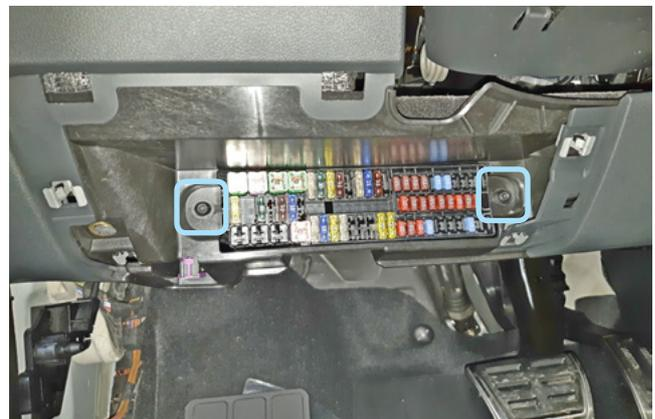
Фото 1.15. Крышка снята. Винты крепления
