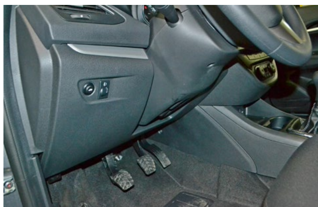
Фото 1.4. Пластиковая накладка под рулевой колонкой. Общий вид
