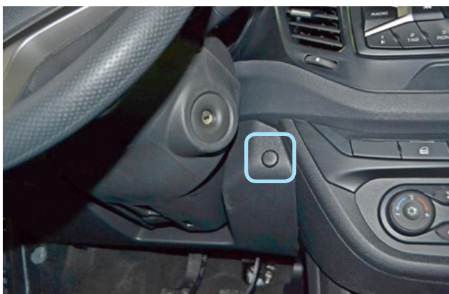
Фото 1.5. Клипса крепления пластиковой накладки под рулевой колонкой
