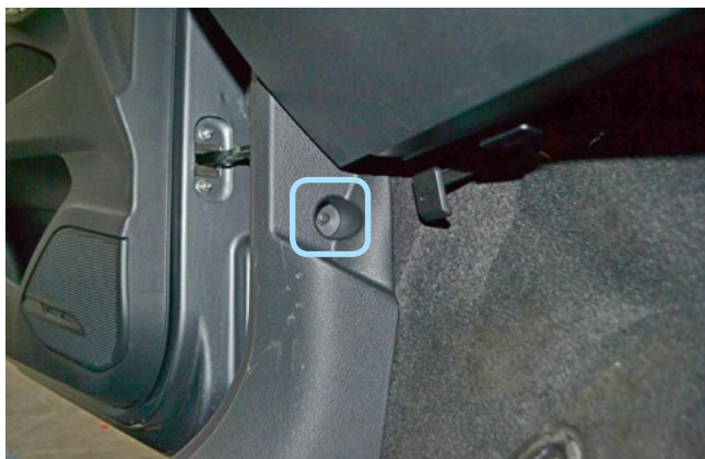
Фото 1.1. Саморез крепления накладки порога двери водителя
