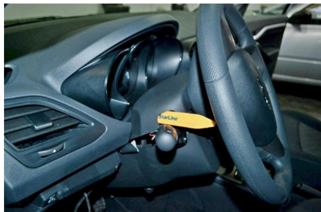
Фото 1.8. Снять верхнюю часть рулевого кожуха
