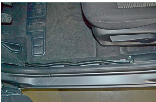
Фото 1.3. Накладка порога двери водителя снята
