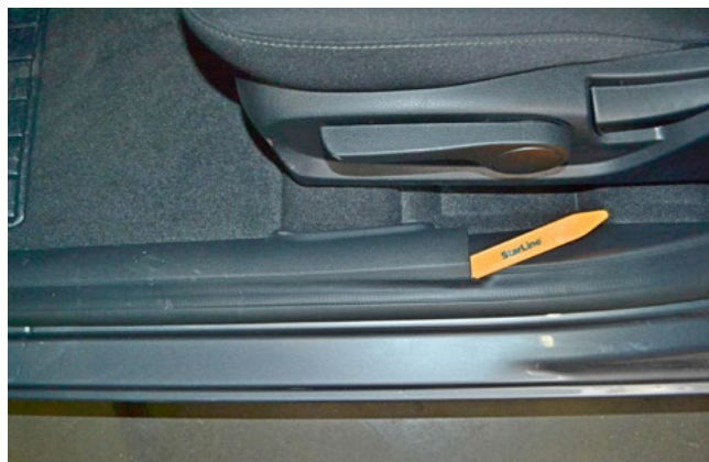
Фото 1.2. Снять пластиковую накладку порога двери водителя
