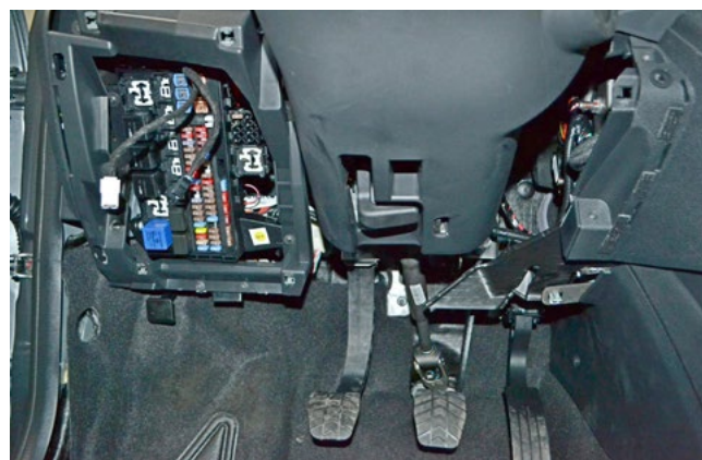
Фото 1.6. Пластиковая накладка под рулевой колонкой снята
