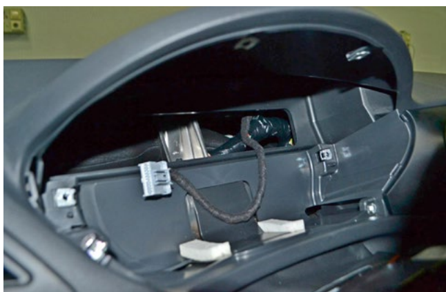
Фото 1.13. Панель приборов снята
