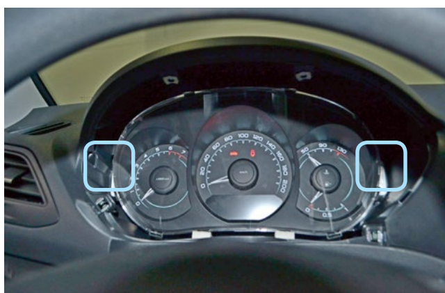
Фото 1.12. Декоративная накладка снята. Саморезы крепления панели приборов
