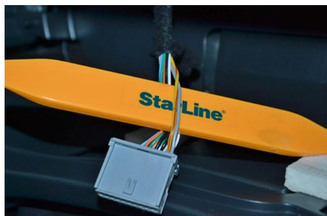
Фото 3.4. Шина CAN-A (жёлто-красный и серый)
