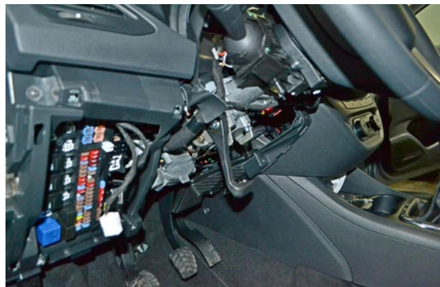
Фото 1.10. Кожух рулевого вала снят
