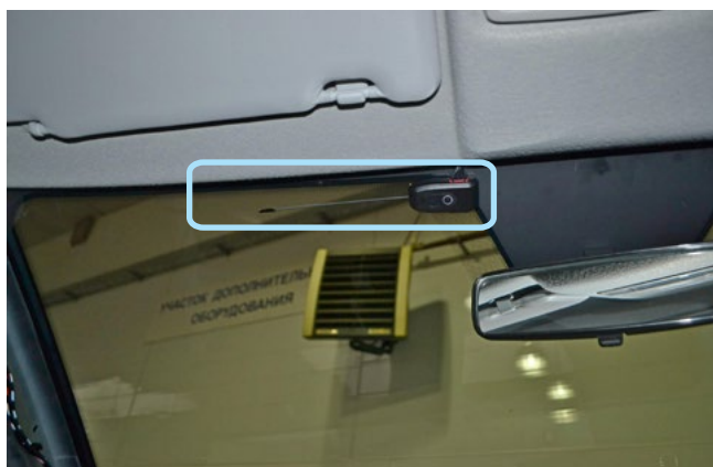
Фото 2.6. Возможное место установки антенного модуля
