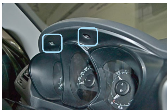
Фото 1.11. Саморезы крепления декоративной накладки панели приборов
