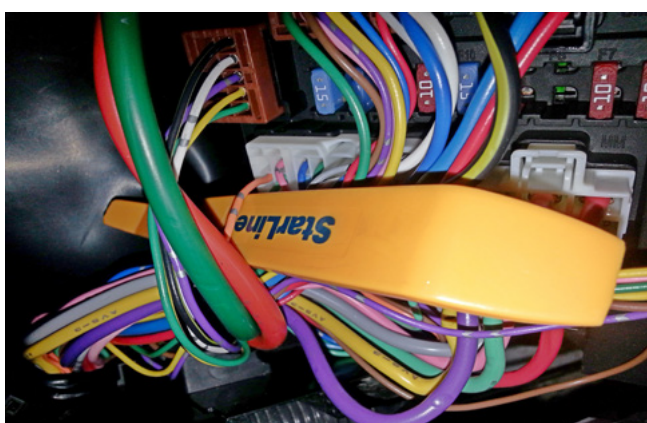
Фото 2.11. Подключение цепи зажигания (оранжевый)
