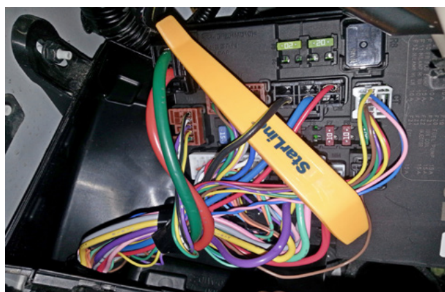
Фото 2.10. Подключение массы (чёрно-жёлтый)
