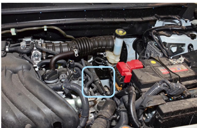
Фото 2.3. Место установки датчика температуры двигателя
