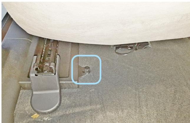
Фото 1.2. Клипса крепления накладки порога двери водителя
