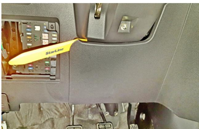
Фото 1.9. Снять пластиковую накладку под рулевой колонкой
