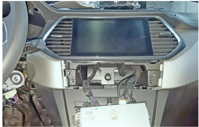
Фото 1.26. Мультимедийное устройство снято
