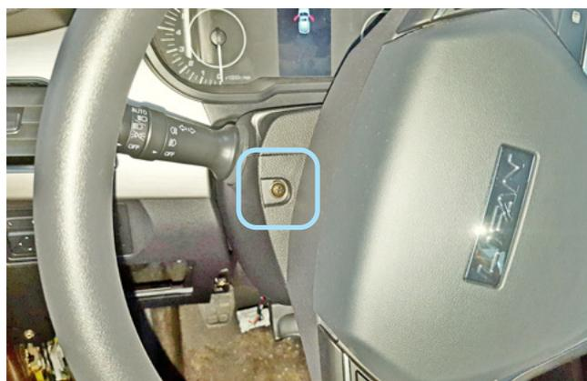
Фото 1.12. Саморез крепления кожаной обивки слева
