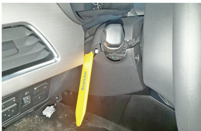
Фото 1.15. Снять нижнюю часть кожуха рулевого вала
