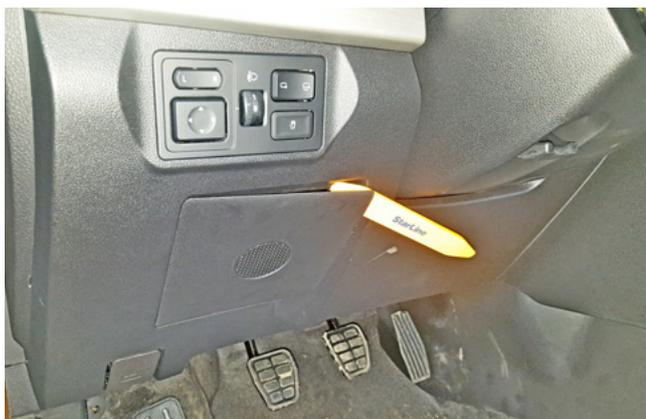
Фото 1.7. Снять крышку монтажного блока предохранителей
