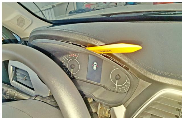
Фото 1.20. Снять накладку панели приборов
