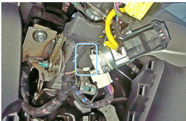
Фото 3.8. Местоположение разъёма
