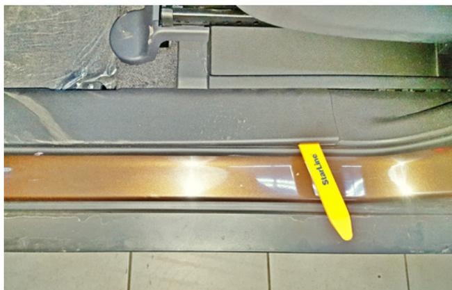
Фото 1.3. Снять накладку порога двери водителя
