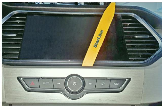
Фото 1.24. Снять декоративную накладку
