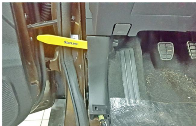
Фото 1.5. Снять накладку левой кик-панели
