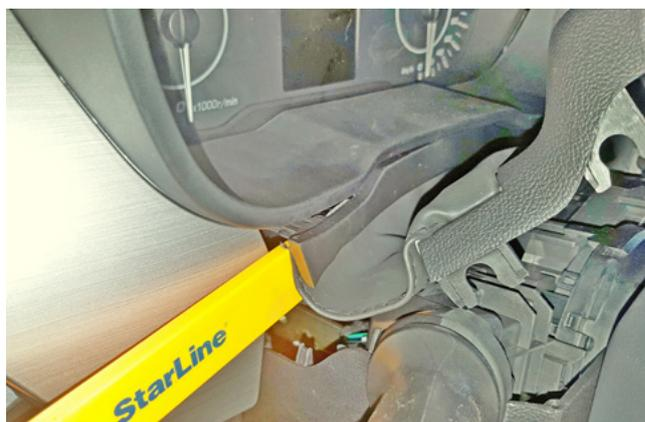
Фото 1.18. Снять нижнюю декоративную накладку панели приборов
