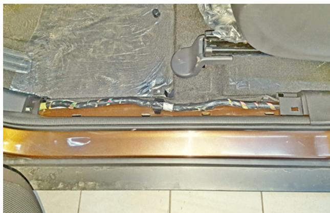
Фото 1.4. Накладка порога двери водителя снята
