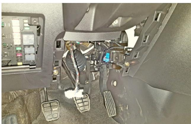
Фото 1.10. Пластиковая накладка под рулевой колонкой снята
