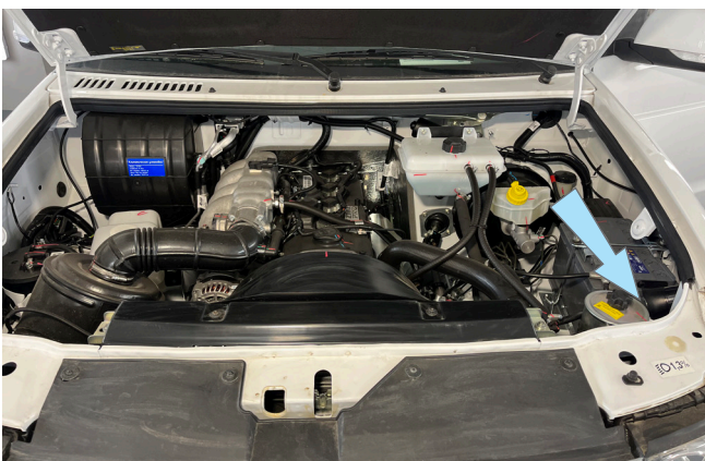
Фото 2.7. Место расположения жгута штатного концевика капота
