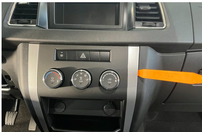
Фото 1.13. Блок климатической установки (крепления на защелках)
