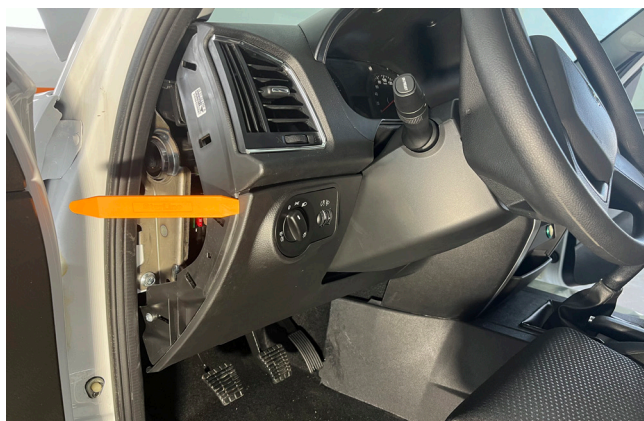
Фото 1.3. Боковая накладка снята. Снять пластиковую накладку под рулевой колонкой
