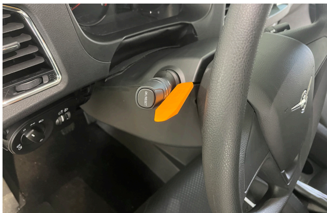
Фото 1.7. Снять кожух рулевого вала
