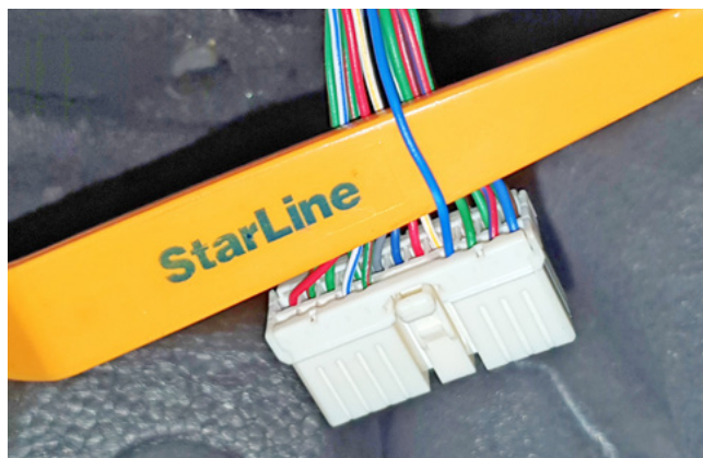
Фото 3.5. Управление штатной сиреной (синий)
