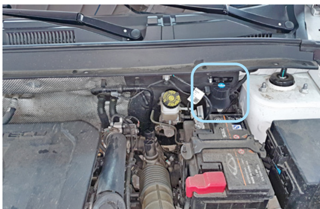
Фото 2.2. Возможное место установки сирены
