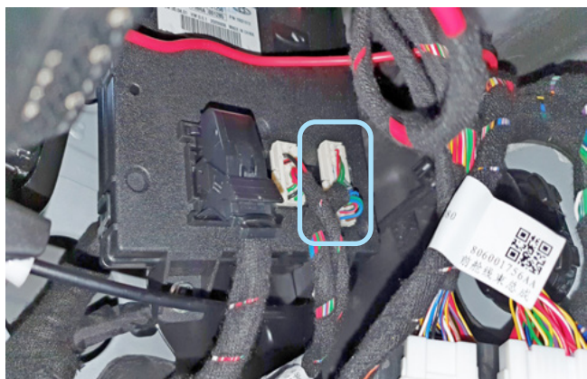
Фото 3.4. Местоположение разъёма на блоке BCM
