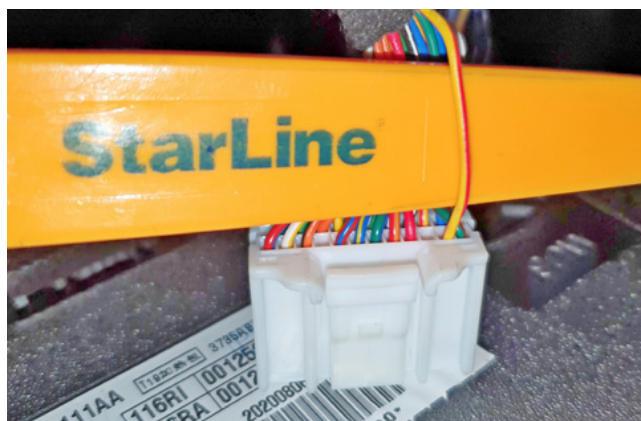
Фото 3.10. Управление световыми сигналами (жёлто-красный)
