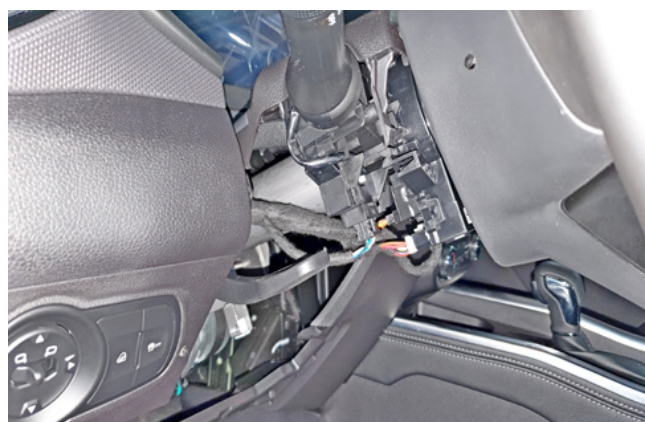
Фото 1.15. Нижняя часть кожуха рулевого вала снята
