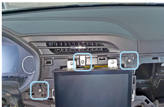
Фото 1.20. Саморезы крепления накладки панели приборов
