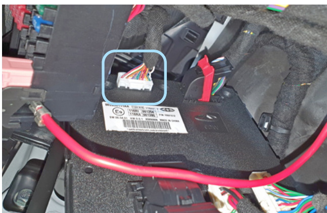
Фото 3.9. Местоположение разъёма на блоке BCM
