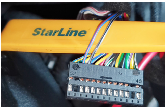
Фото 3.8. Управление центральным замком (серо-чёрный и сине-красный)
