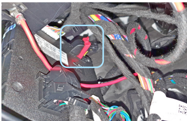
Фото 3.6. Местоположение разъёма на блоке BCM
