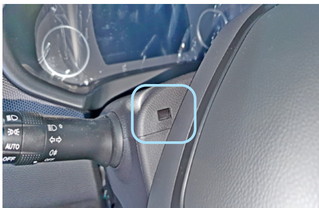
Фото 1.12. Защёлка крепления нижней части кожуха рулевого вала слева
