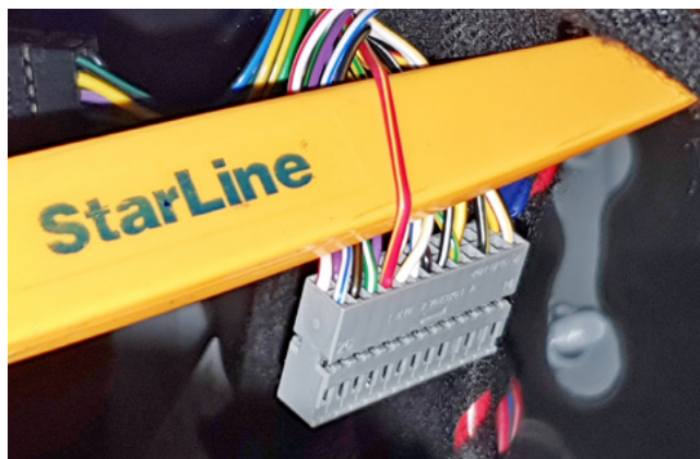
Фото 3.7. Имитация открытия двери водителя (красно-жёлтый)
