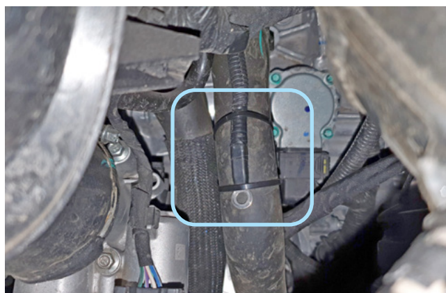
Фото 2.5. Крепление датчика температуры двигателя
