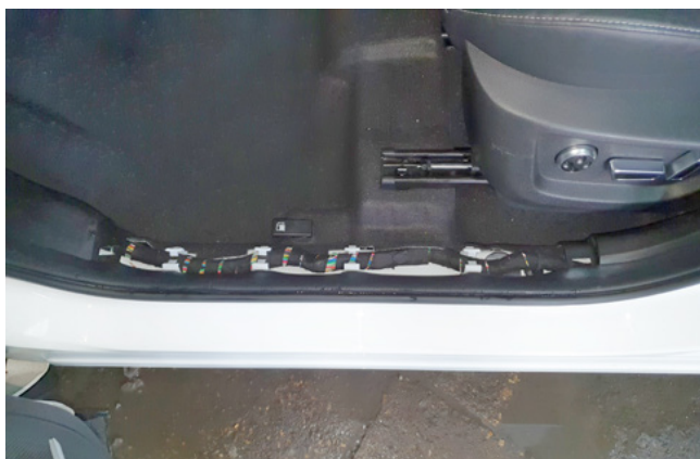
Фото 1.7. Накладка порога двери водителя снята
