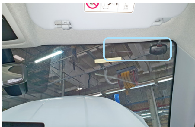
Фото 2.1. Возможное место установки антенного модуля
