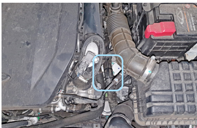
Фото 2.4. Место установки датчика температуры двигателя
