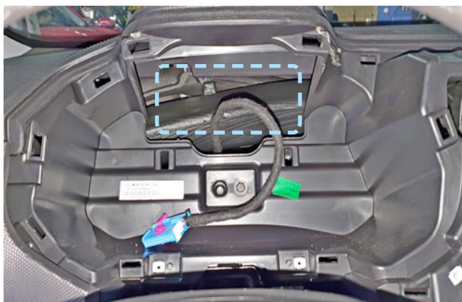
Фото 2.7. Пример расположения центрального блока охранно-телематического комплекса
