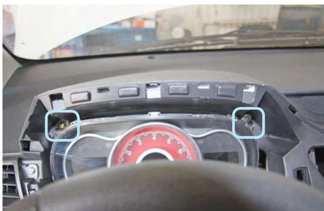
Фото 1.3. Саморезы крепления панели приборов
