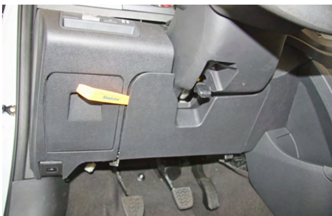
Фото 1.5. Снять пластиковую накладку
