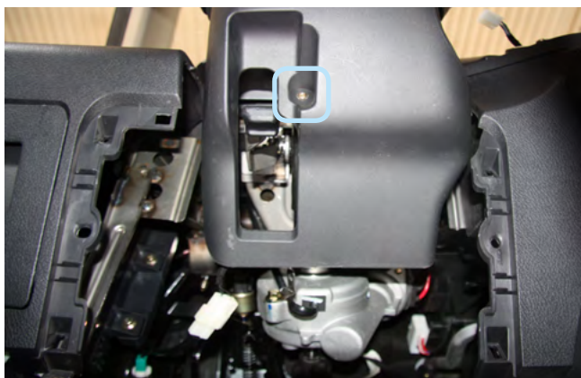
Фото 1.9. Саморез крепления кожуха рулевого вала снизу
