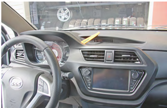
Фото 1.1. Снять декоративную накладку панели
