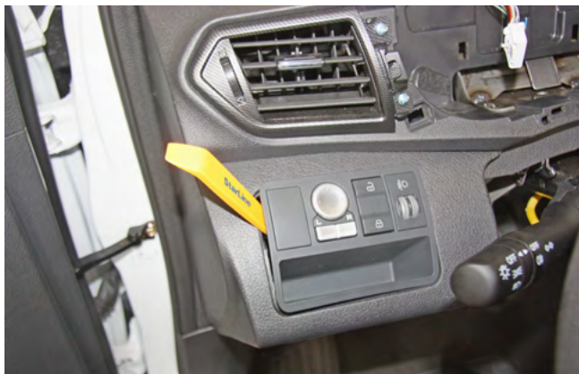
Фото 1.12. Снять панель с кнопкой управления центральным замком
