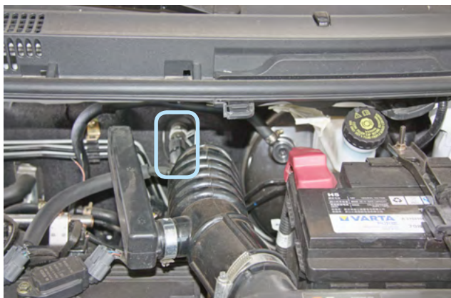
Фото 2.5. Место установки датчика температуры двигателя
