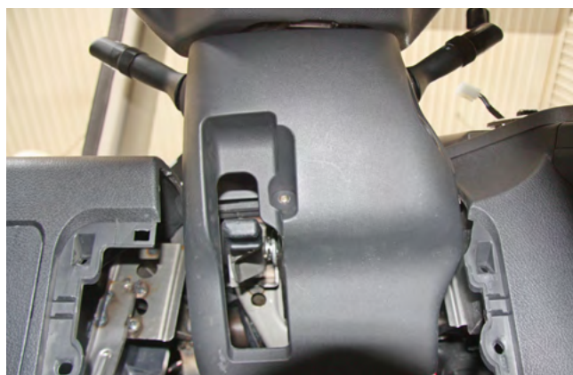
Фото 1.6. Пластиковая накладка снята
