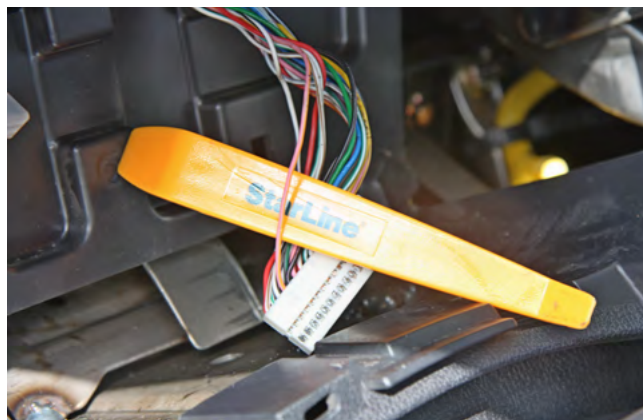
Фото 3.5. Концевик капота (розово-жёлтый)
