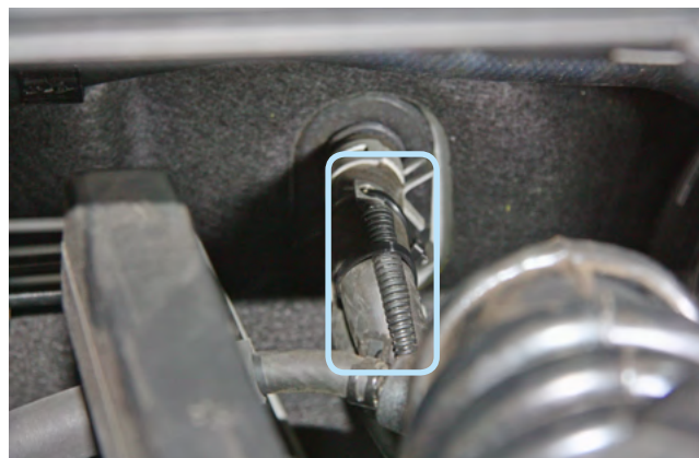
Фото 2.6. Крепление датчика температуры двигателя
