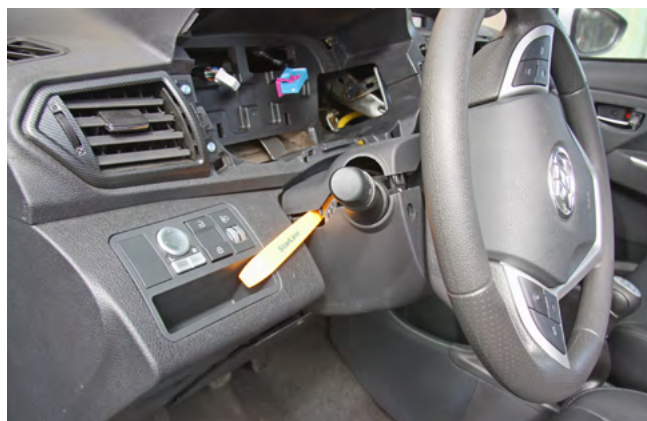
Фото 1.10. Снять верхнюю часть кожуха рулевого вала
