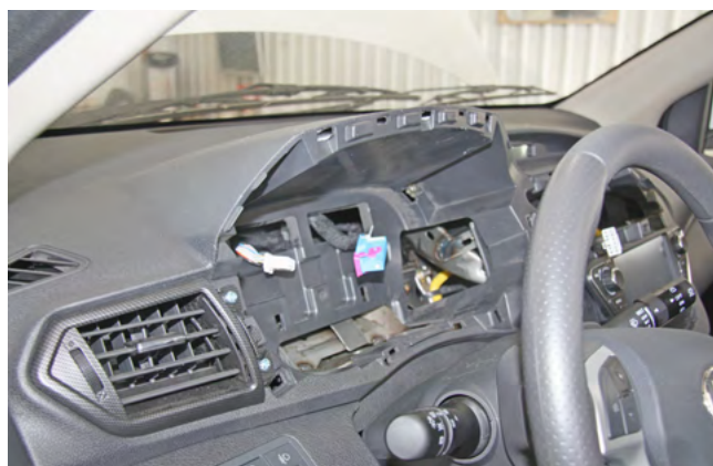
Фото 1.4. Панель приборов снята
