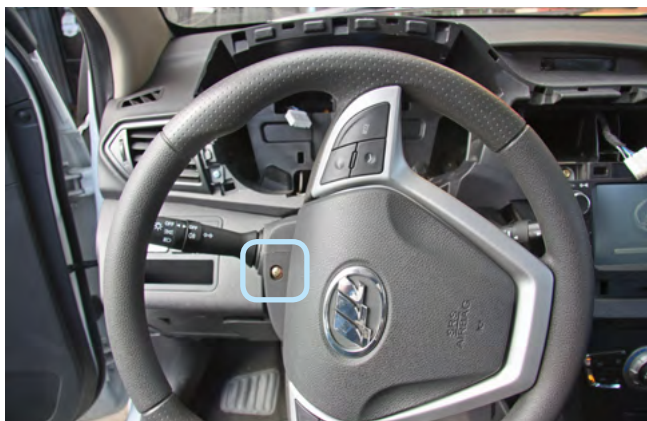
Фото 1.7. Саморез крепления кожуха рулевого вала слева
