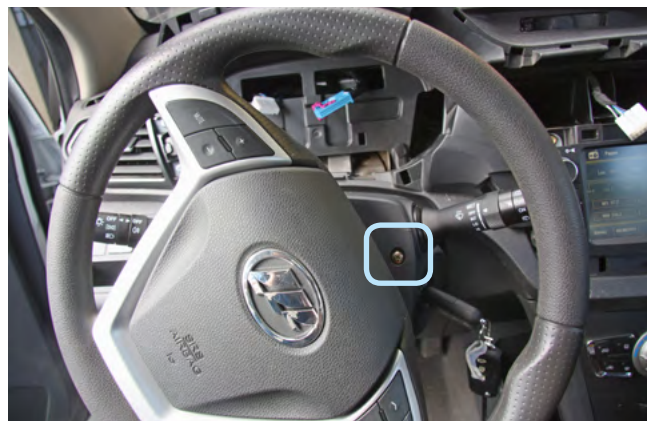
Фото 1.8. Саморез крепления кожуха рулевого вала справа
