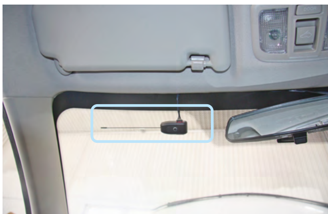
Фото 2.1. Возможное место установки антенного модуля
