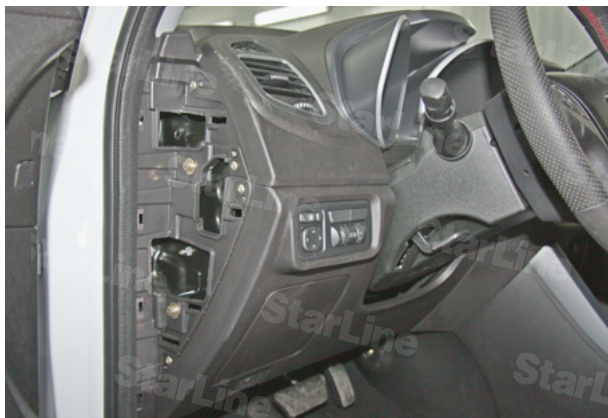
Фото 1.7. Левая боковая накладка снята
