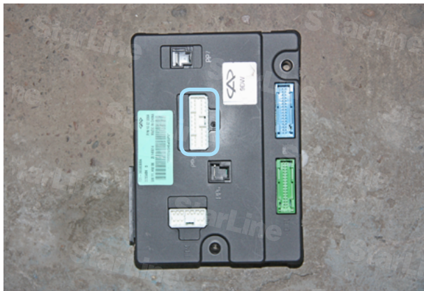
Фото 8.1. Местоположение разъёма PP3 на блоке BCM
