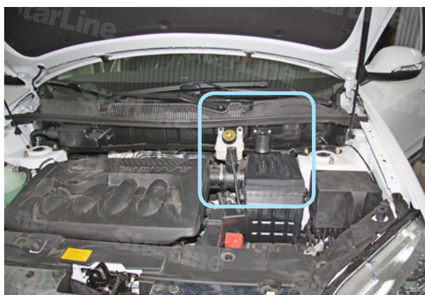
Фото 4.1. Возможное место установки сирены
