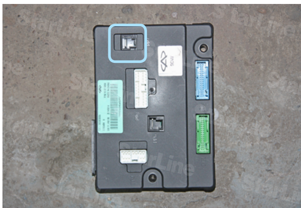
Фото 13.1. Местоположение разъёма PP7 блоке BCM
