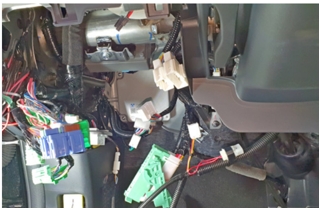
Фото 1.5. Монтажный блок предохранителей снят
