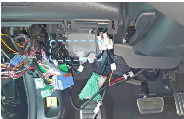
Фото 2.8. Пример расположения центрального блока охранно-телематического комплекса
