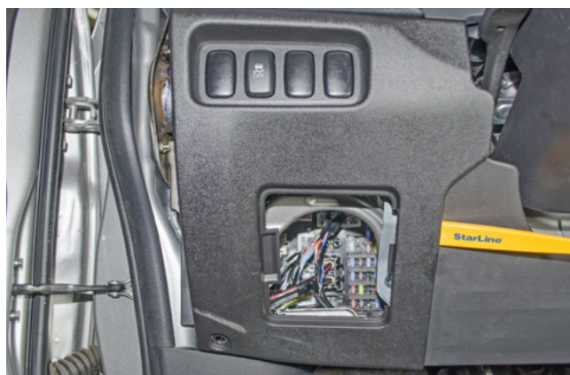
Фото 1.4. Снять левую накладку
