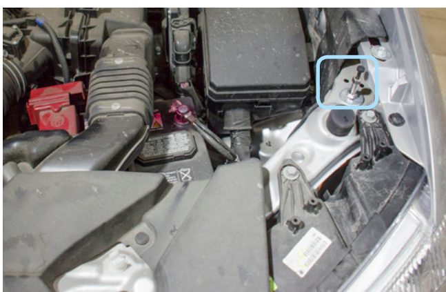
Фото 2.7. Возможное место установки концевика капота
