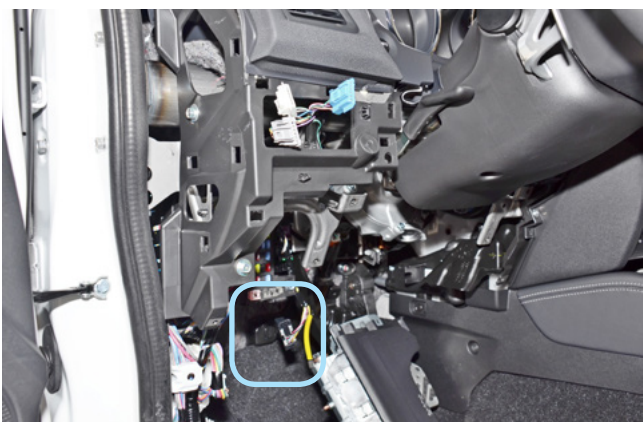
Фото 3.4. Местоположение диагностического разъёма
