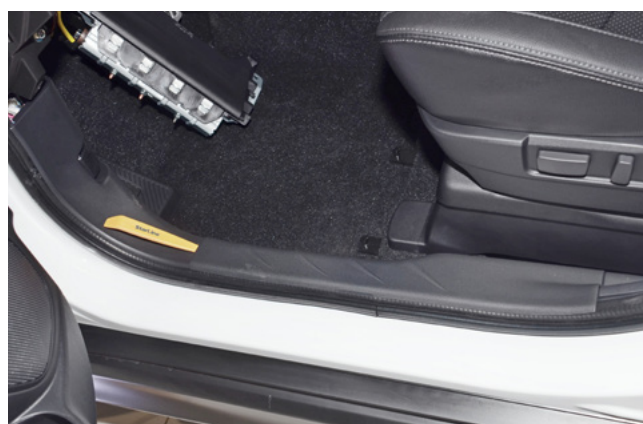
Фото 1.8. Снять накладку порога двери водителя
