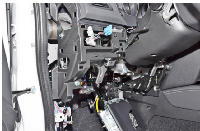
Фото 1.10. Пластиковая накладка под рулевой колонкой снята
