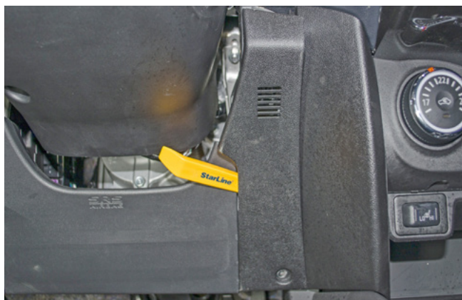
Фото 1.5. Снять правую накладку
