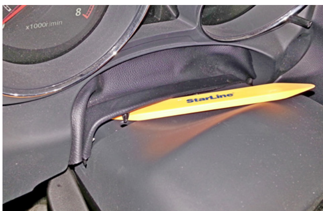
Фото 1.11. Снять пылезащитный кожух рулевой колонки
