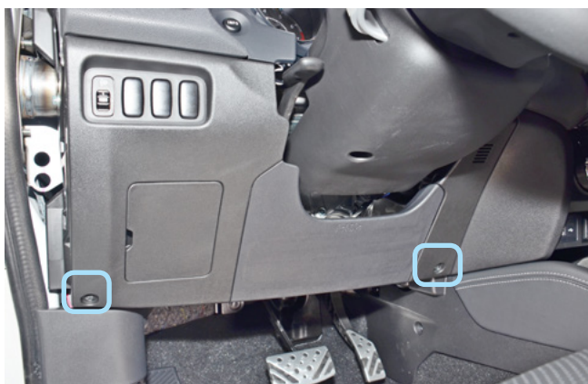
Фото 1.3. Саморезы крепления накладки
