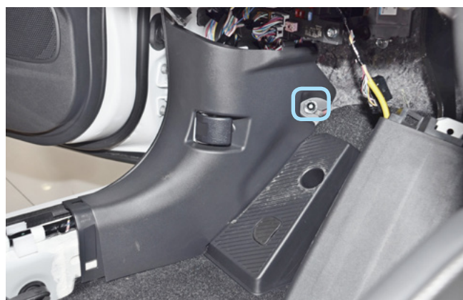
Фото 1.9. Крепление накладки левой кик-панели
