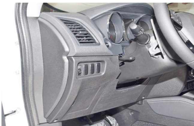
Фото 1.1. Пластиковая накладка под рулевой колонкой. Общий вид
