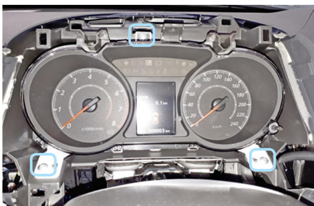
Фото 1.13. Саморезы крепления панели приборов
