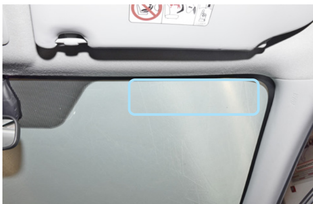
Фото 2.1. Возможное место установки антенного модуля
