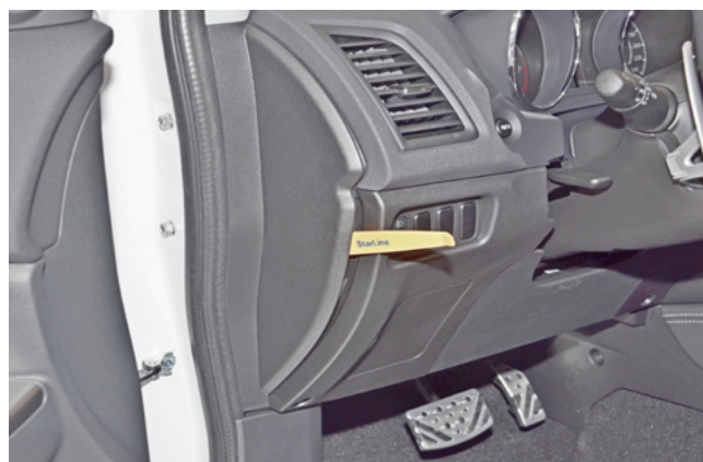
Фото 1.2. Снять левую накладку передней панели
