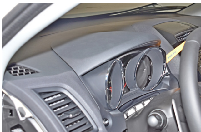
Фото 1.12. Снять декоративную накладку панели приборов
