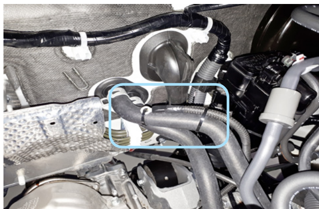
Фото 2.6. Крепление датчика температуры двигателя
