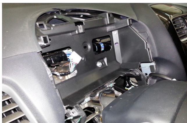
Фото 1.14. Панель приборов снята
