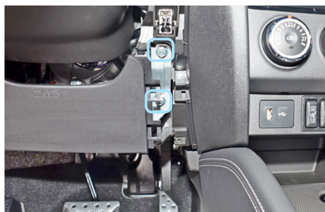
Фото 1.7. Болты крепления airbag
