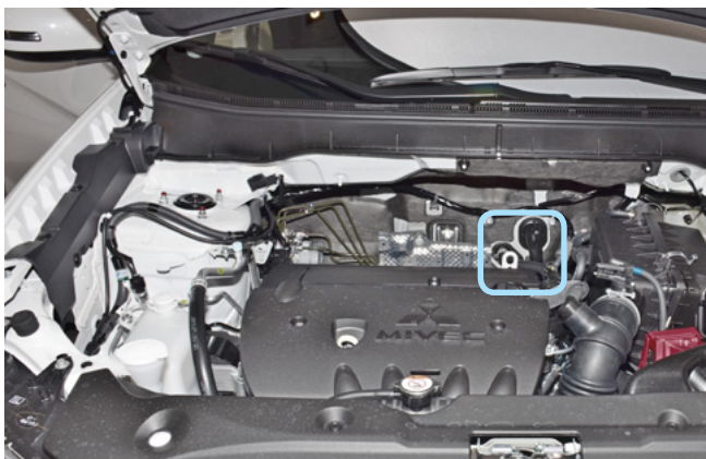
Фото 2.5. Место установки датчика температуры двигателя
