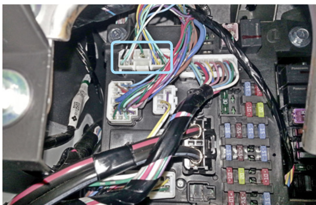
Фото 3.12. Местоположение разъёма C-417
