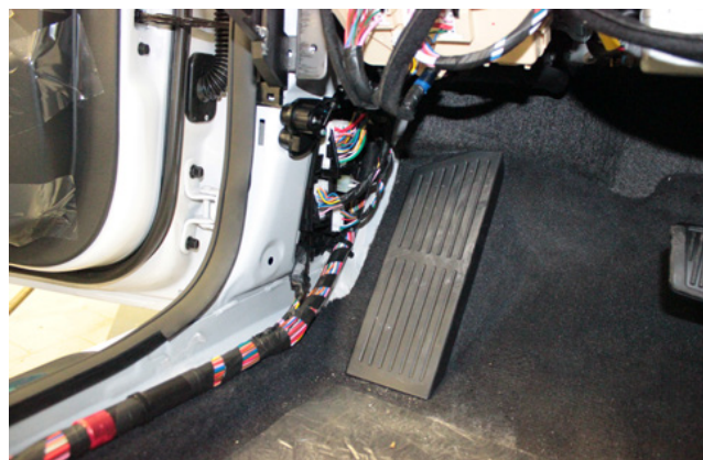
Фото 1.12. Накладка левой кик-панели снята
