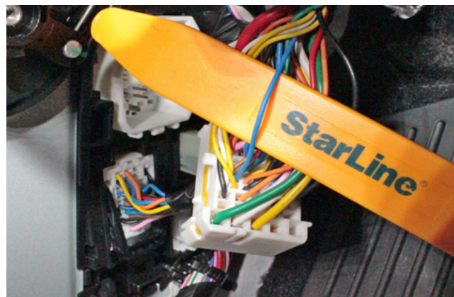
Фото 3.7. Шина данных штатного иммобилайзера (синий)
