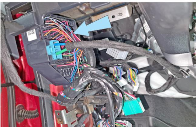
Фото 3.7. Местоположение блока предохранителей
