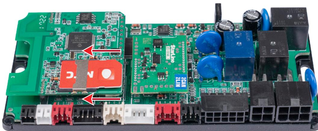
1.3. Установить плату в корпус и завернуть четыре винта.
