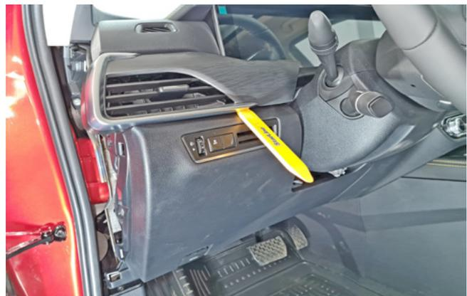
Фото 1.4. Снять левый воздуховод
