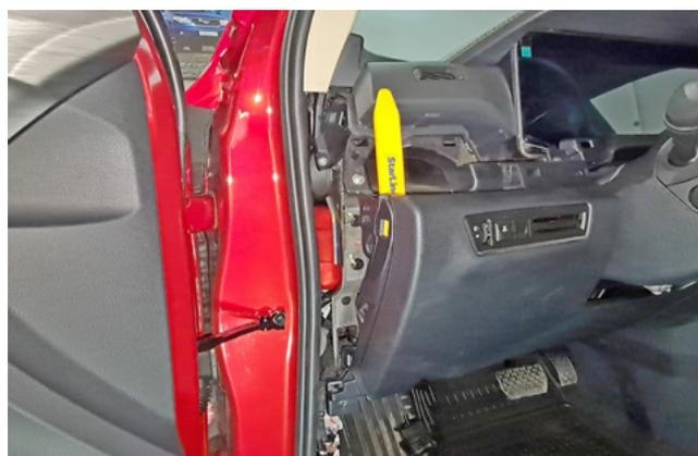
Фото 1.12. Снять пластиковую накладку под рулевой колонкой
