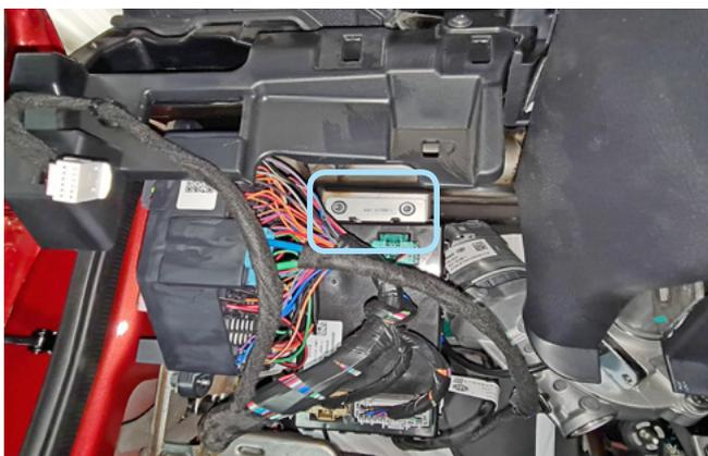
Фото 1.14. Гайки крепления блока PEPS
