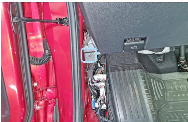
Фото 1.9. Накладка снята. Саморез
