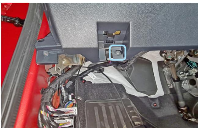
Фото 1.11. Ручка отпирания капота снята. Саморез
