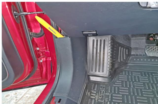
Фото 1.8. Снять накладку левой кик-панели
