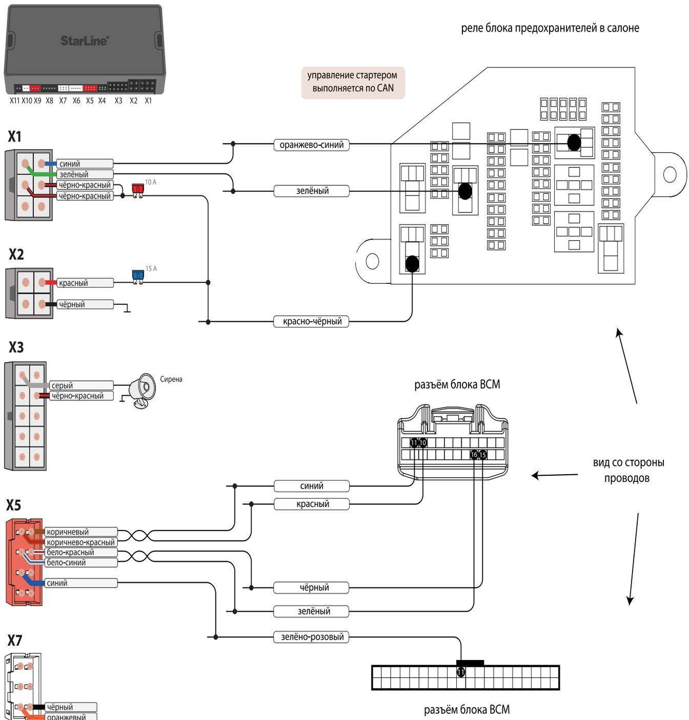
Схема 1. Общая схема подключения
