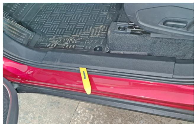
Фото 1.6. Снять накладку порога двери водителя
