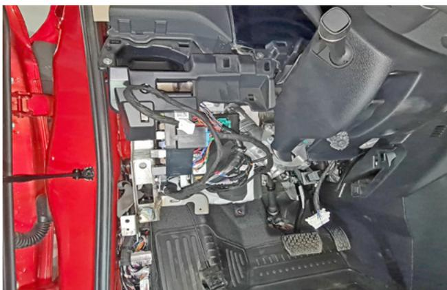
Фото 1.13. Пластиковая накладка под рулевой колонкой снята
