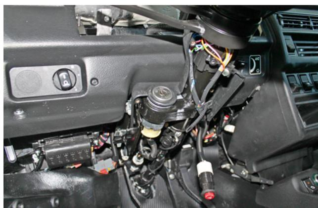
Фото 1.11. Нижняя часть кожуха рулевого вала снята
