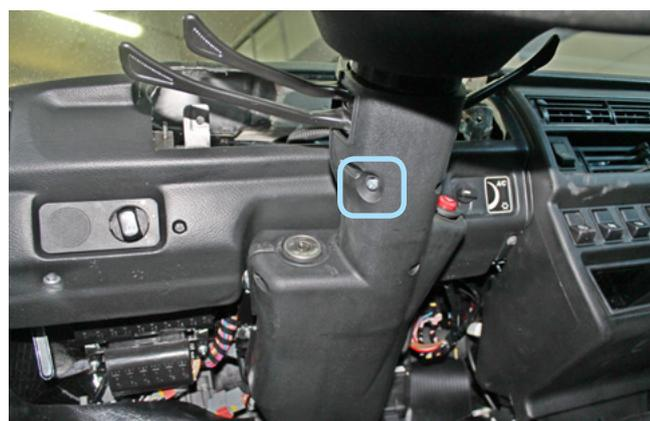
Фото 1.10. Саморез крепления нижней части кожуха
