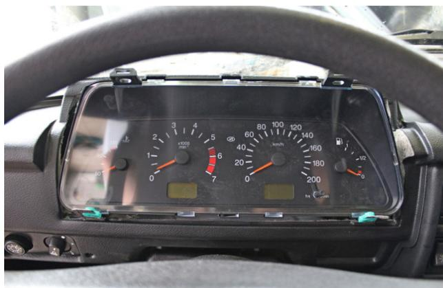
Фото 1.4. Накладка панели приборов снята
