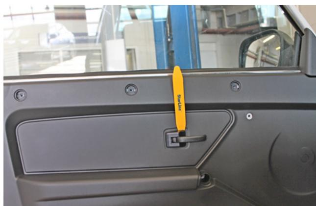
Фото 1.17. Снять декоративную накладку ручки отпирания двери
