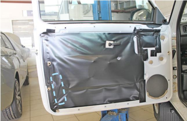
Фото 2.9. Возможное место установки электропривода двери
