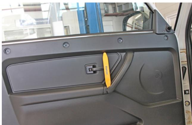
Фото 1.15. Снять пластиковую накладку ручки двери
