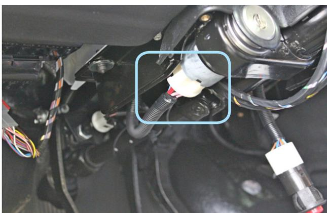
Фото 3.8. Местоположение разъёма замка зажигания
