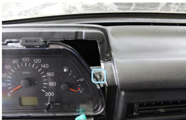
Фото 1.5. Гайка крепления панели приборов справа
