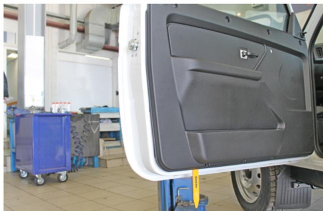
Фото 1.19. Снять пластиковую накладку двери
