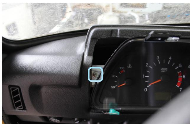
Фото 1.6. Гайка крепления панели приборов слева
