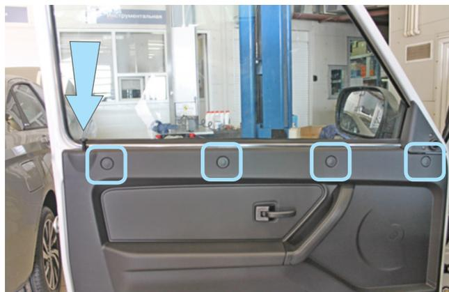
Фото 1.13. Пластиковая кнопка блокировки замка двери и заглушки
