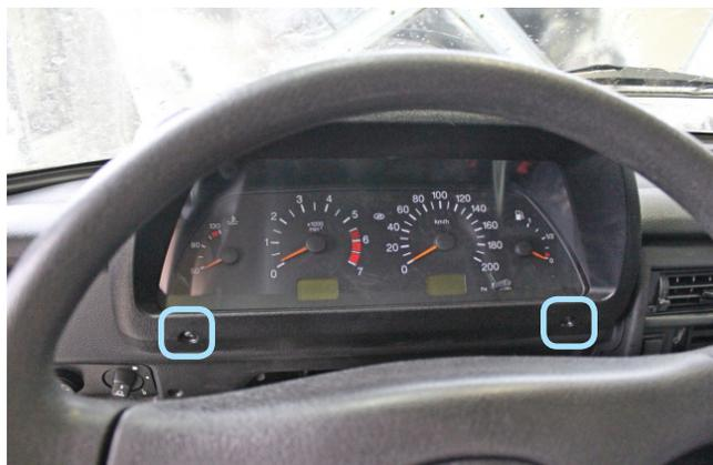
Фото 1.2. Саморезы крепления декоративной накладке панели приборов
