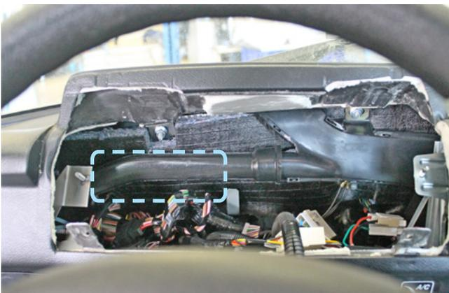
Фото 2.10. Пример расположения центрального блока охранно-телематического комплекса
