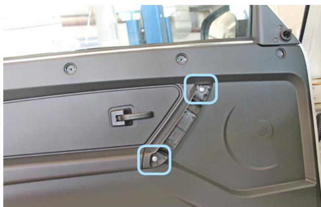
Фото 1.16. Пластиковая накладка ручки двери снята. Винты крепления
