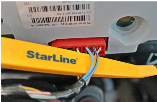
Фото 3.7. Управление световыми сигналами (синий и сине-чёрный)
