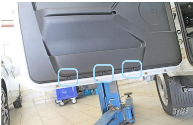
Фото 1.18. Саморезы крепления накладки двери снизу
