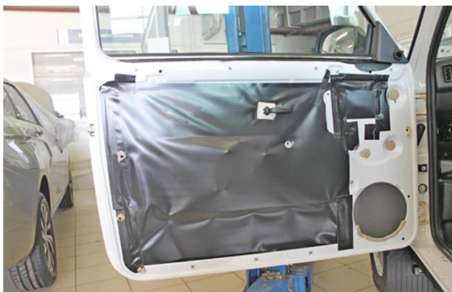
Фото 1.20. Пластиковая накладка двери снята
