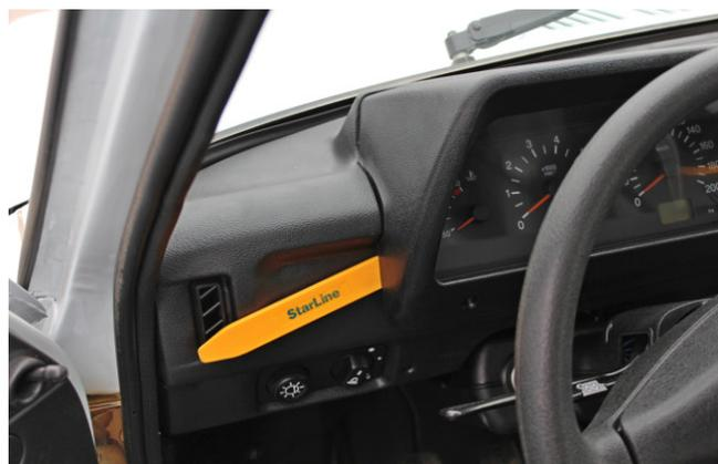
Фото 1.3. Снять декоративную накладку панели приборов
