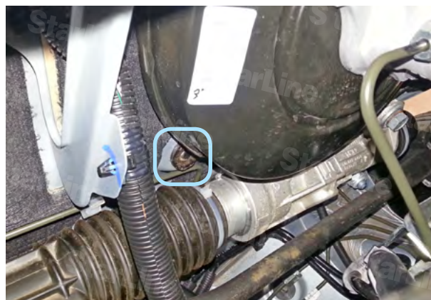
Фото 4.6. Провода в салон проложить через технологическое отверстие. Со стороны моторного щита в пластиковой гофре
