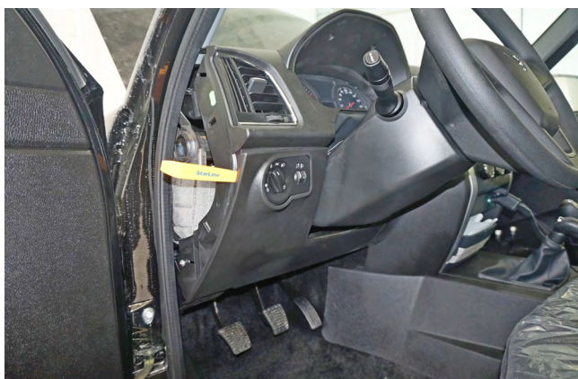
Фото 1.3. Боковая накладка снята. Снять пластиковую накладку под рулевой колонкой
