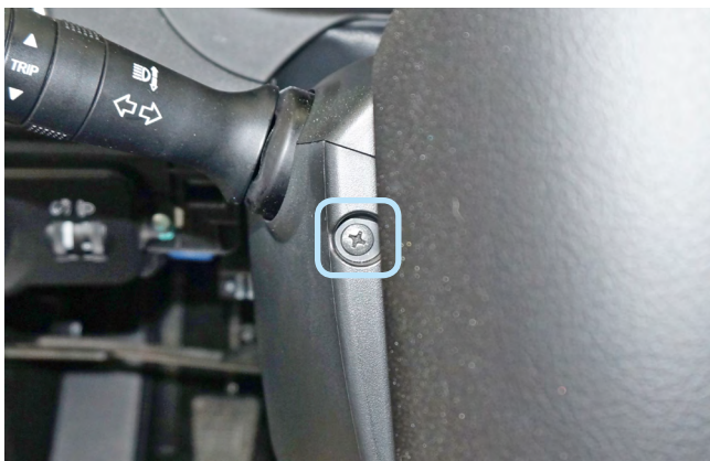
Фото 1.5. Саморез крепления кожуха рулевого вала слева
