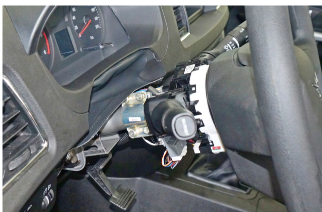
Фото 1.9. Кожух рулевого вала снят
