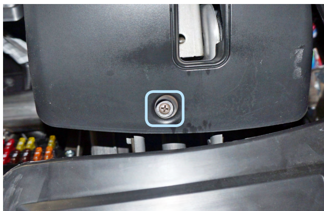
Фото 1.7. Саморез крепления кожуха рулевого вала
