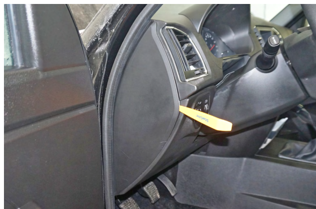
Фото 1.2. Снять боковую накладку передней панели
