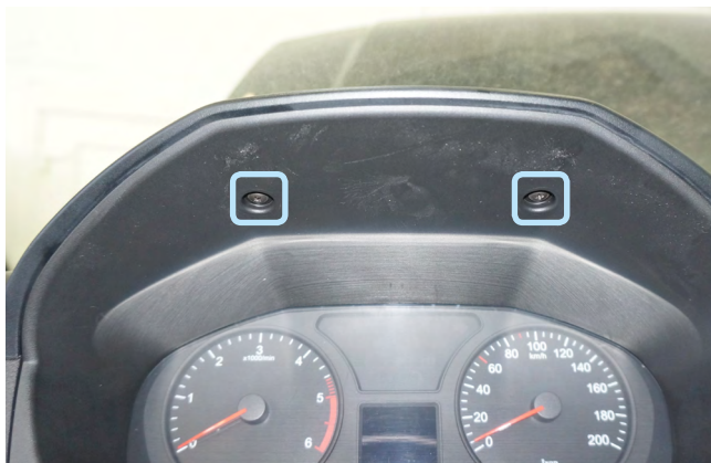
Фото 1.10. Саморезы крепления декоративной накладкой панели приборов
