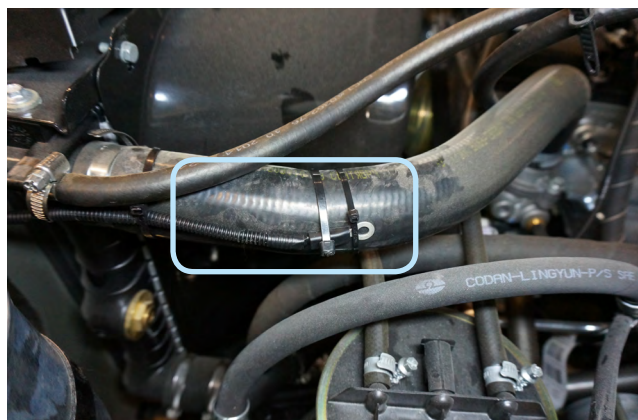
Фото 2.6. Крепление датчика температуры двигателя
