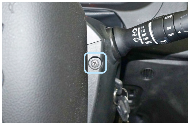
Фото 1.6. Саморез крепления кожуха рулевого вала справа
