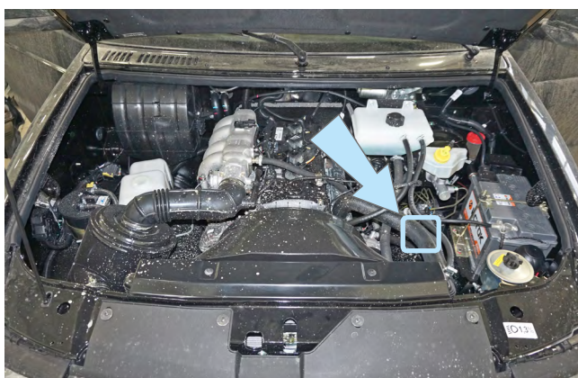
Фото 2.5. Место установки датчика температуры двигателя
