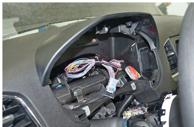
Фото 1.13. Панель приборов снята
