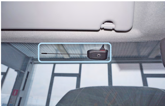
Фото 2.1. Возможное место установки антенного модуля
