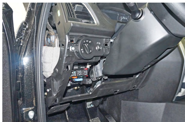
Фото 1.4. Пластиковая накладка под рулевой колонкой снята
