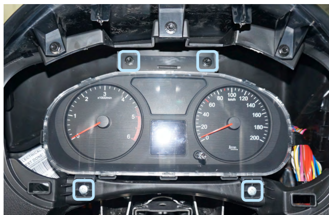
Фото 1.12. Саморезы крепления панели приборов
