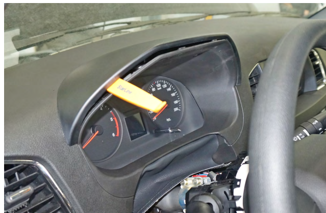
Фото 1.11. Снять декоративную накладку панели приборов
