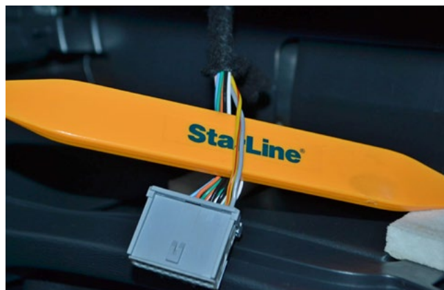
Фото 3.3. Шина CAN-A (жёлто-красный и серый)
