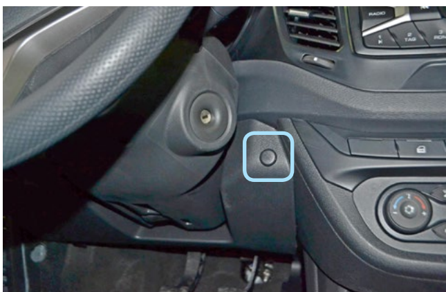
Фото 1.5. Клипса крепления пластиковой накладки под рулевой колонкой
