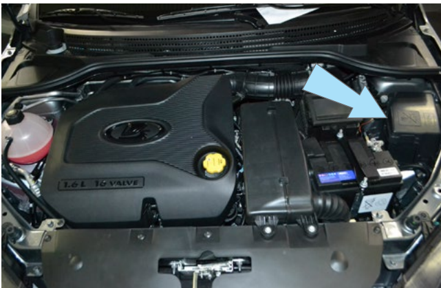
Фото 2.6. Возможное место установки подкапотного блока R6
