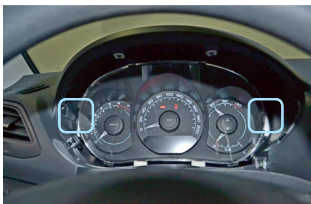
Фото 1.12. Декоративная накладка снята. Саморезы крепления панели приборов
