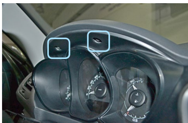
Фото 1.11. Саморезы крепления декоративной накладки панели приборов
