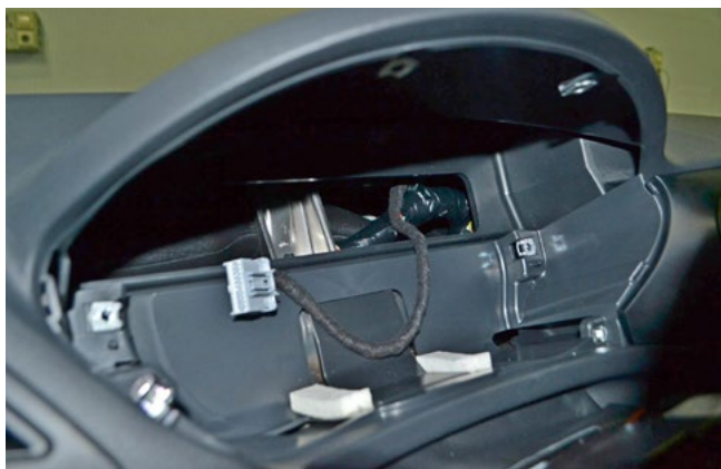
Фото 1.13. Панель приборов снята
