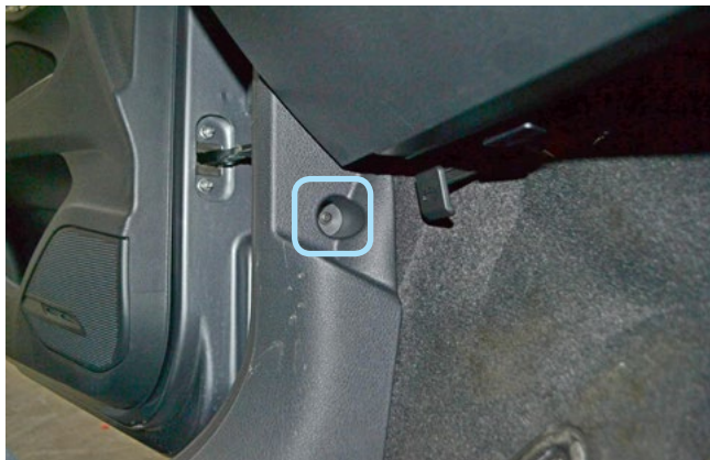
Фото 1.1. Саморез крепления накладки порога двери водителя
