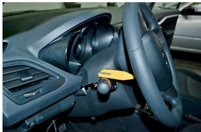
Фото 1.8. Снять верхнюю часть рулевого кожуха
