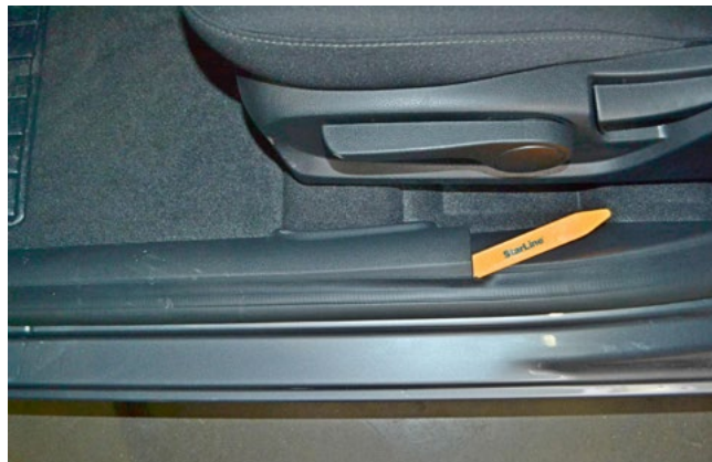
Фото 1.2. Снять пластиковую накладку порога двери водителя
