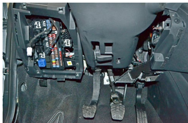
Фото 1.6. Пластиковая накладка под рулевой колонкой снята
