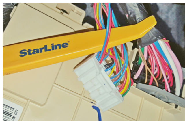
Фото 3.3. Шина CAN-A (красный и синий)
