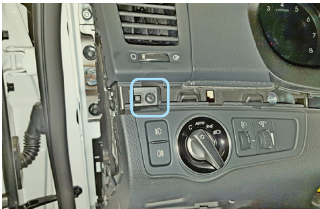
Фото 1.11. Саморез крепления в верхней части пластиковой накладки под рулевой колонкой
