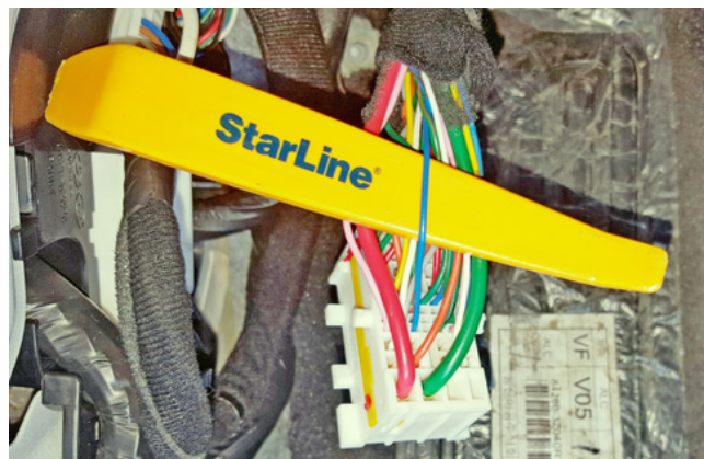
Фото 3.7. Шина данных штатного иммобилайзера (синий)
