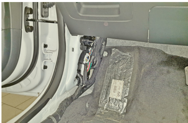
Фото 1.7. Накладка левой кик-панели снята
