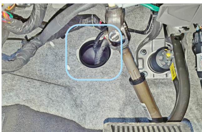
Фото 2.6. Штатный уплотнитель. Вид со стороны салона
