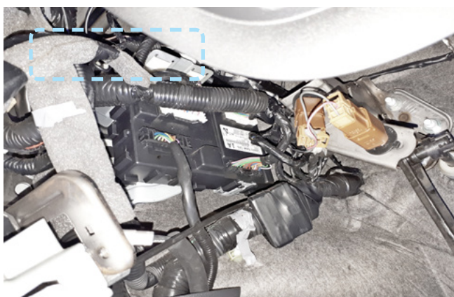
Фото 2.11. Пример расположения центрального блока охранно-телематического комплекса
