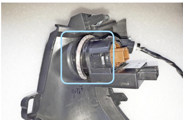
Фото 3.8. Расположение антенны модуля BP-03 на кнопке Старт-Стоп
