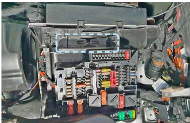
Фото 2.9. Пример расположения центрального блока охранно-телематического комплекса
