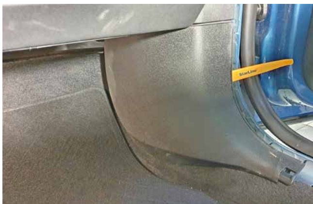
Фото 1.3. Снять накладку правой кик-панели
