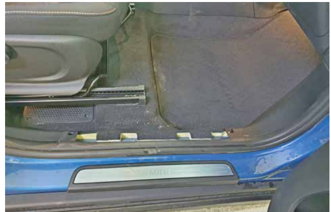
Фото 1.2. Накладка порога передней правой двери снята
