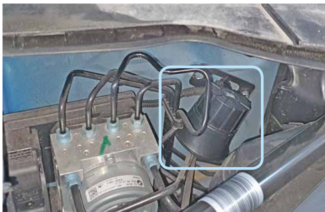
Фото 2.2. Возможное место установки сирены
