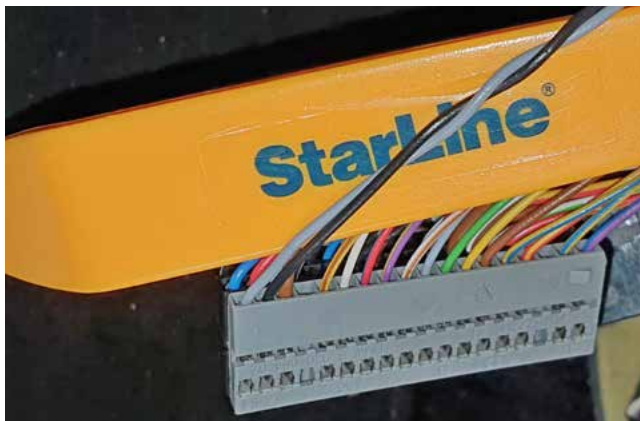
Фото 3.13. Провод штатной антенны иммобилайзера (серый и чёрный)
