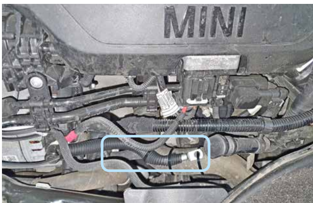
Фото 2.4. Место установки датчика температуры двигателя
