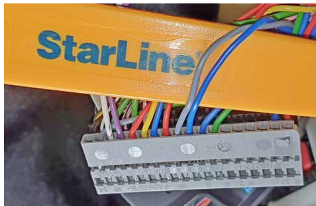
Фото 3.5. Шина CAN-B (серый и синий)
