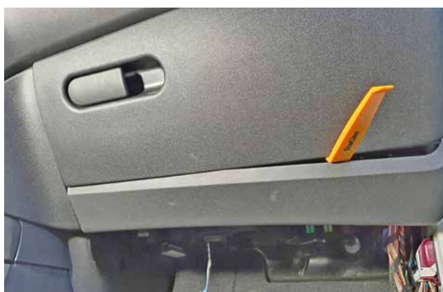
Фото 1.10. Снять накладку под перчаточным ящиком
