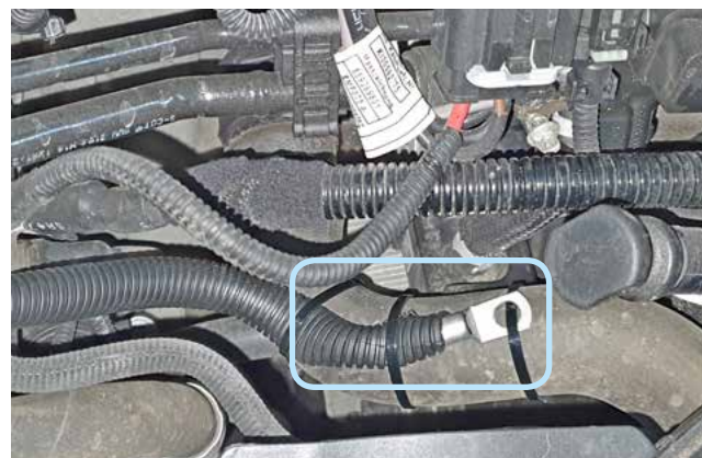
Фото 2.5. Крепление датчика температуры двигателя
