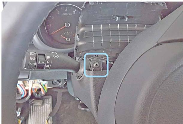
Фото 2.3. Саморез крепления нижней части кожуха рулевого вала слева
