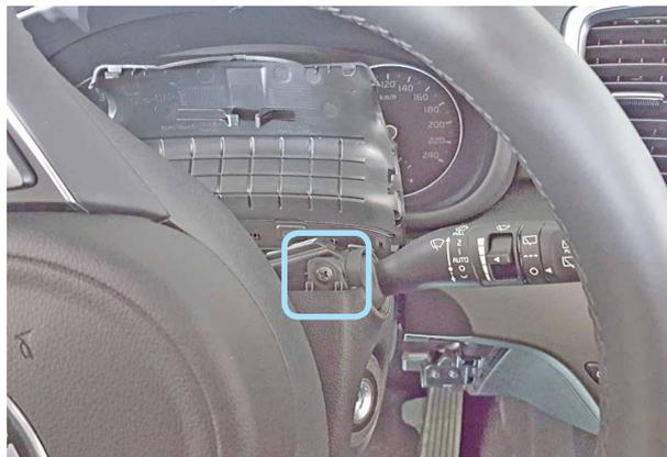
Фото 2.4. Саморез крепления нижней части кожуха рулевого вала справа
