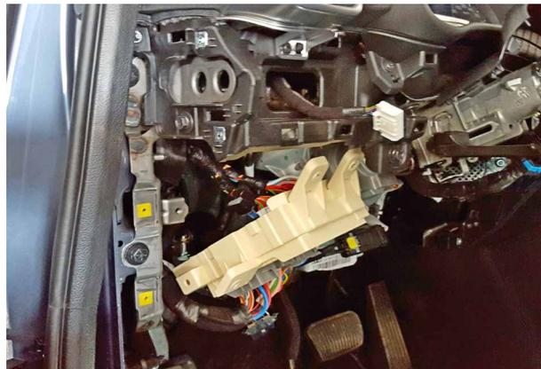
Фото 3.4. Монтажный блок предохранителей снят
