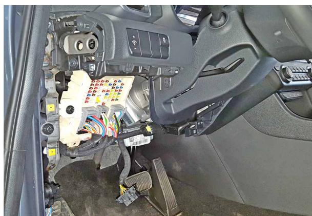
Фото 1.10. Пластиковая накладка под рулевой колонкой снята
