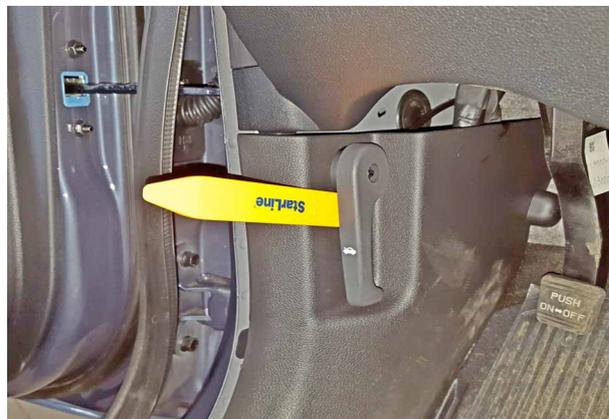
Фото 1.2. Снять ручку отпирания капота
