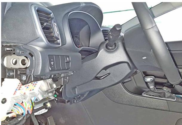
Фото 2.1. Кожух рулевого вала. Общий вид
