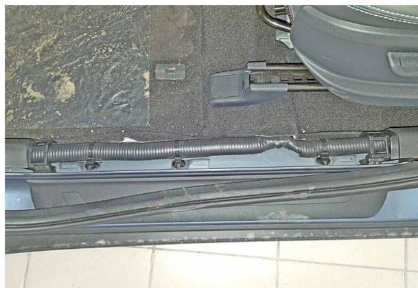
Фото 1.4. Накладка порога двери водителя снята
