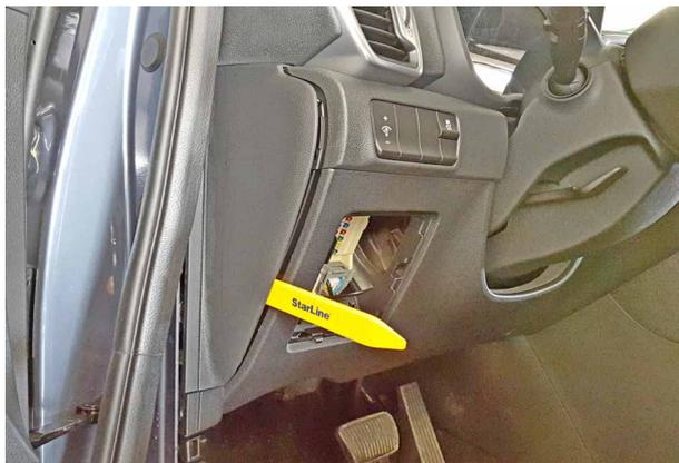
Фото 1.7. Снять боковую накладку передней панели
