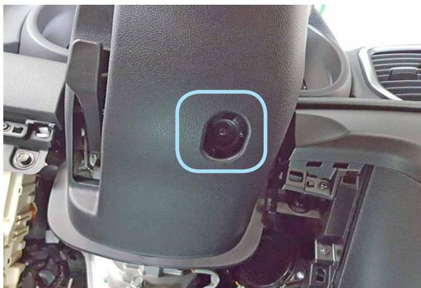
Фото 2.5. Саморез крепления нижней части кожуха рулевого вала снизу
