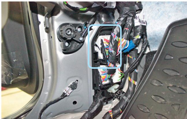
Фото 3.6. Местоположение разъёма
