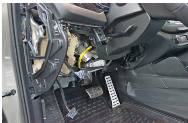
Фото 1.4. Пластиковая накладка под рулевой колонкой снята
