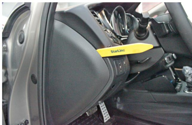
Фото 1.2. Снять левую накладку передней панели
