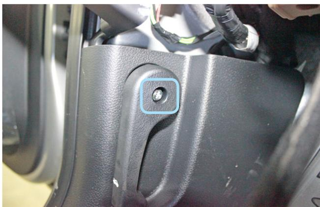
Фото 1.7. Винт крепления ручки отпирания капота
