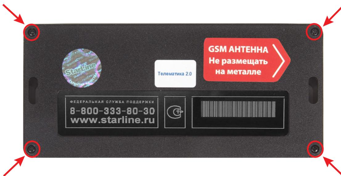
1.2. Извлечь плату центрального блока. Установить SIM-карту в GSM-модуль до упора в направлении, указанном стрелками на рисунке.
