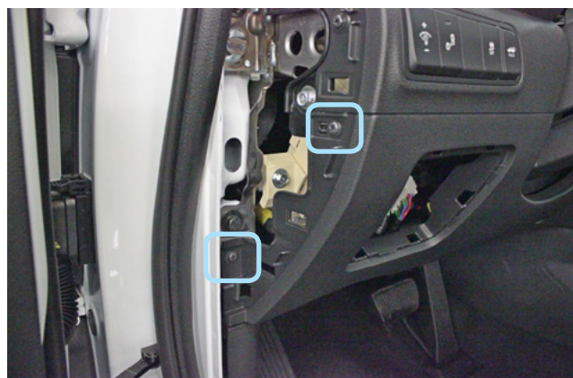
Фото 1.6. Накладка снята. Саморезы
