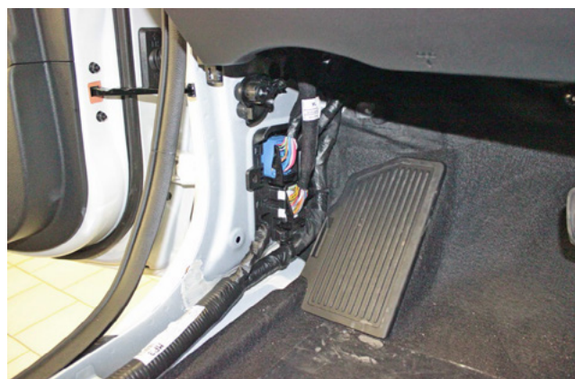
Фото 1.4. Накладка левой кик-панели снята
