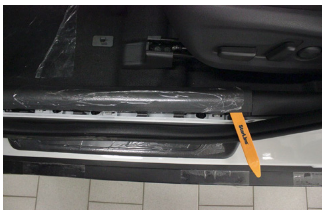
Фото 1.3. Снять накладку порога двери водителя
