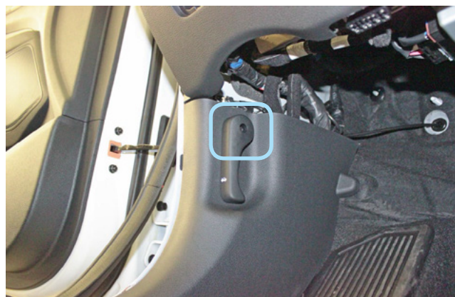
Фото 1.2. Винт крепления ручки отпирания капота
