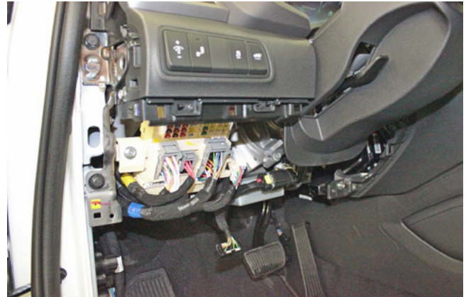
Фото 1.8. Пластиковая накладка под рулевой колонкой снята
