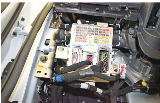
Фото 2.8. Пример расположения центрального блока охранно-телематического комплекса
