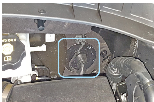
Фото 2.6. Штатный уплотнитель. Вид со стороны капота
