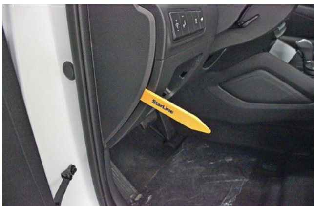
Фото 1.5. Снять боковую накладку передней панели
