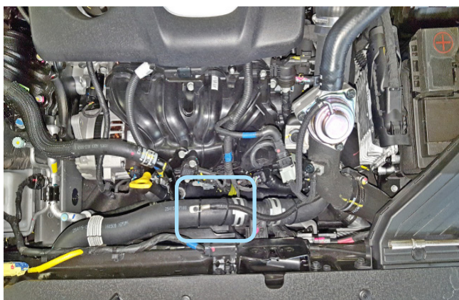
Фото 2.3. Место установки датчика температуры двигателя
