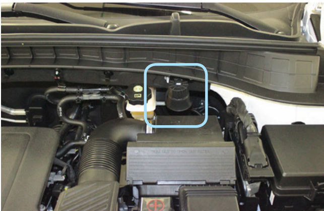
Фото 2.1. Возможное место установки сирены
