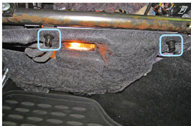
Фото 1.6. Клипсы крепления декоративной накладки под блоком ВСМ
