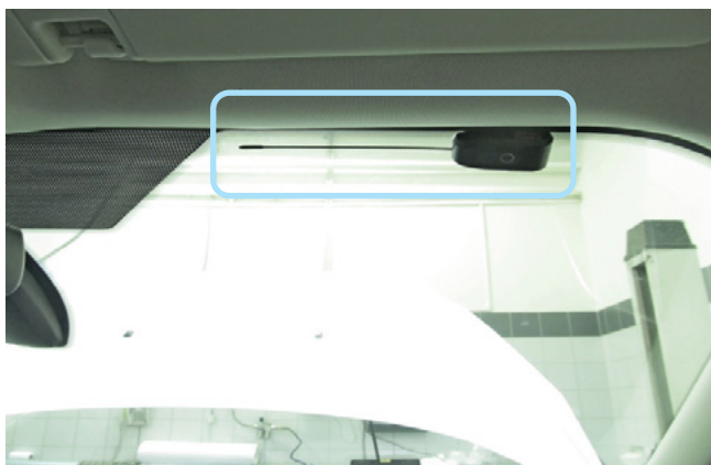
Фото 2.1. Возможное место установки антенного модуля
