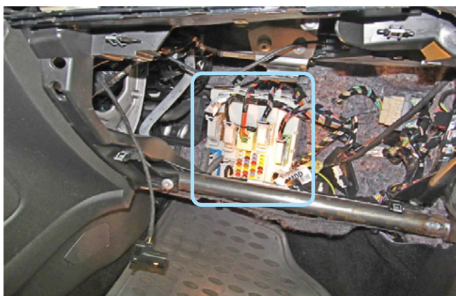
Фото 1.5. Перчаточный ящик снят. Блок ВСМ
