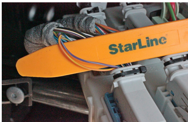
Фото 3.12. Шина данных штатного иммобилайзера (фиолетово-серый и жёлто-оранжевый)
