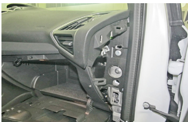
Фото 1.3. Боковая накладка передней панели снята
