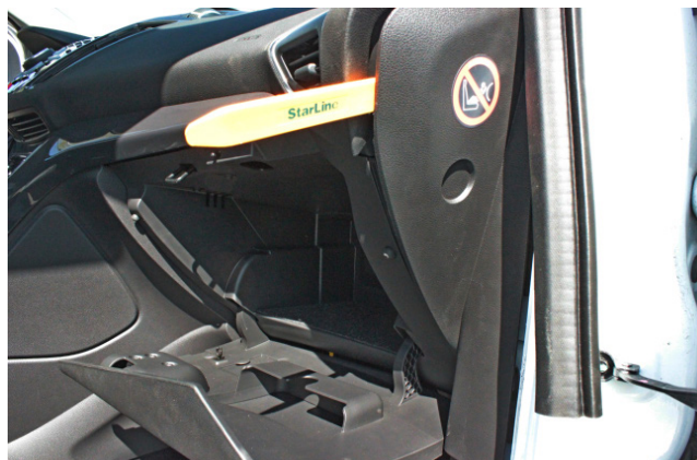
Фото 1.2. Снять боковую накладку передней панели
