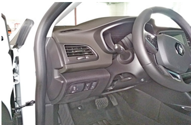
Фото 1.1. Пластиковая накладка под рулевой колонкой. Общий вид
