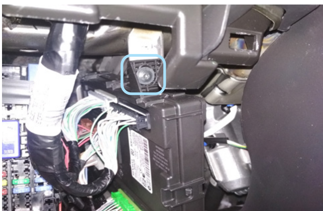
Фото 1.5. Саморез крепления блока BSI
