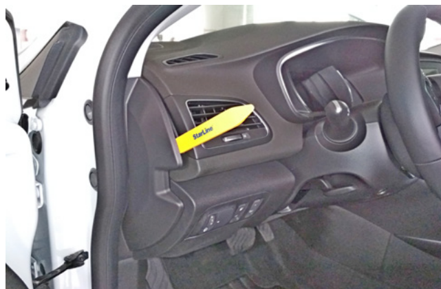
Фото 1.2. Снять боковую накладку передней панели
