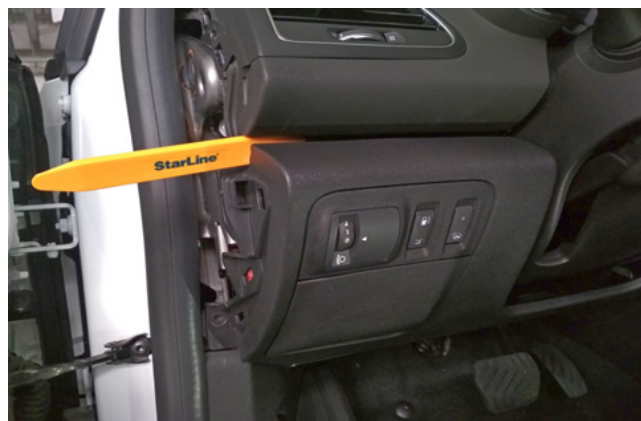
Фото 1.4. Снять пластиковую накладку под рулевой колонкой
